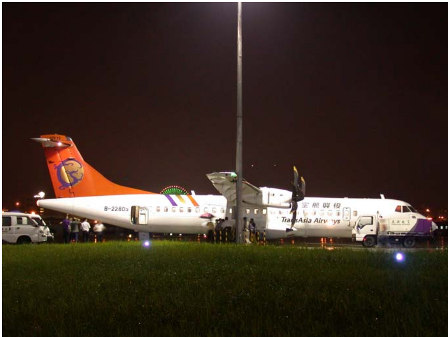
圖 3-3 翼尖撞擊燈桿受損情形
