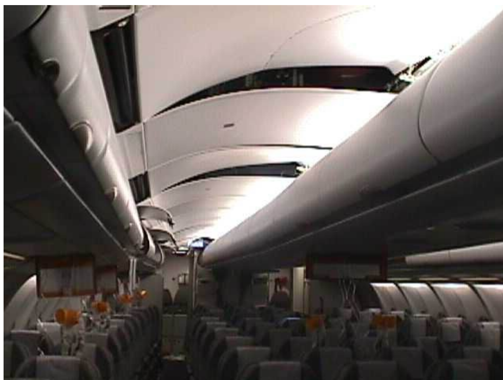
圖 3-2 客艙內部受損情形
