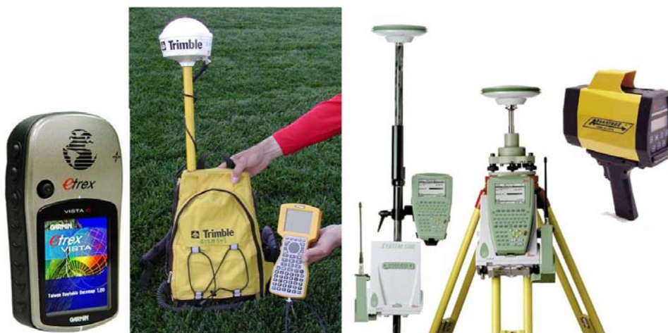
圖 6-10 由左至右依序為手持式（左）、測量型（中）、精密測量型衛星定位系統（右），以及雷射測距儀。
