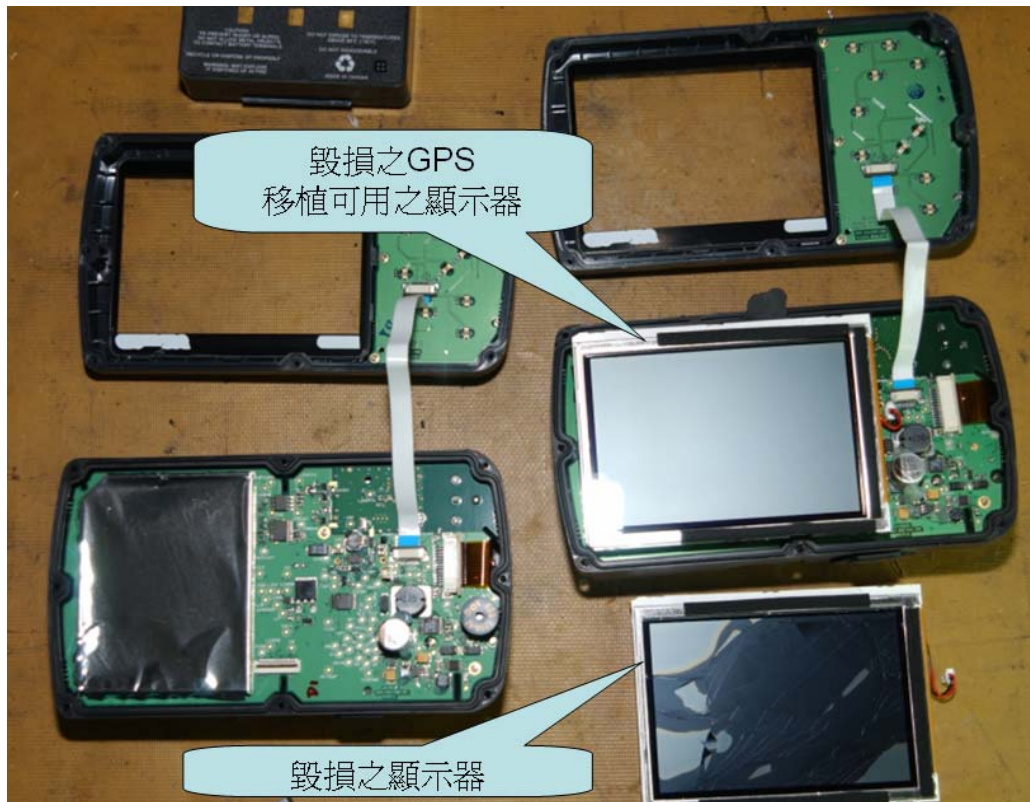
圖 6-2 GPS 接收器之顯示器毀損，經過移植顯示器順利解讀該記錄資料
