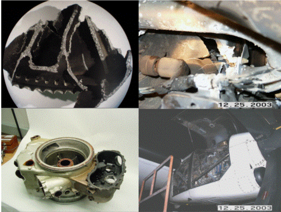
圖 3-14 事故航空器發動機拆解檢視情形，其中左上圖顯示葉輪內之逸氣通道呈黑色；右上圖為發動機附件齒輪箱龜裂失火情形；左下圖為發動機附件齒輪箱匣損壞情形；右下圖為發動機艙於火警後損壞情形。
