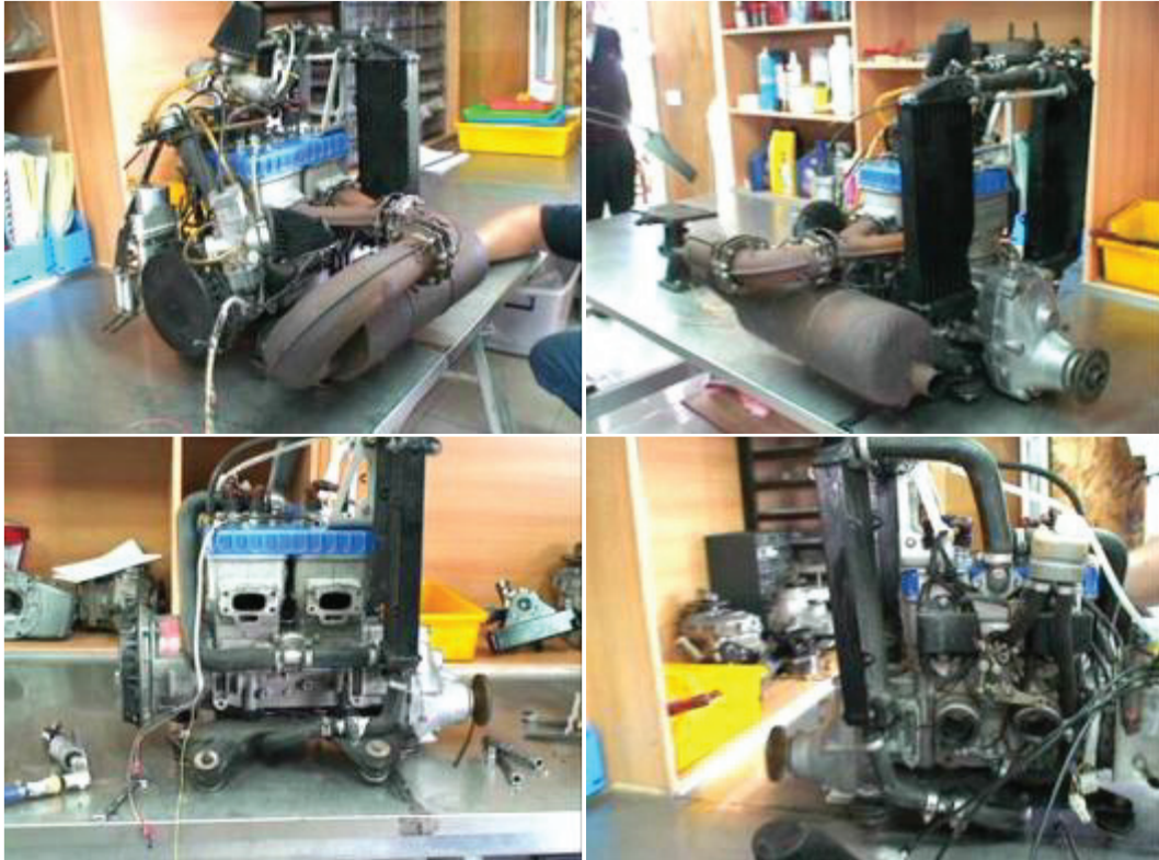
圖 6-18 某超輕型載具之發動機排氣管及磁電機檢測
