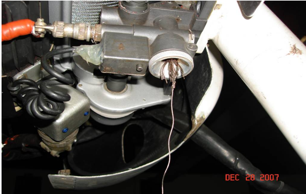
圖 3-16 吊掛鋼索斷裂處
