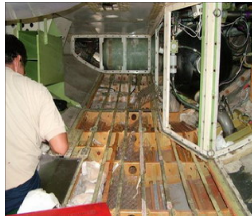
圖 3-3 後貨艙底損壞蒙皮
