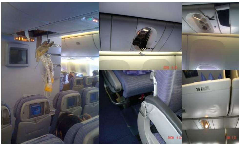
圖 3-10 航機遭嚴重亂流客艙組件毀損狀況
