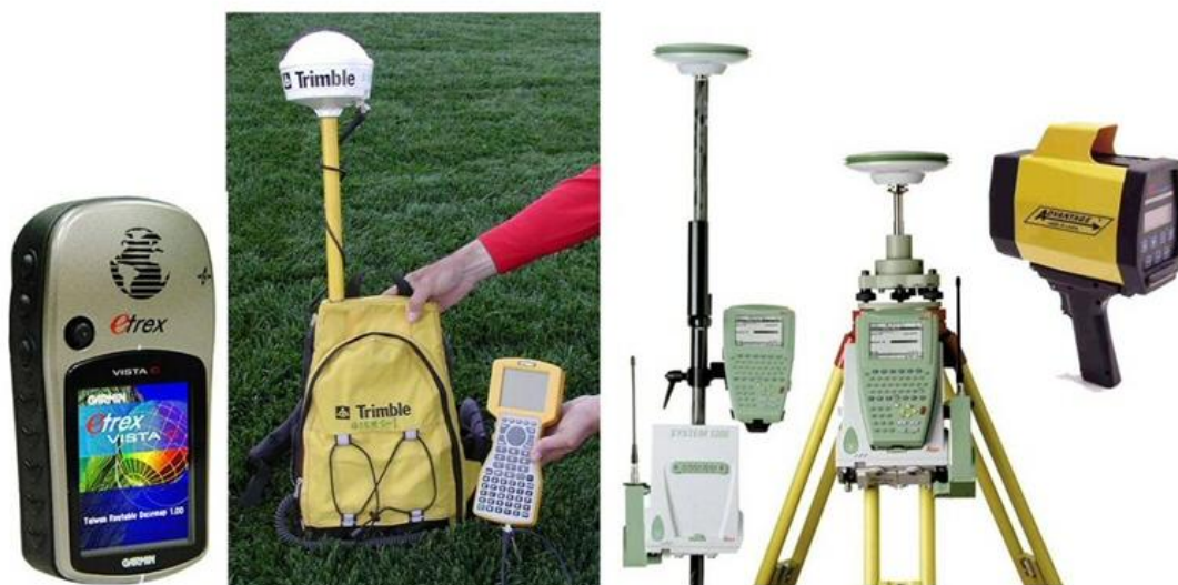
圖 6-8 由左至右為手持式、測量型、精密測量型衛星定位儀以及雷射測距儀
