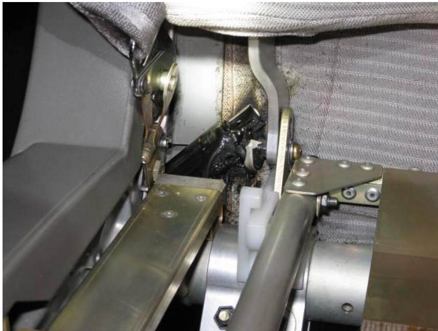
圖 3-9 冒煙並引發火警之乘客座椅與打火機殘骸
