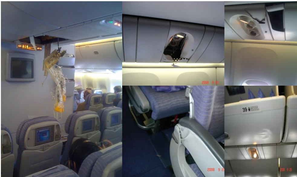
圖 3-5 客艙損害情形
