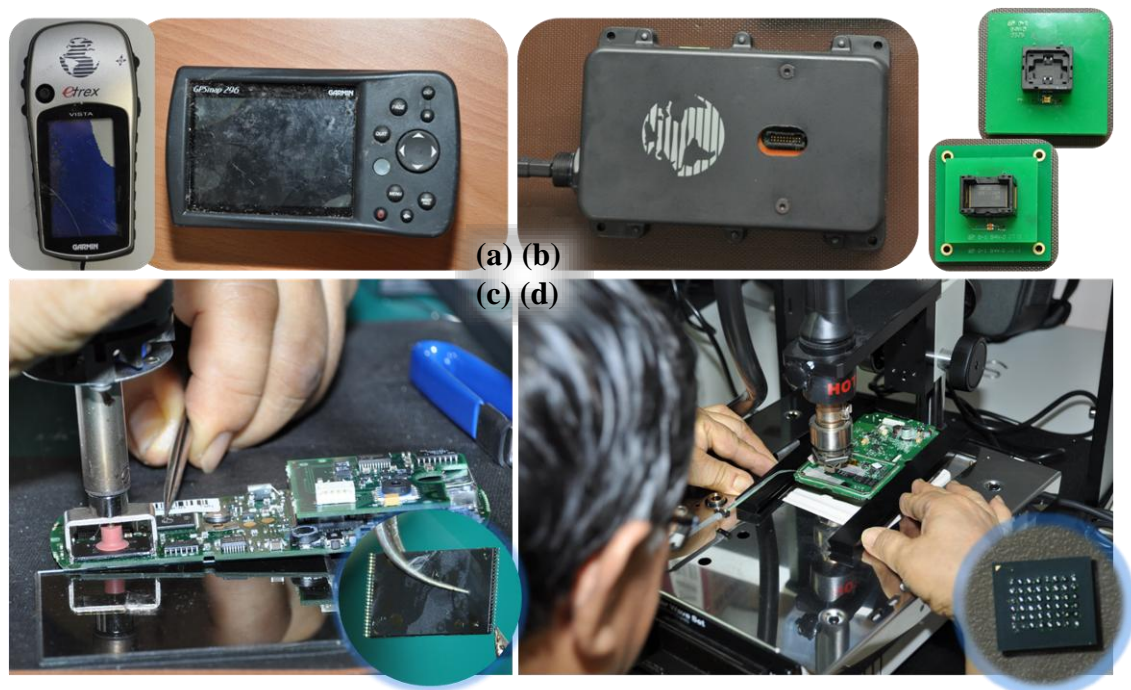
圖 6-1 (a)為損壞式 GPS；(b)為治具及編程器；(c) TSOP 式晶片解焊設備；(d) BGA 式晶片解焊設備
