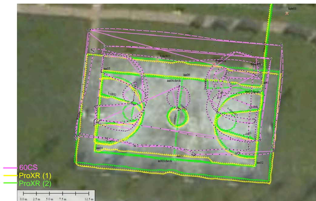
圖 4-6：測試場地 GPS 量測軌跡套疊圖
