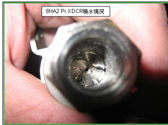
圖 2-11：壓力感測器內部積水現象圖
