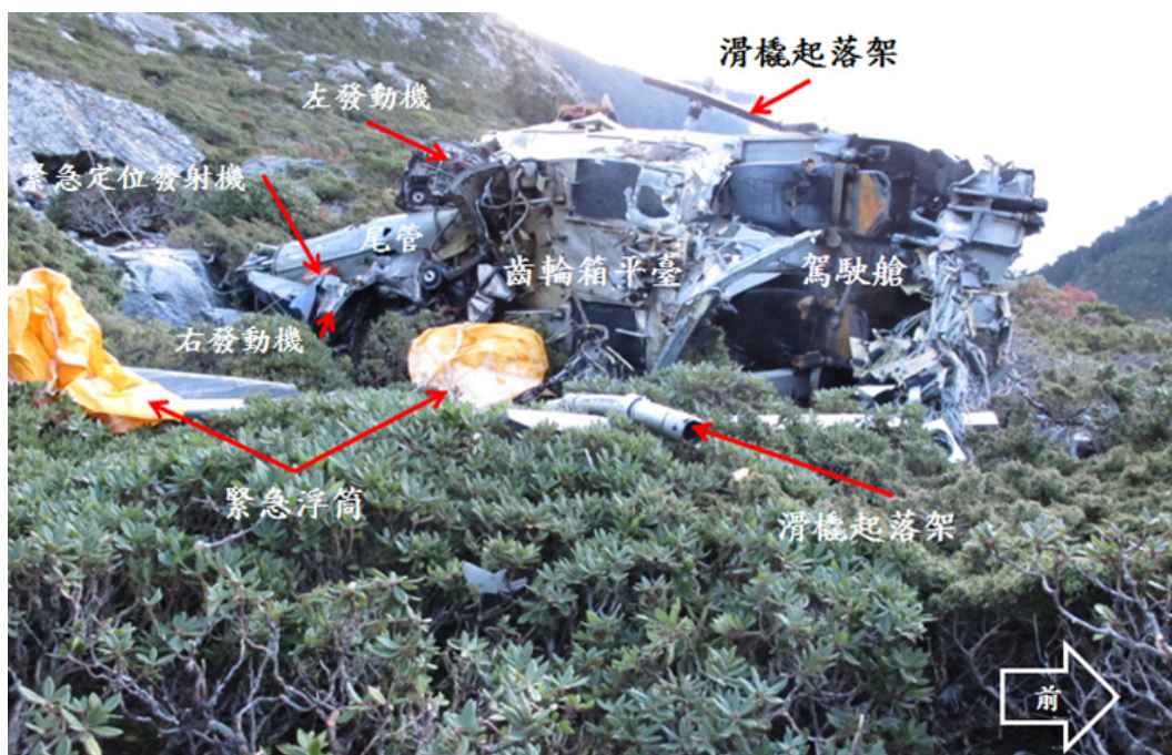
圖 2-12：主殘骸損毀狀況
