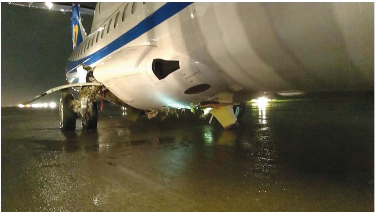
圖 2-8 航機機腹受損照片
