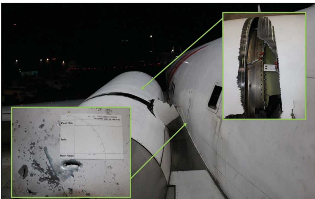
圖 2-5 發動機外罩及機身損壞狀況
