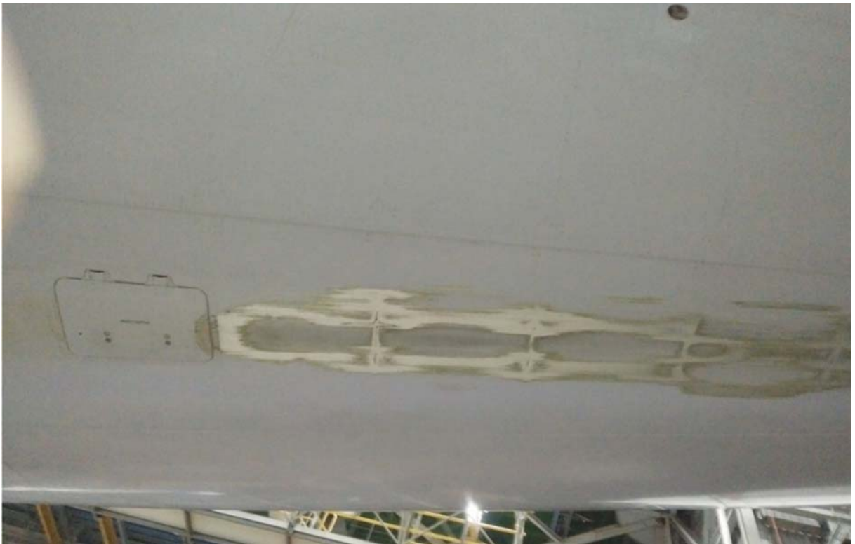
圖 2-14 事故航空器機腹蒙皮受損情形
