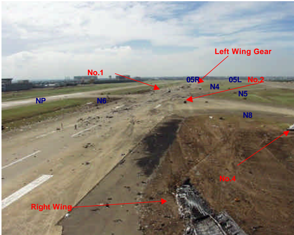
圖 1.12-4 與滾行方向相反之殘骸分布圖
