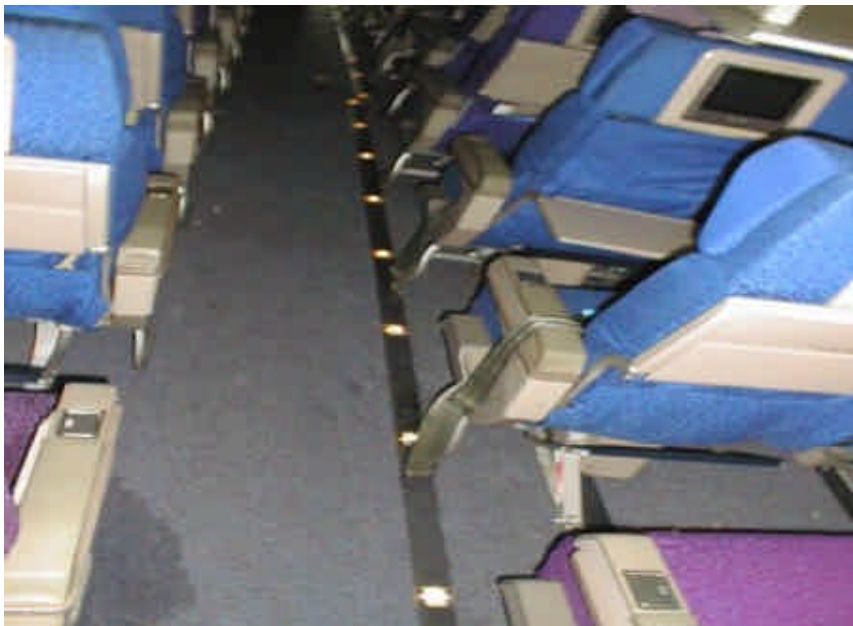
圖 1.16-3 緊急照明燈光測試結果
