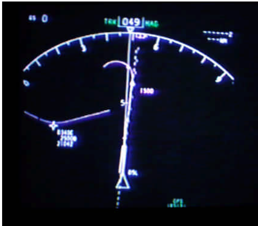
圖 1.18-4 飛行計劃為 05 左跑道而 ND 上顯示飛機對正 05 右跑道
