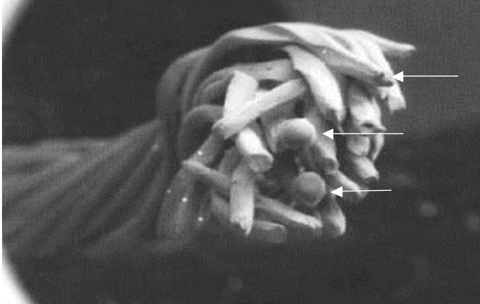
圖 1.16-4 RE240-1 電線末端之三處熔珠
