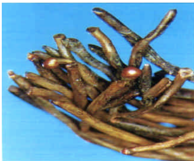
圖 1.16-6 RE240-1 電線末端熔珠
