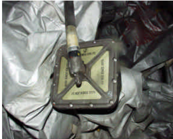
圖 1.12-10 左側 2 號門疏散滑梯充氣機
