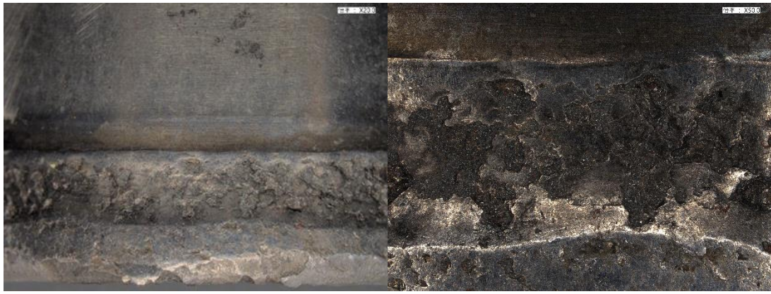
圖 4.4.5-1 軸承內環破壞區域之顯微照片（20 倍及 50 倍）
