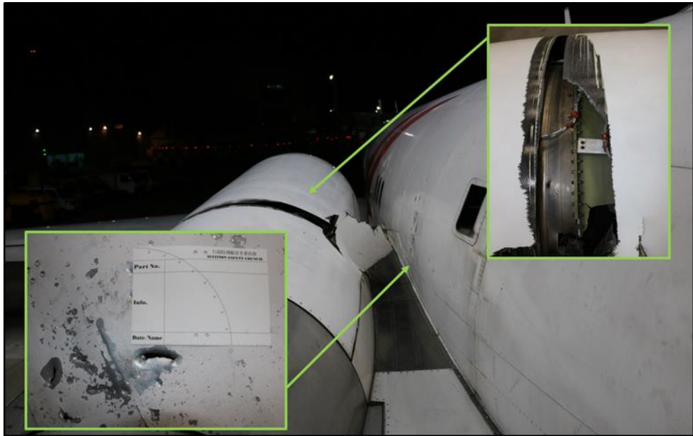
圖 2.X 發動機外罩及機身損壞狀況
