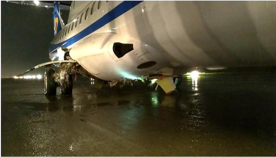
圖 2.XX 航機機腹受損照片
