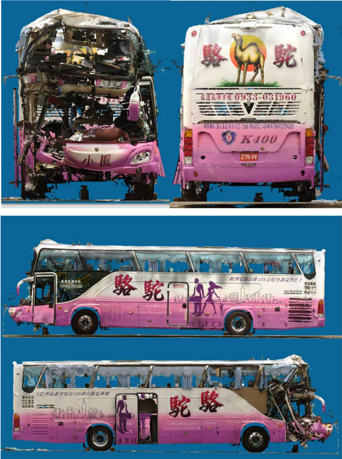
圖 1.13-2 事故車輛高精度 LiDAR 掃描成果圖
