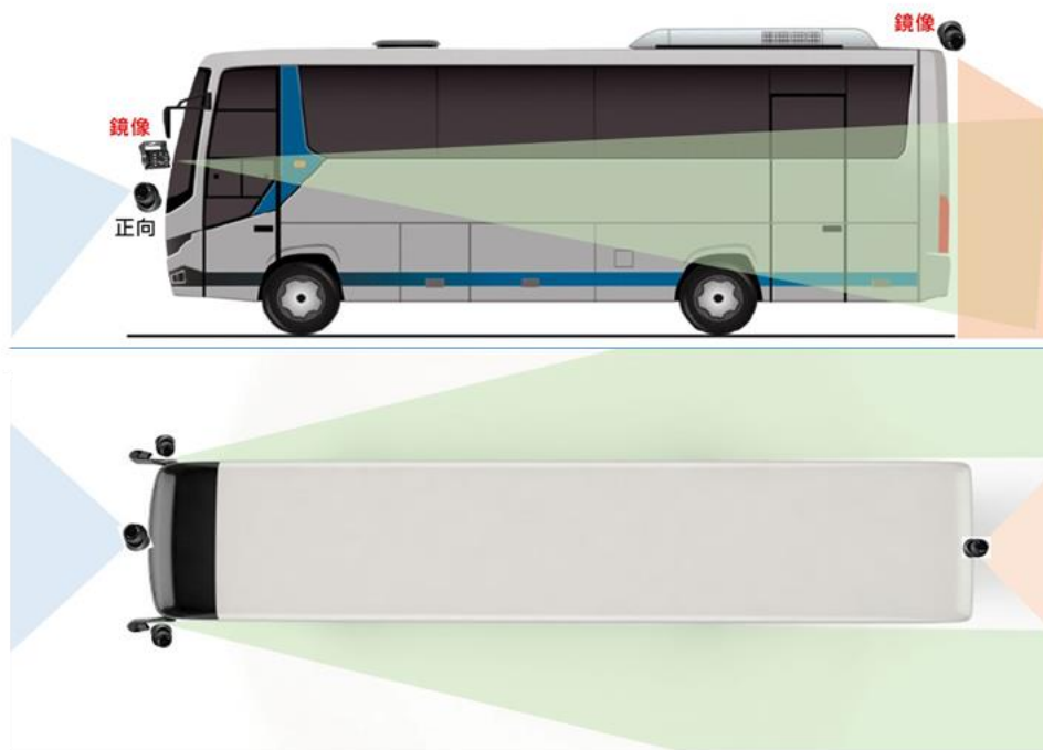
圖 1.9-1 行車視野輔助系統鏡頭錄影區示意圖
