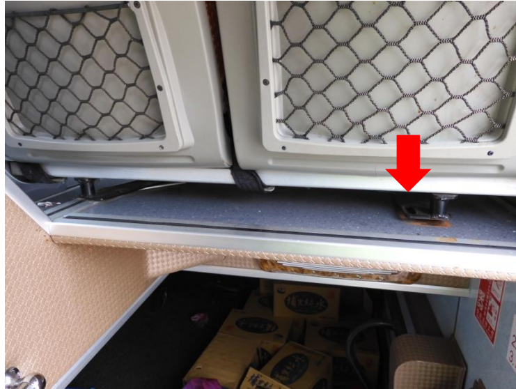
圖 1.12-2 事故車輛 6 排 4 號座椅螺絲鬆脫情形
