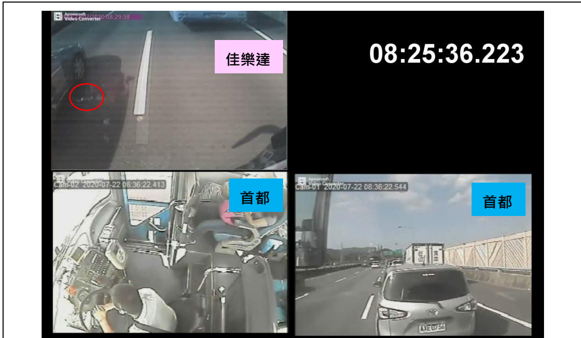
0825:36.223 時，自事故車輛前擋玻璃反射影像可觀察到駕駛員突然向左操作，之後車輛駕駛座有長方形亮光物體飛出(1)
