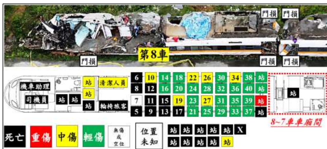
圖 2.6-2 第 8 車與 7-8 車間之車體損壞與傷亡對照圖
