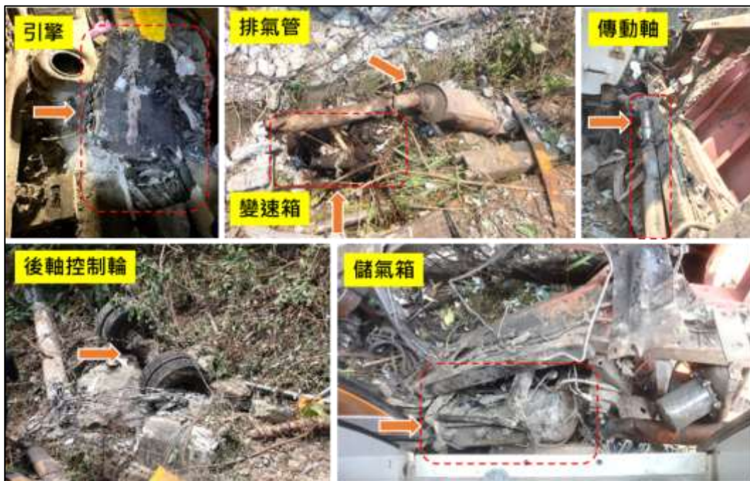
圖 1.3-14 大貨車零組件受損情形
