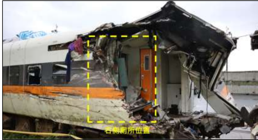
圖 1.13-17 第 7 車女廁受損情形
