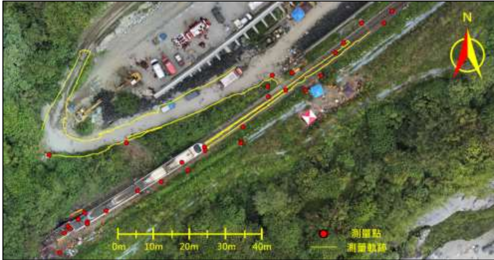
圖 1.11-1 空拍影像及衛星測量套疊
