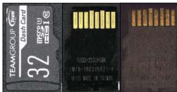
圖 1.10-20 電子顯微鏡檢視行車影像紀錄器記憶卡
