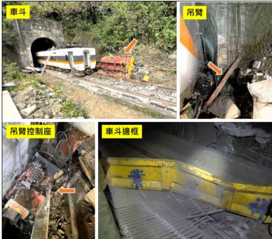
圖 1.3-13 大貨車車身受損情形
