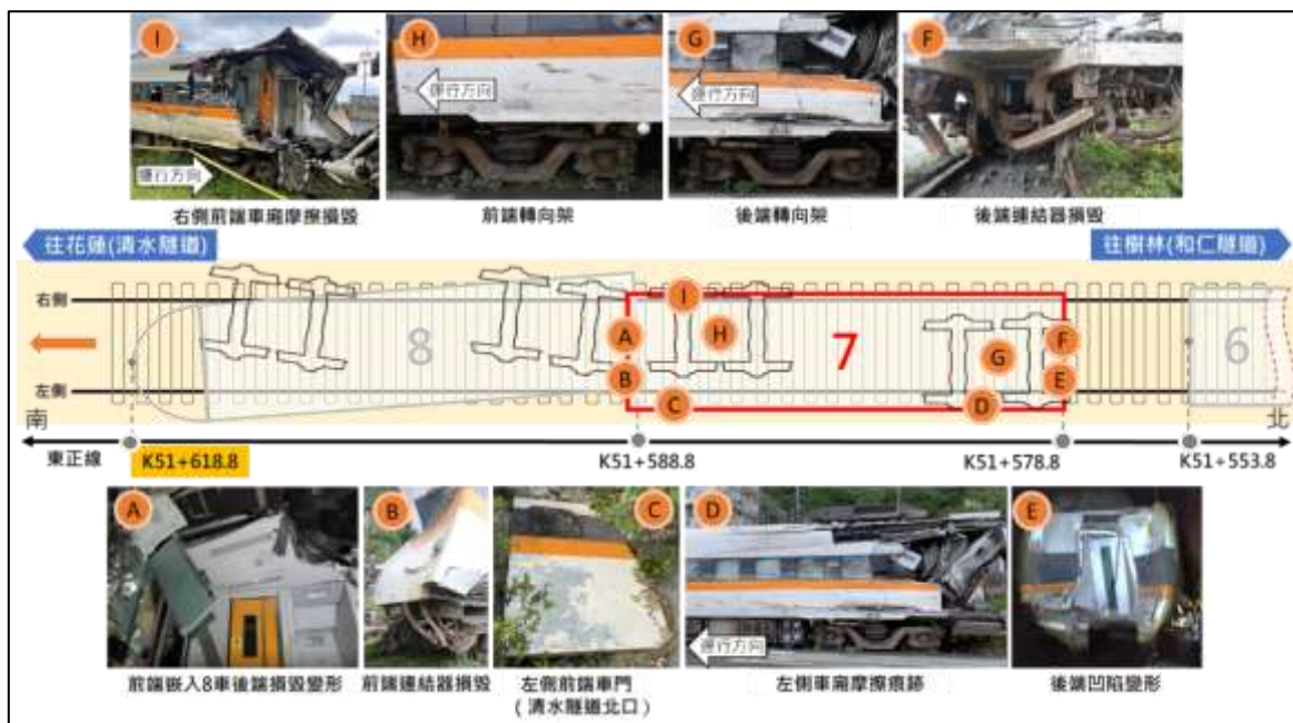
圖 1.3-2 第 7 車損害情形
