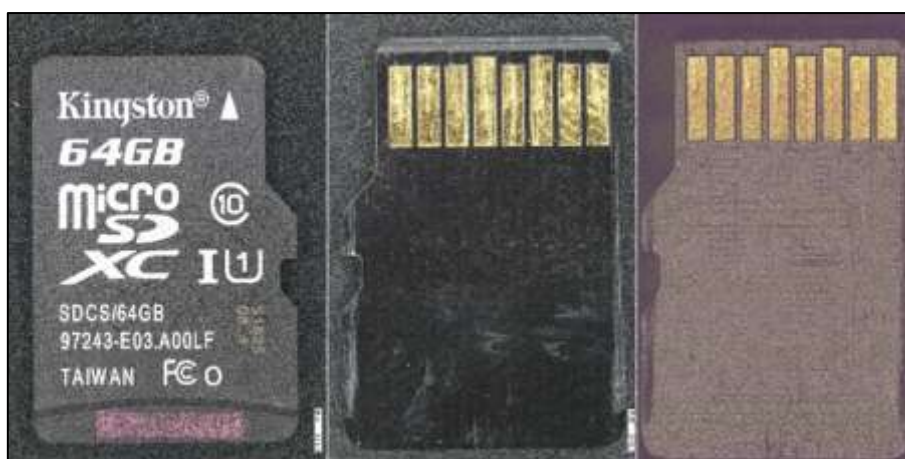
圖 1.10-17 電子顯微鏡檢視行車視野輔助系統之記憶卡
