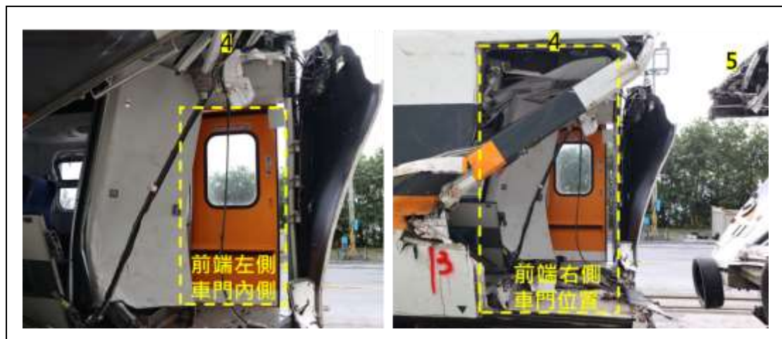
圖 1.13-2 第 4 車前端左、右側車門及玄關通道
