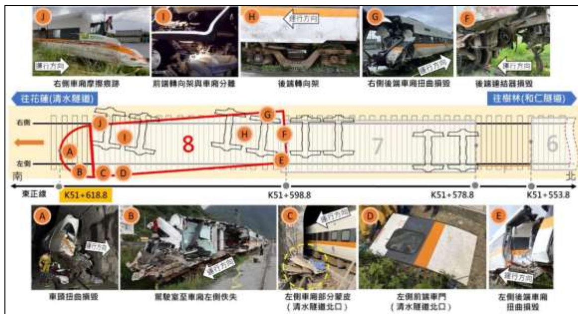
圖 1.3-1 第 8 車損害情形
