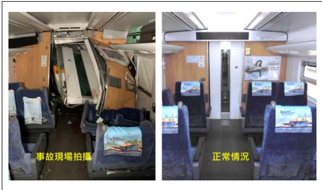
圖 1.13-3 第 4 車前端受損情形
