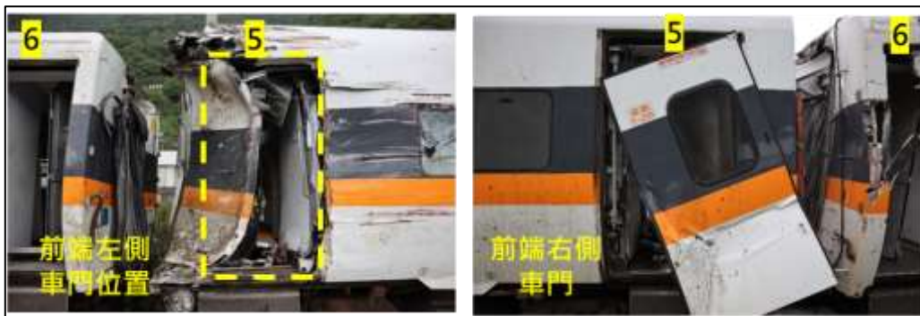
圖 1.13-6 第 5 車前端左、右側車門及玄關通道
