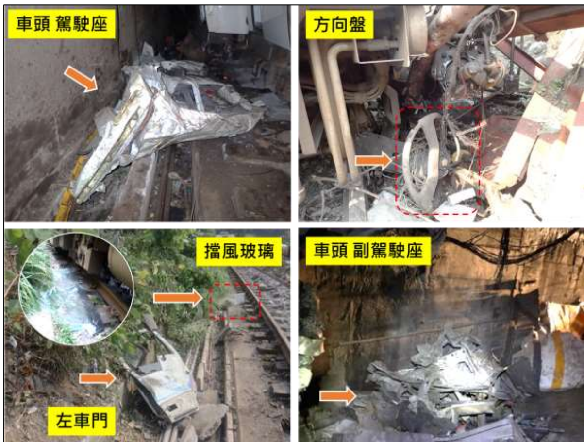
圖 1.3-12 大貨車車頭受損情形
