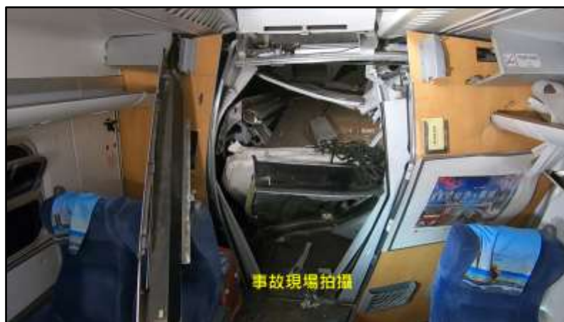
圖 1.13-8 第 5 車後端受損情形
