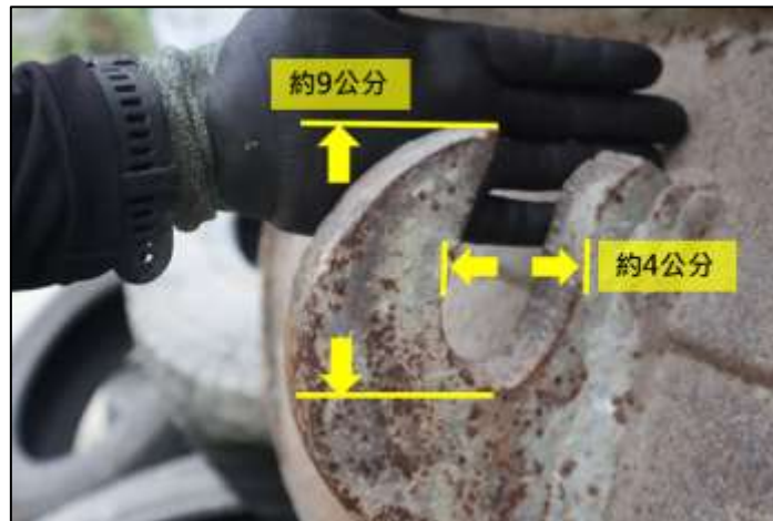
圖 1.8-4 挖斗裝置上之掛勾外觀照片
