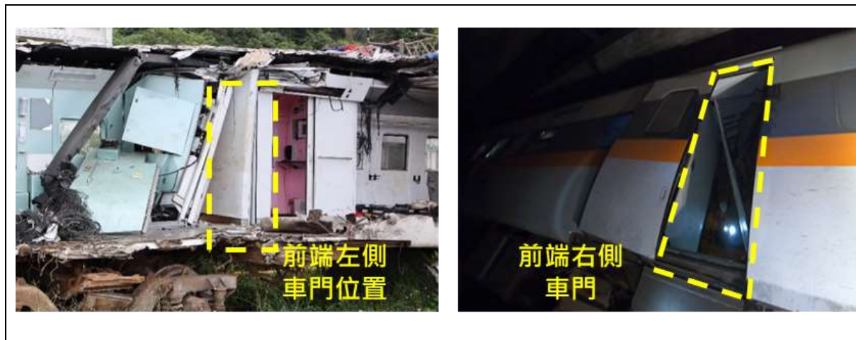
圖 1.13-23 第 8 車前端左、右側車門及玄關通道
