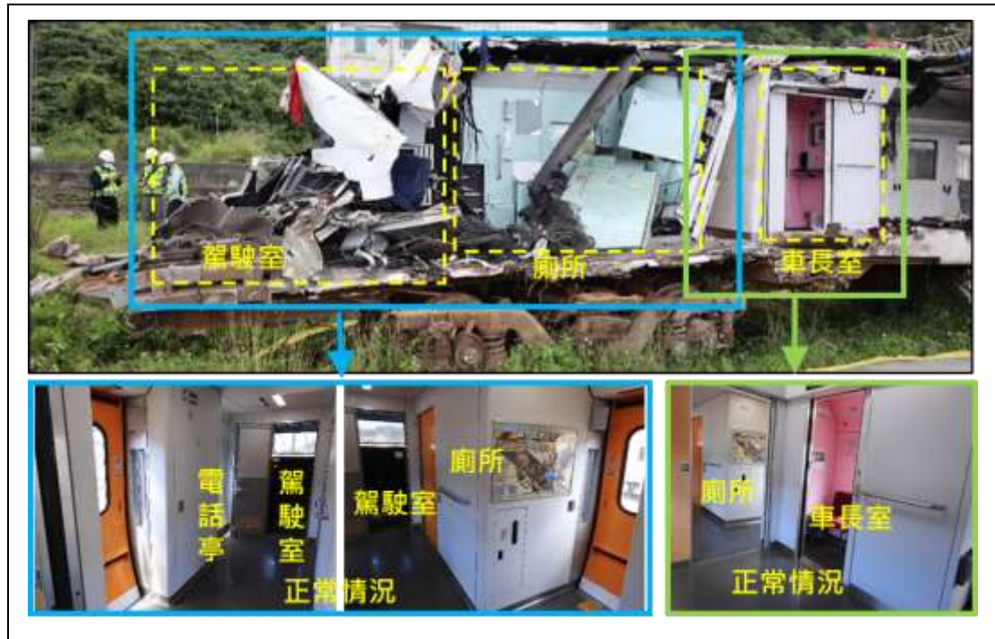
圖 1.13-22 第 8 車前段受損情形
