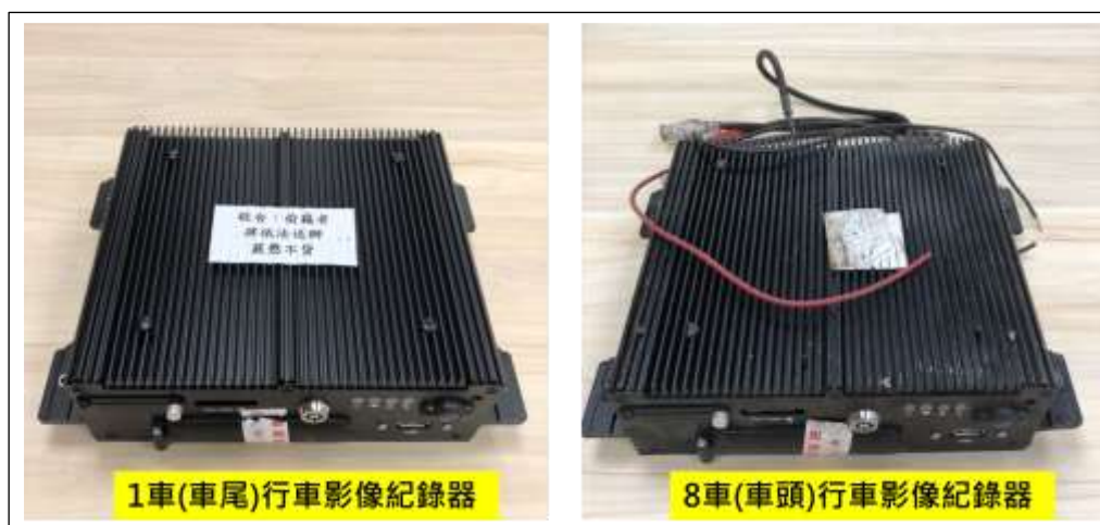
圖 1.10-12 事故列車行車影像紀錄器
