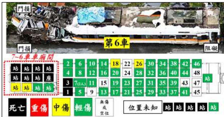
圖 2.6-3 第 6 車與 6-7 車間之車體損壞與傷亡對照圖
