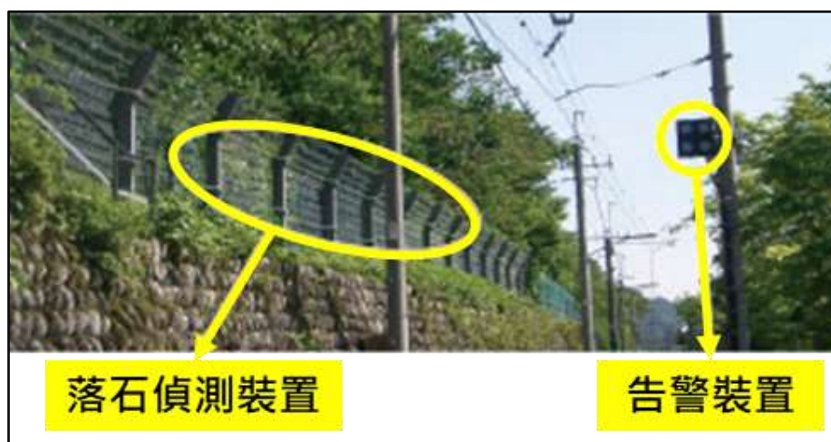
圖 1.7-10 東武鐵道落石偵測告警裝置 15
