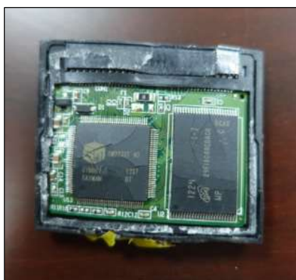
圖 1.10-6 開啟記憶卡外蓋後之內部照片
