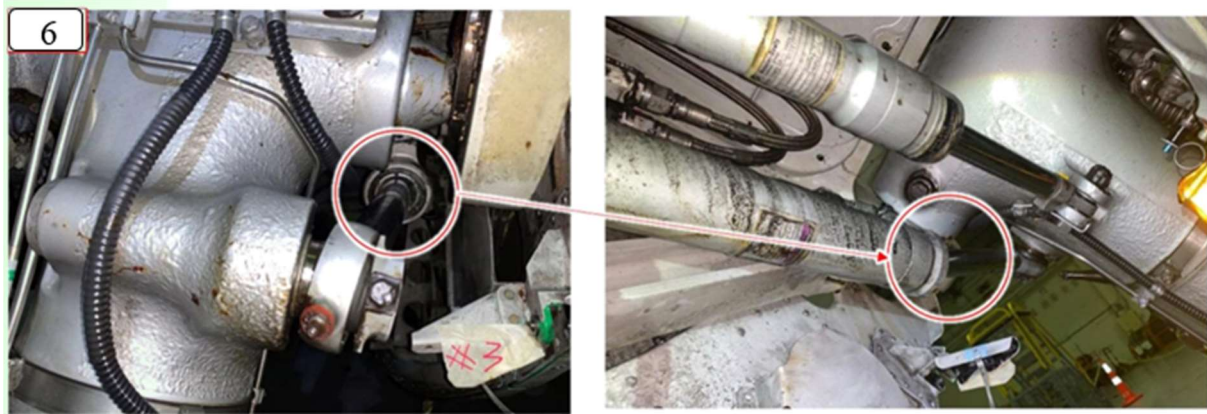
圖 1.12-4 右起落架受損照片
