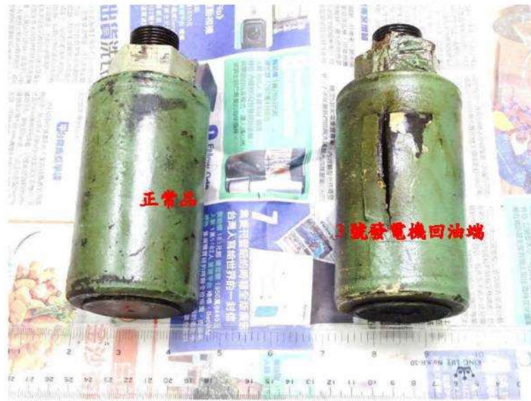
照片三：3號發電機回油端與正常品整體外貌
