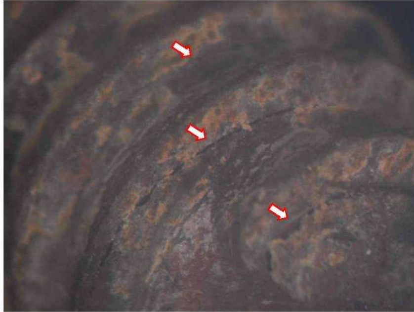
圖 3 斷件 S1 顯示螺紋表面有廣泛周向裂隙（箭頭所指處）。
