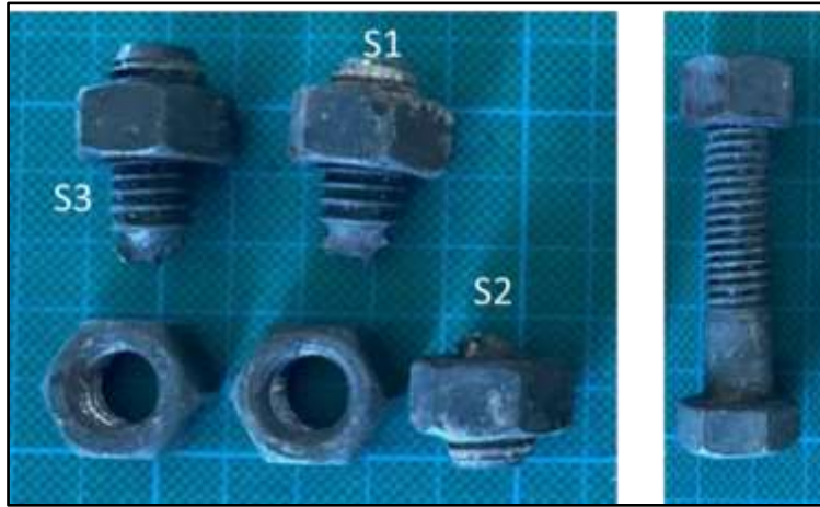
圖 14 斷裂螺栓與正常螺栓比較圖
