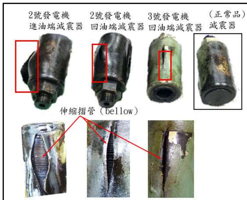
圖 13 受損減震器與正常減震器比較圖
