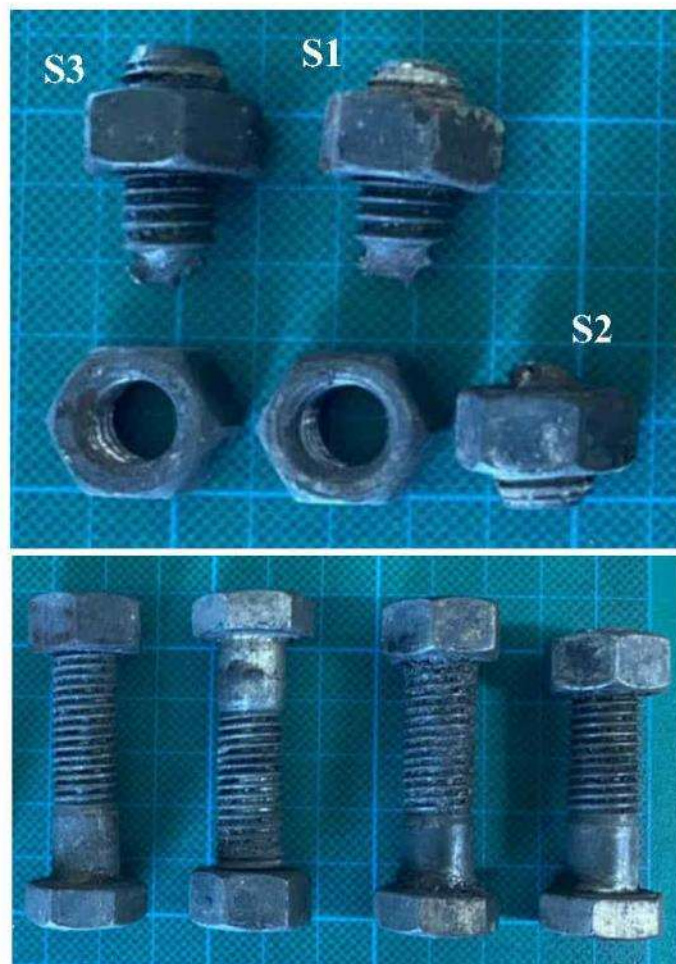
圖 1 剛收到未經處理的螺栓斷件及完整螺栓。
