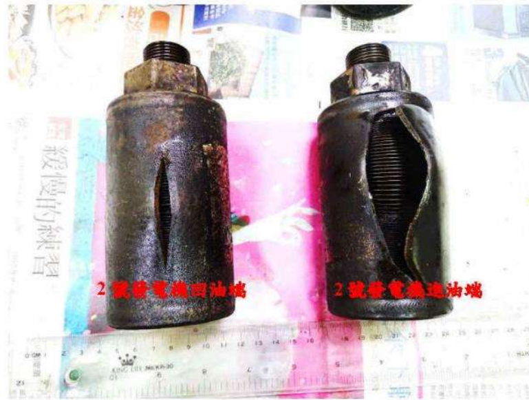
照片二：2號發電機進油端與回油端減震器外觀
