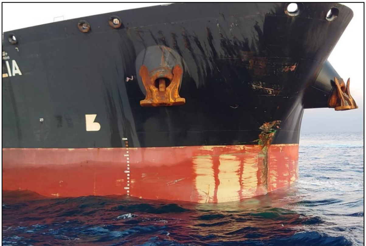
圖 1.2-2 LIA 船艙外殼損傷狀況
