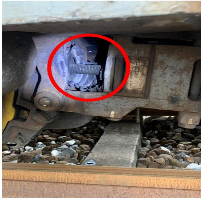
圖 1.1-1 軛缸調整桿防塵橡皮套燒毀
