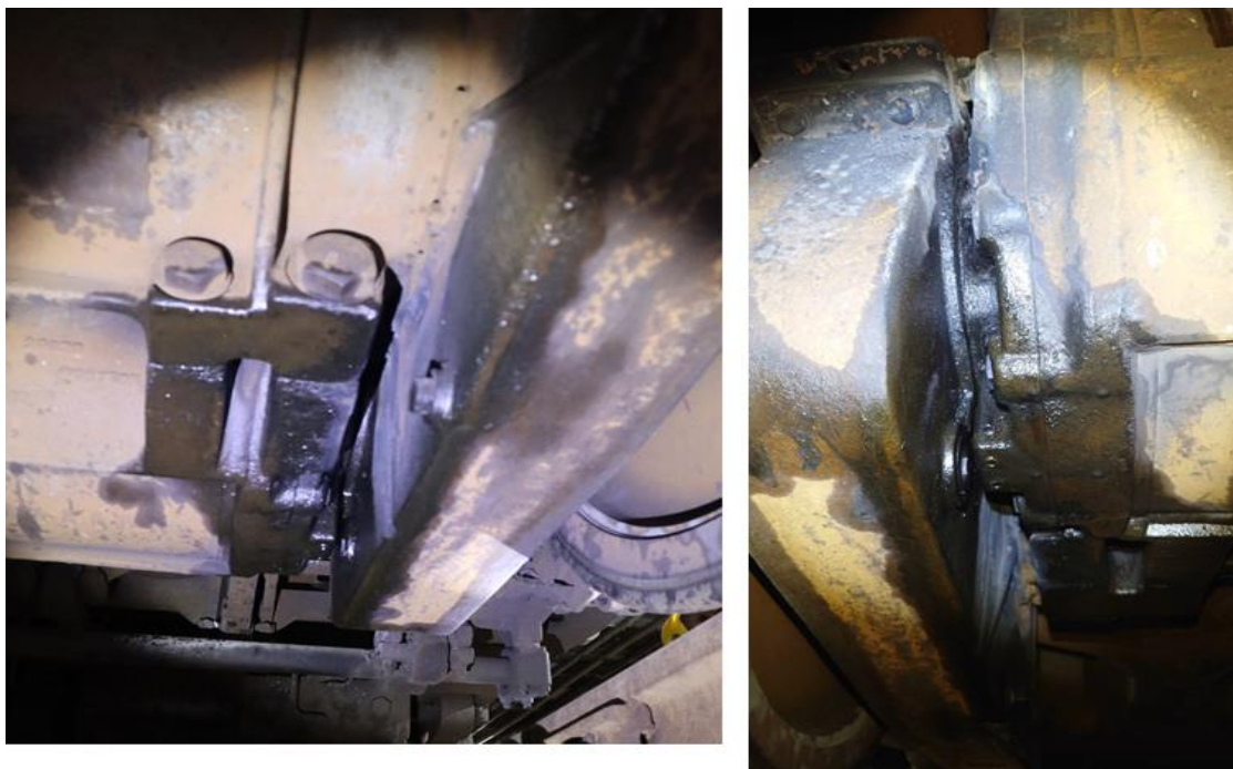
圖 1.8-1 EMC580 馬達及齒輪箱外殼油漬
