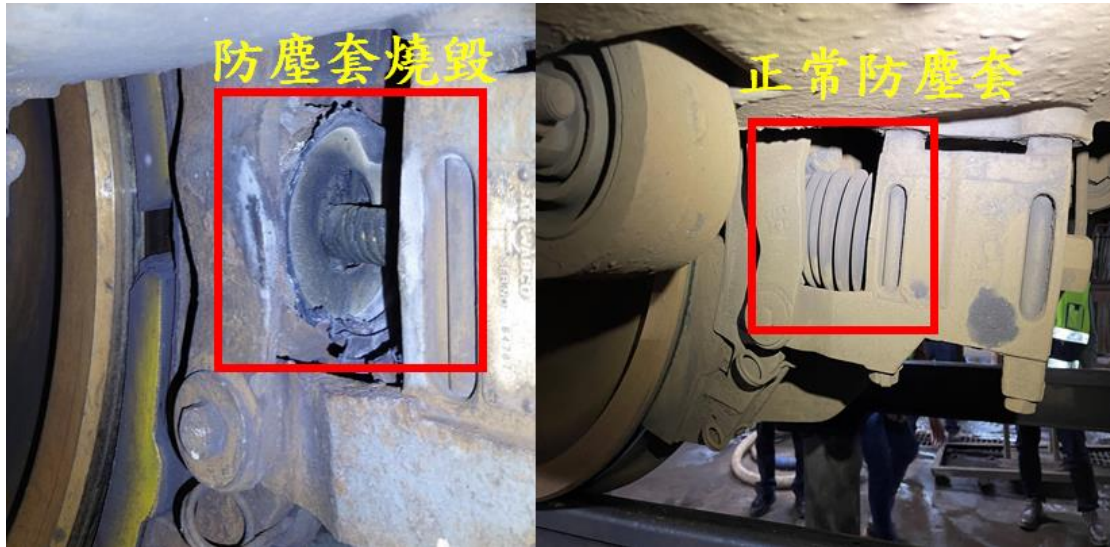
圖 1.2-3 第 2 轉向架第 1 車軸設備損害情形-2
