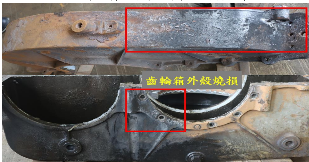
圖 1.2-5 第 2 轉向架第 1 車軸設備損害情形-4
