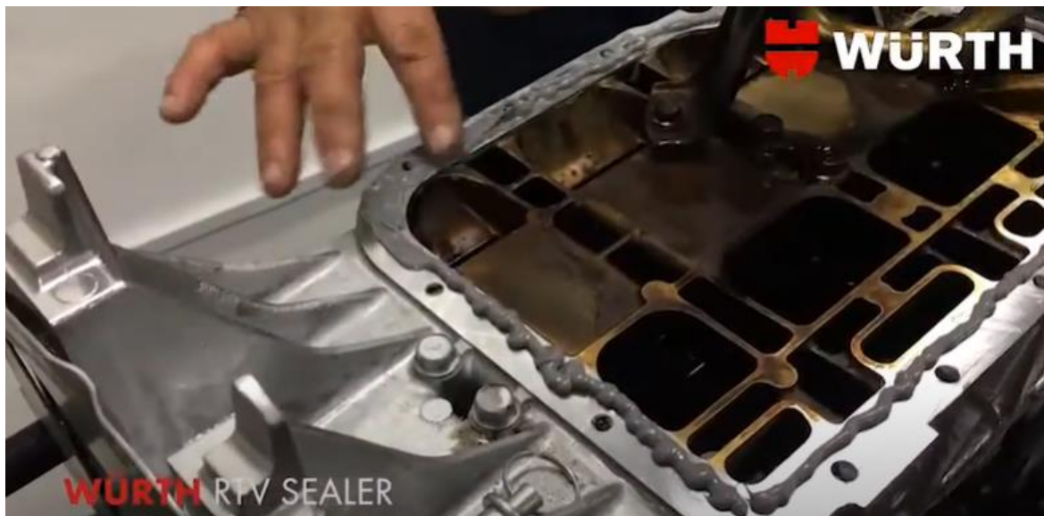
圖 2.3-5 WÜRTH 公司示範塗抹密封膠影片
