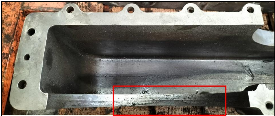
圖 2.3-1 齒輪箱接合面髒汙（非事故車）
