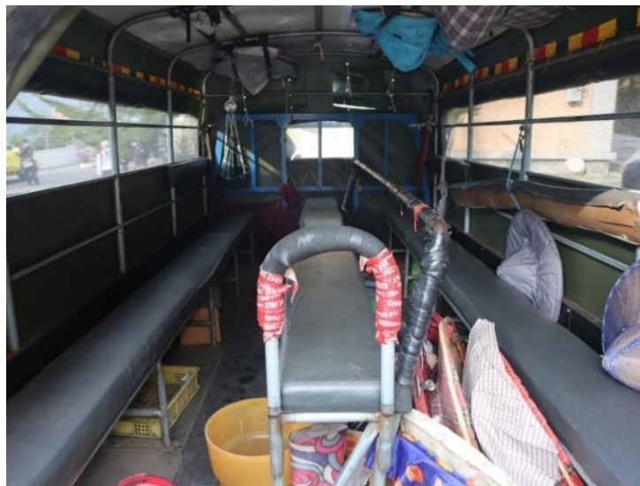
圖 1.12-1 後車廂改裝之座位配置
