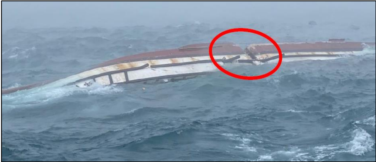
圖 4 漁山漁船船底受損
