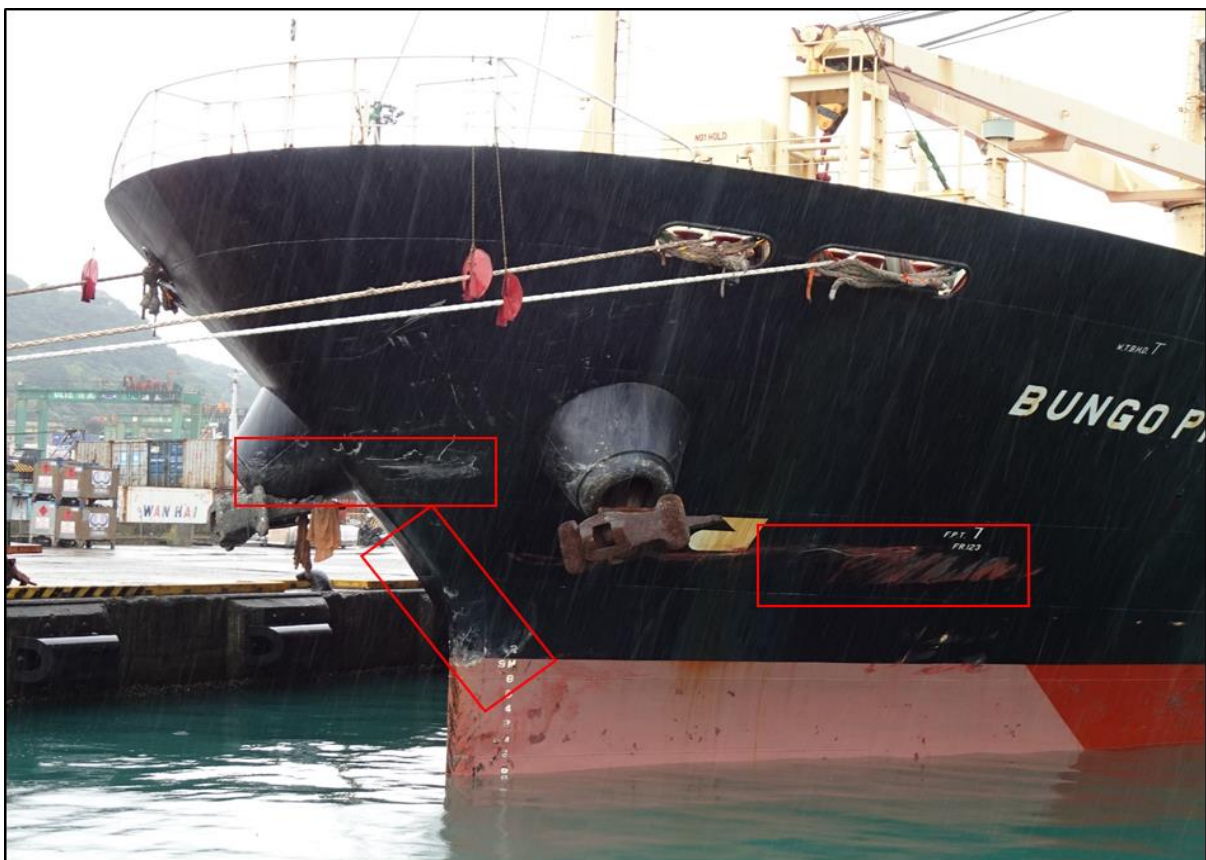
圖 5 邦克公主雜貨船多處刮痕現場照片
