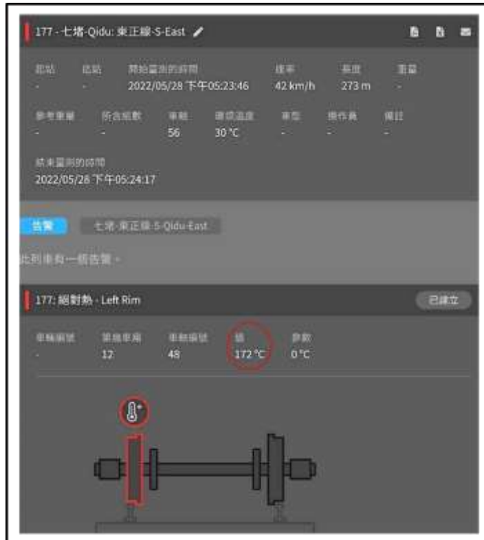
圖 1.1-3 第 177 次車問題車軸山側車輪踏面高溫告警
