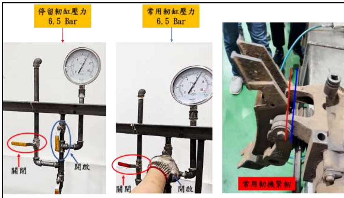
圖 1.9-4 常用初機緊軔（閘瓦托架向前至紅線）
