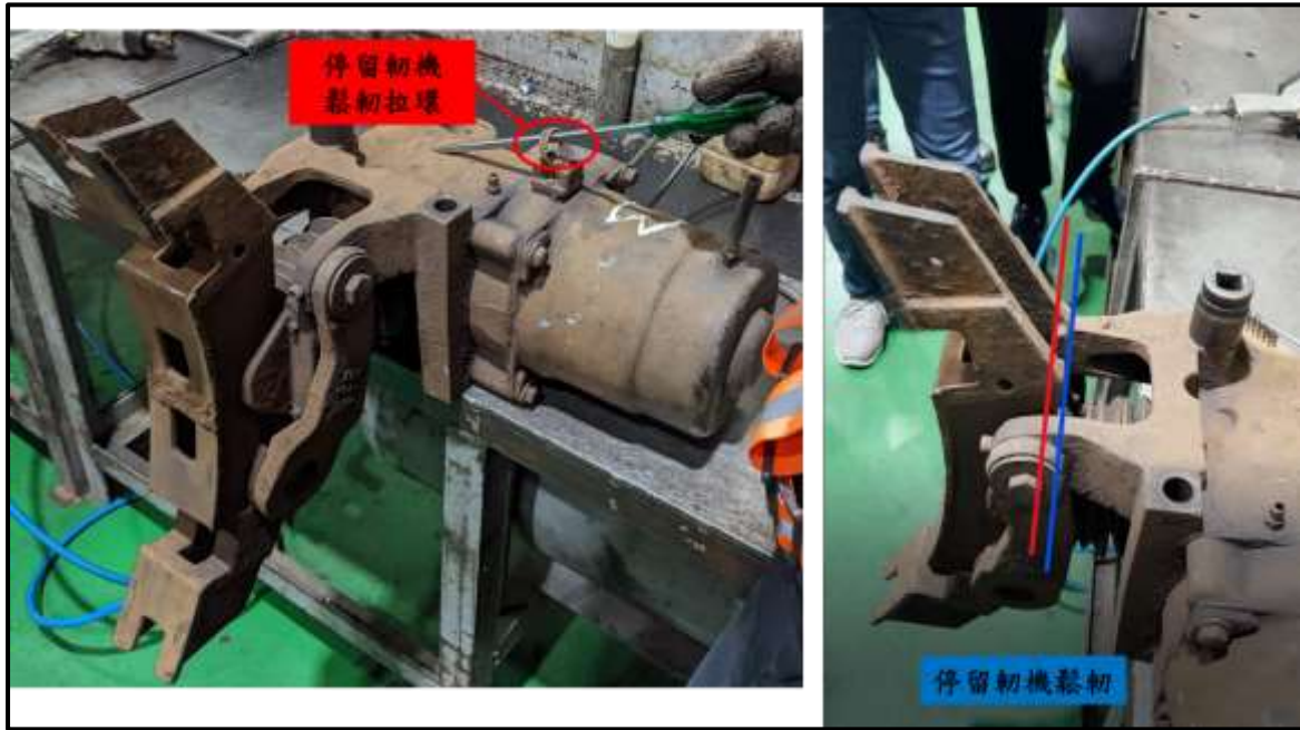
圖 1.9-5 停留軔機鬆軔拉環手動解鎖（閘瓦托架向後至藍線）
