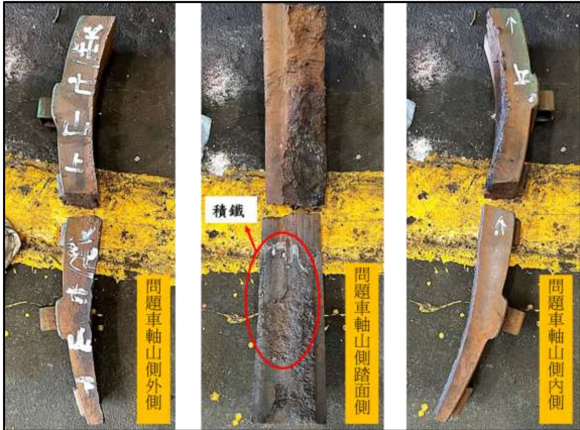
圖 1.2-4 問題車軸山側閘瓦有積鐵
