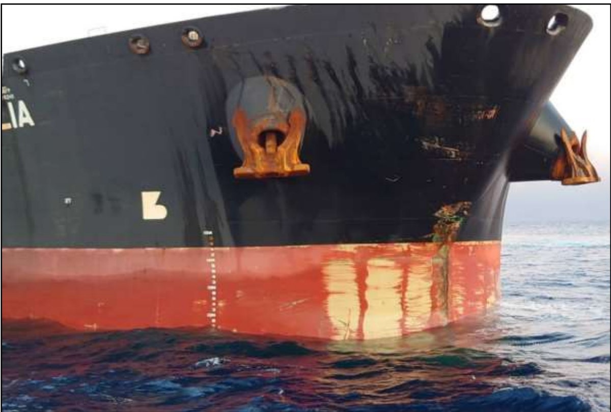
圖 1.2-2 LIA 船艙外殼損傷狀況
