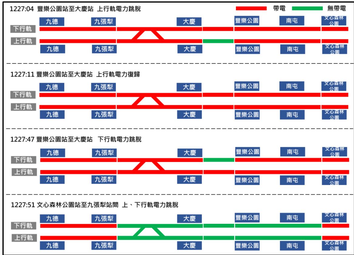
圖 1.12-10 本次事故第三軌供電狀況時序圖
