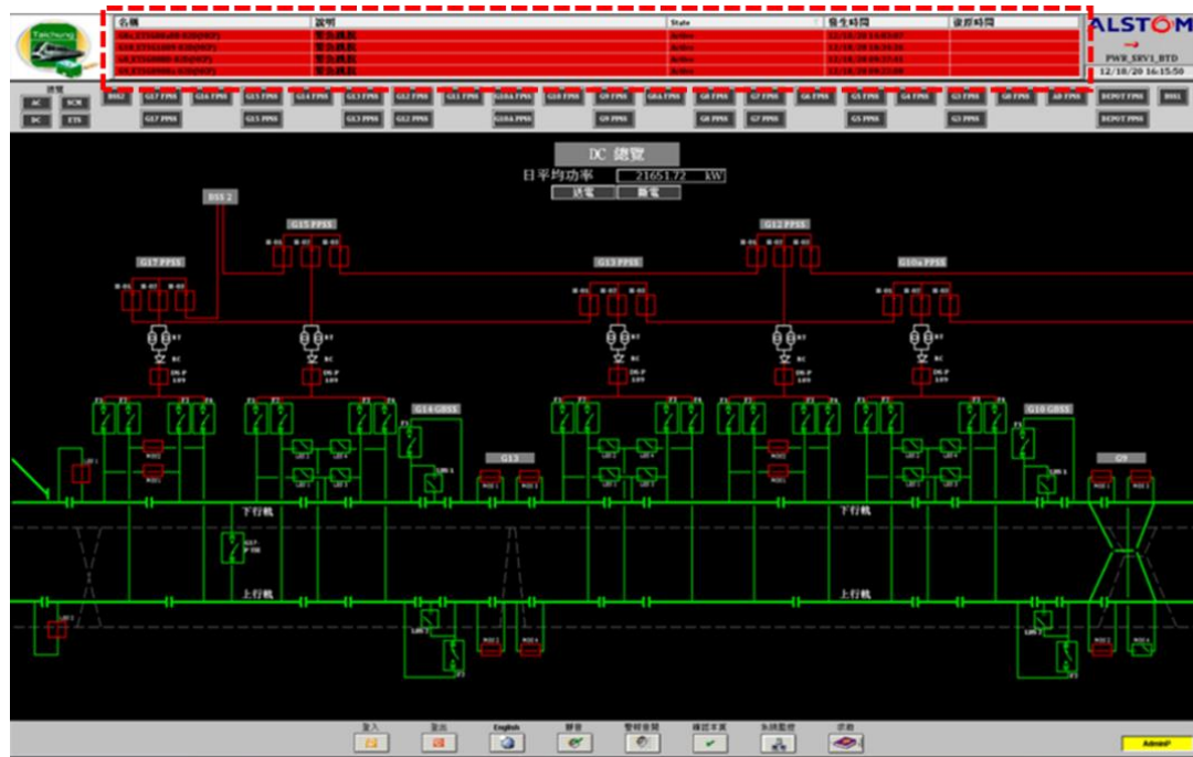
圖 1.10-7 PWR SCADA 頂部橫幅告警顯示
