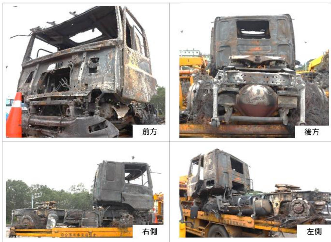
圖 1.3-1 事故曳引車損害情形
