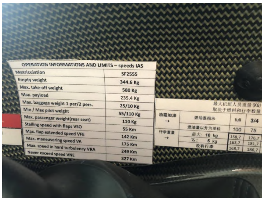
圖 21 操作資訊與限制告示牌（左）、人員總重限制告示牌（右）
