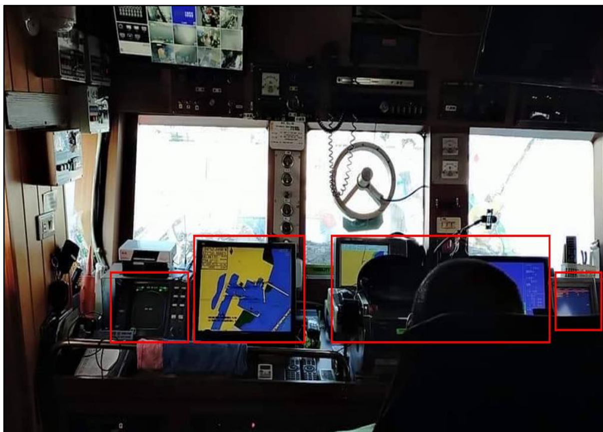
圖 20 漁山駕駛臺（由左至右）配置雷達、2 部電子海圖含 AIS 及魚探機
