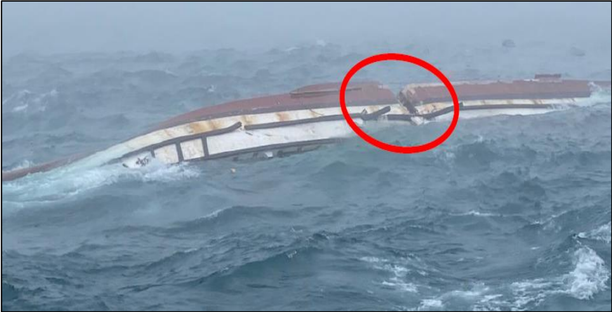
圖 4 漁山漁船船底受損
