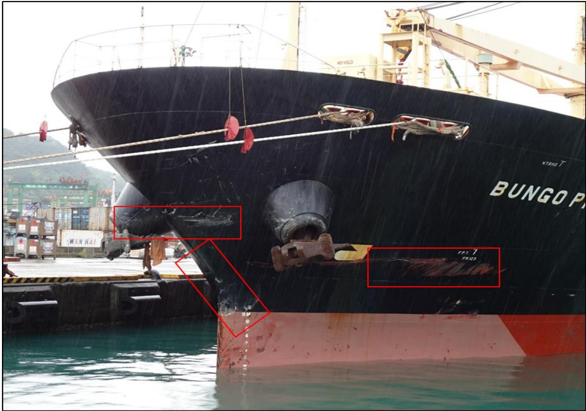
圖 5 邦克公主雜貨船多處刮痕現場照片
