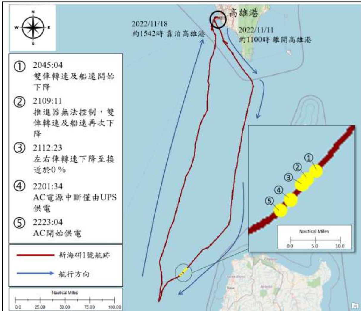
圖 6 事故船 11 月 11 日 0811 時至 11 月 19 日 0038 時 AIS 航跡圖
