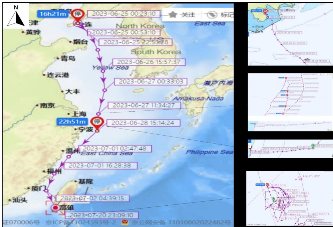
圖 1.10-1 天使輪事故航次之 AIS 航跡
