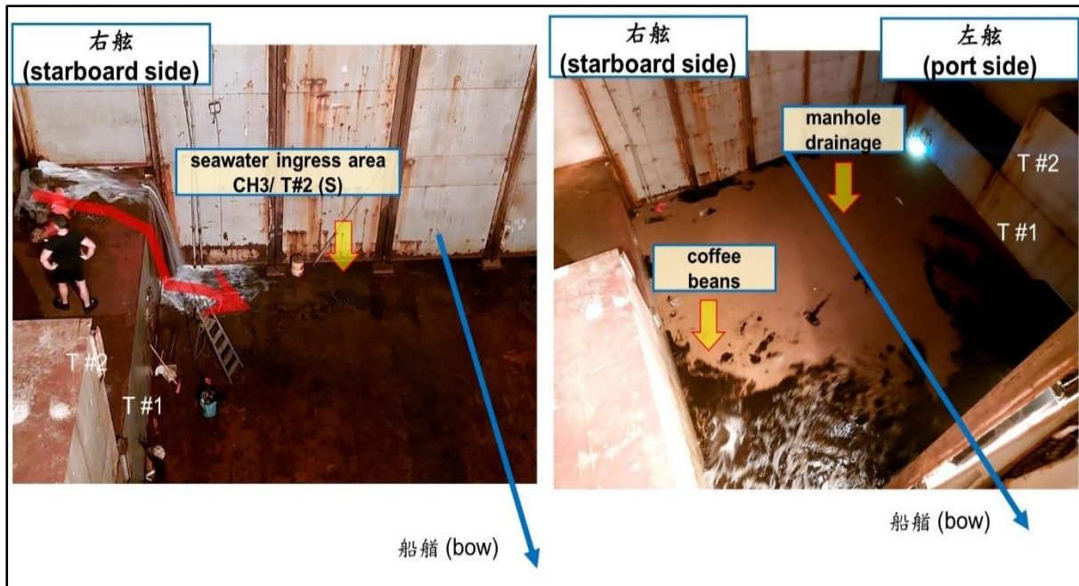
圖 1.1-4 天使輪第 3 貨艙進水及船員清理前外觀圖
