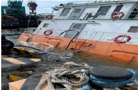
圖 2.2.2-7 拖船 14402 船體破裂進水
