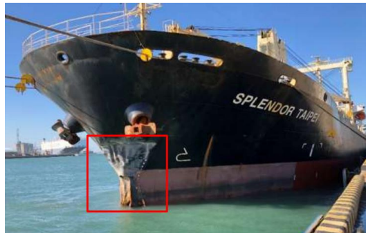
圖 2.2.2-4 榮茂船艏損壞
