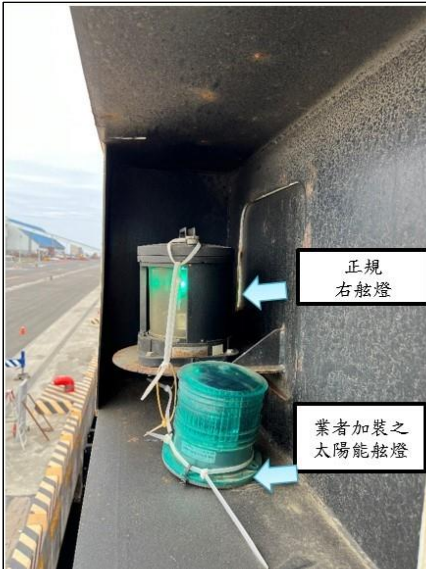
圖 1.7-7 運輸駁船正規右舷燈開啟測試照片（事故後）
