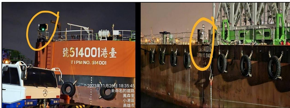
圖 1.7-6 運輸駁船太陽能舷燈與艙燈船開啟照片（事故後）
