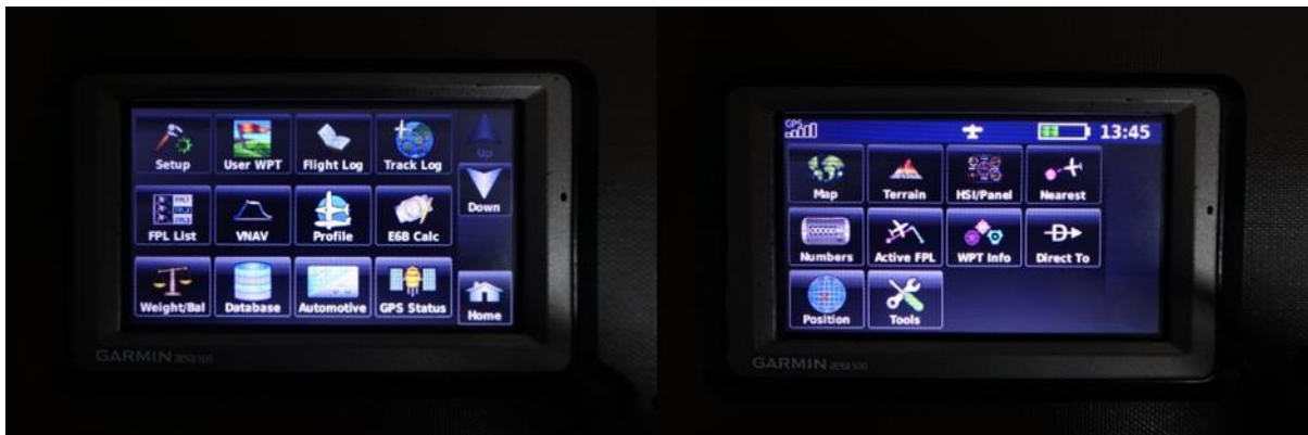
圖 1.11.3-1 機載 GPS 接收機開機畫面
