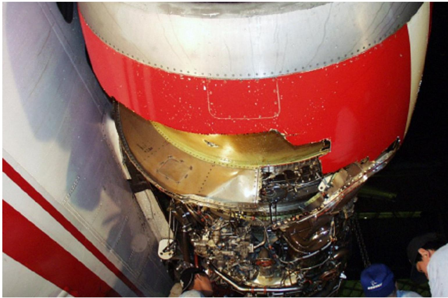
圖四、遠東航空公司 EF184 班機起飛時撞擊跑道端燈
