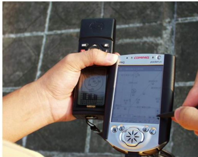
圖二十、整合衛星定位系統與雷射測距儀之測量裝備
