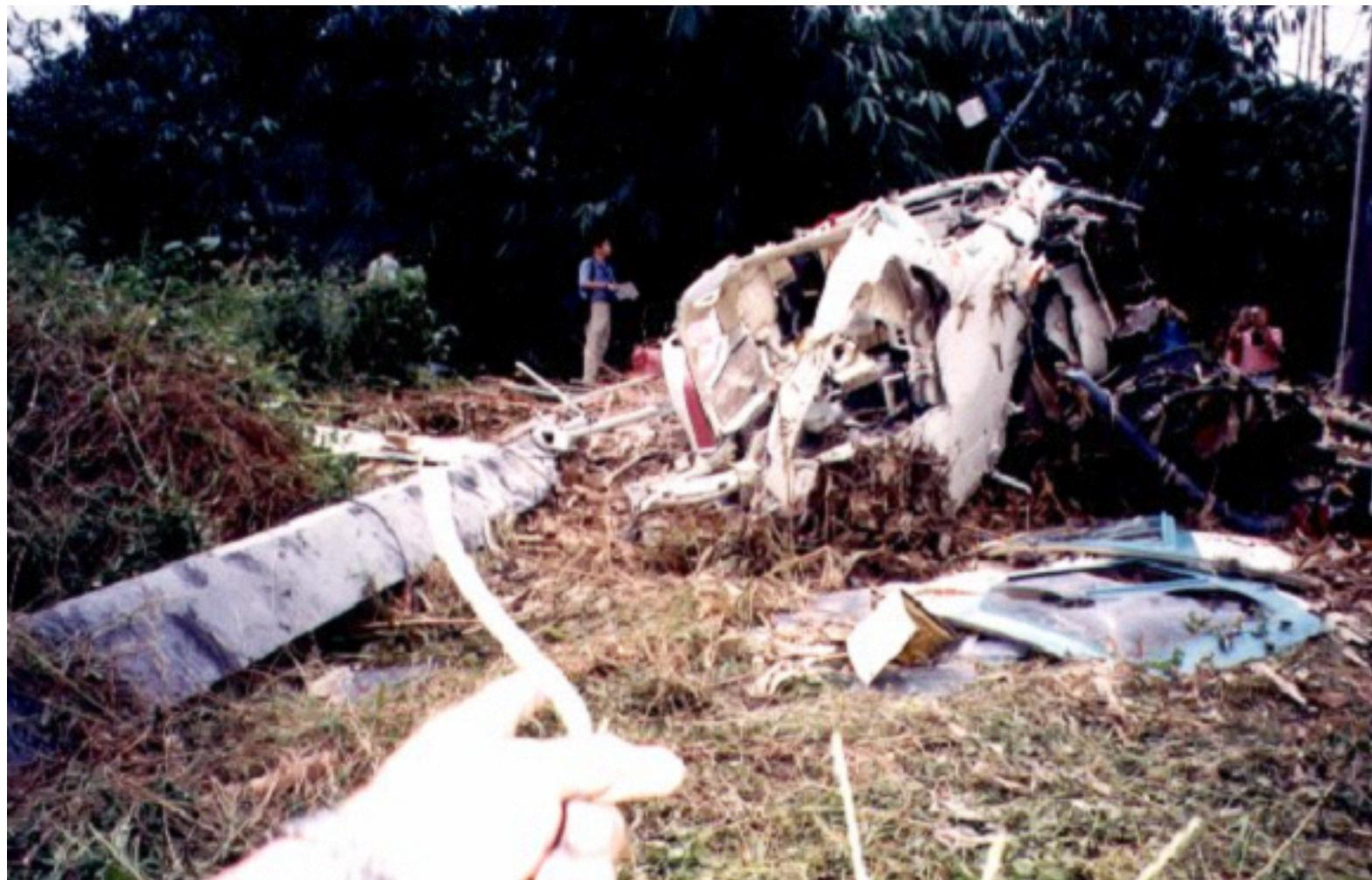
圖十一、凌天航空公司直昇機機型 BELL-206B-3 B-31135 縱掃作業中勾撞電纜墜毀
