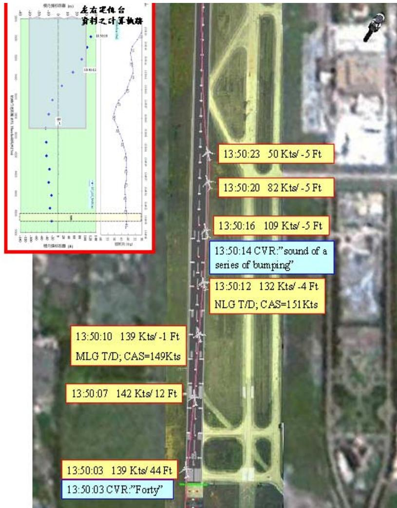
圖二十二、AE838 班機於中正機場 05L 跑道落地過程軌跡分析
