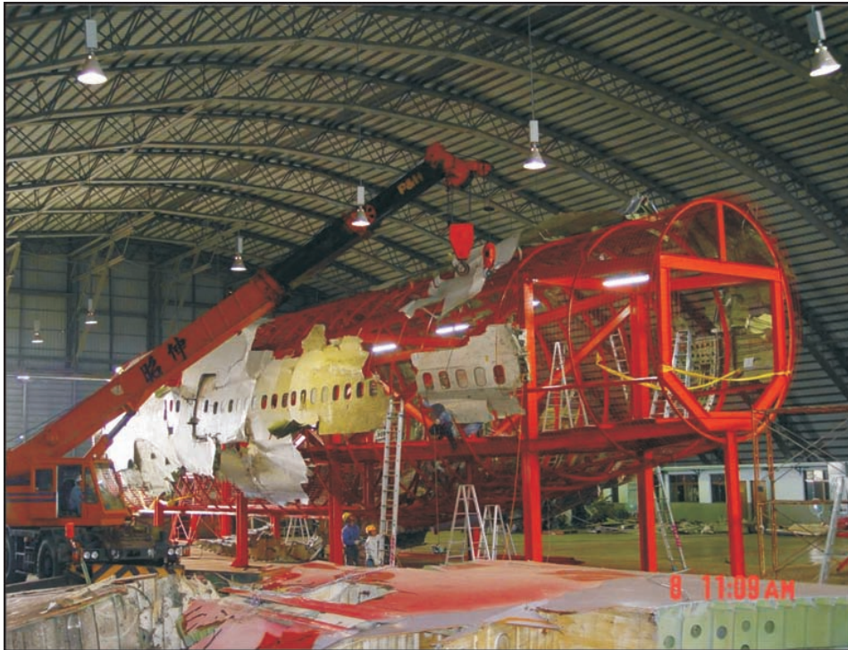
飛機後段三維硬體重建情形
