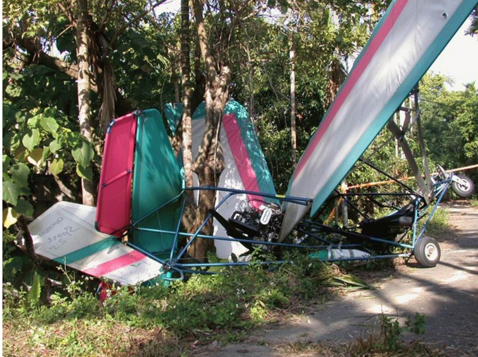
圖 3-11 該機損害情形
