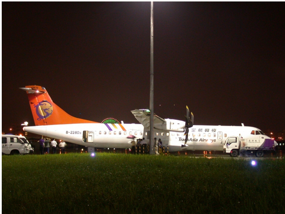
圖 3-1 右機翼前緣撞及停機坪照明燈柱情形
