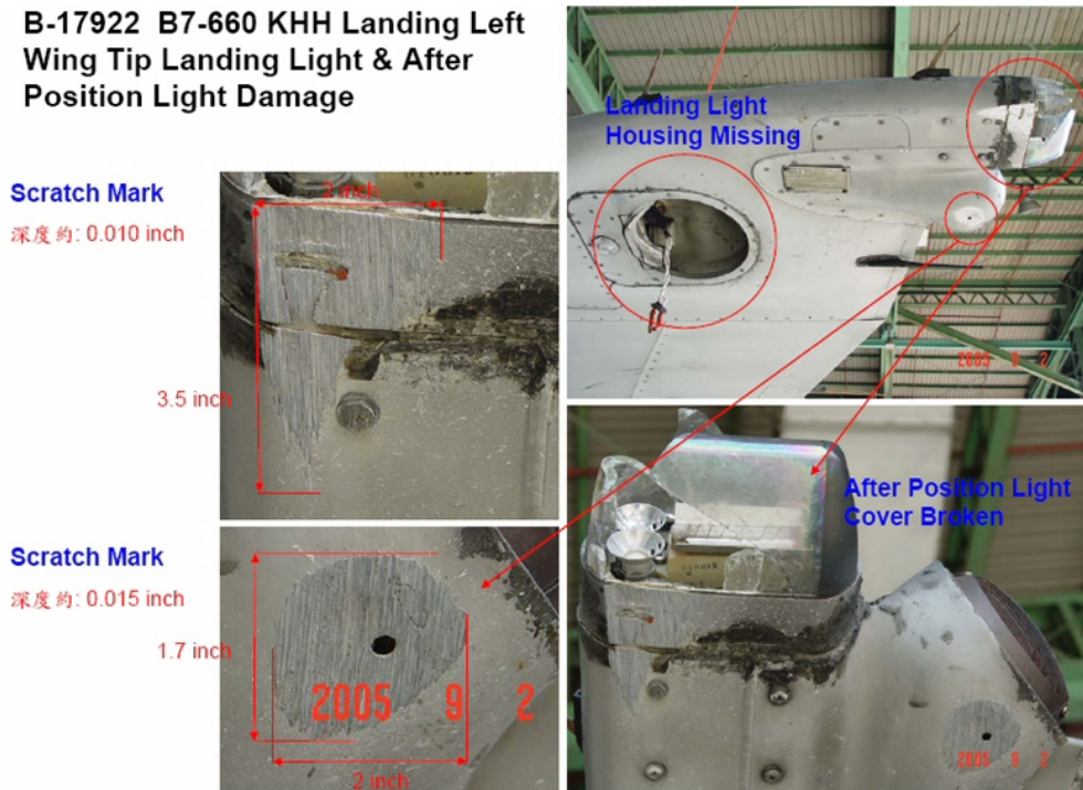
圖 3-12 左下翼尖刮痕、飛機左落地燈及左位置燈受損情形
