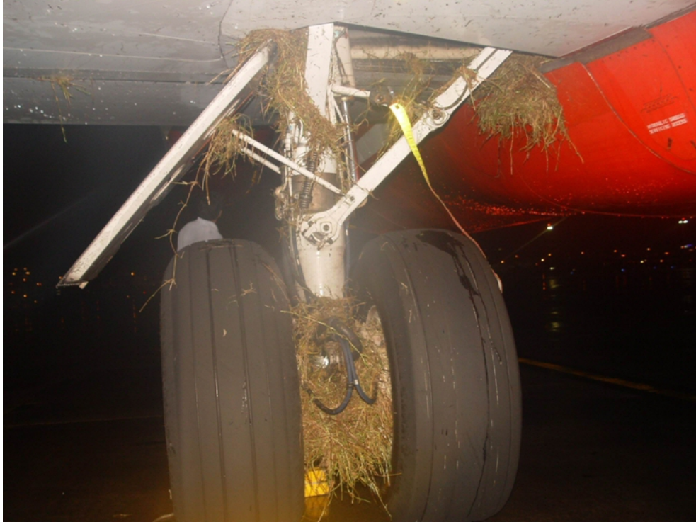
圖 3-5 該機主輪受損情形
