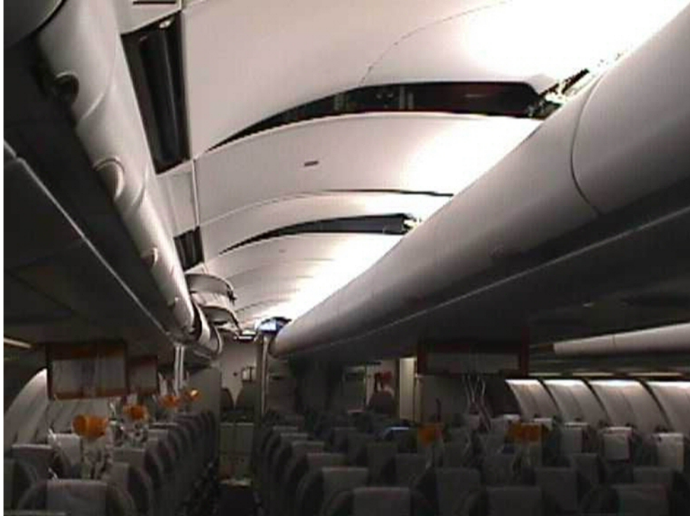
圖 3-10 客艙內部受損情形
