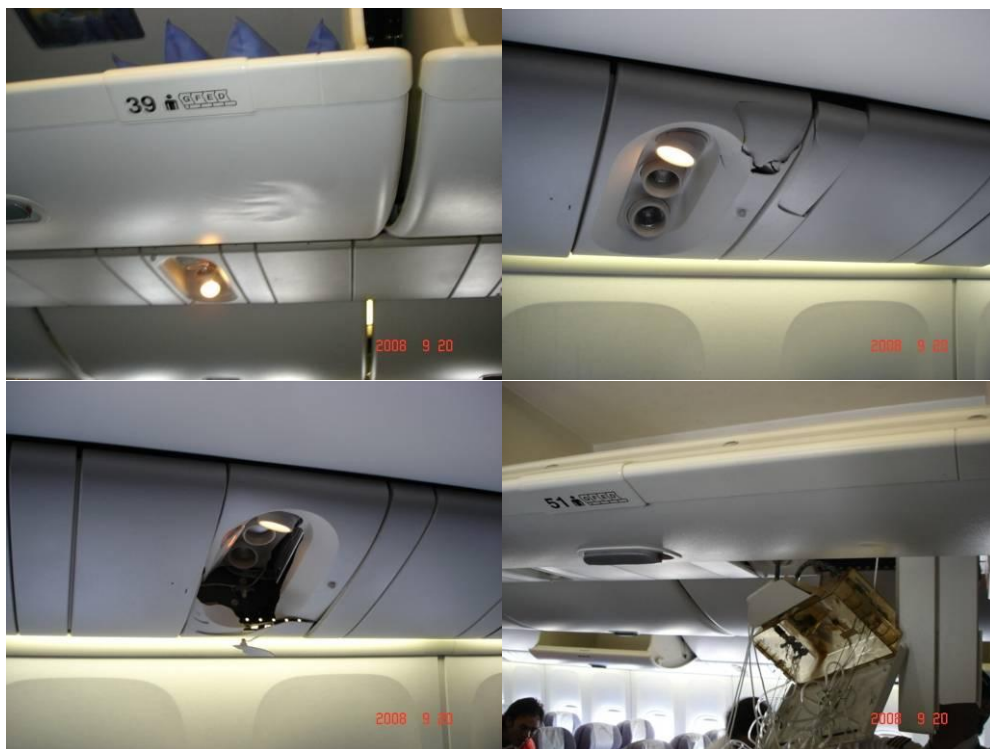
圖 3-12 CI687 班機客艙損害狀況
