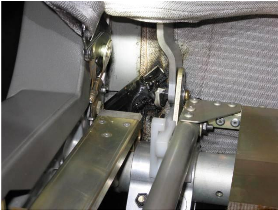
圖 3-15 JAL653 班機冒煙並引發火警之乘客座椅與打火機殘骸
