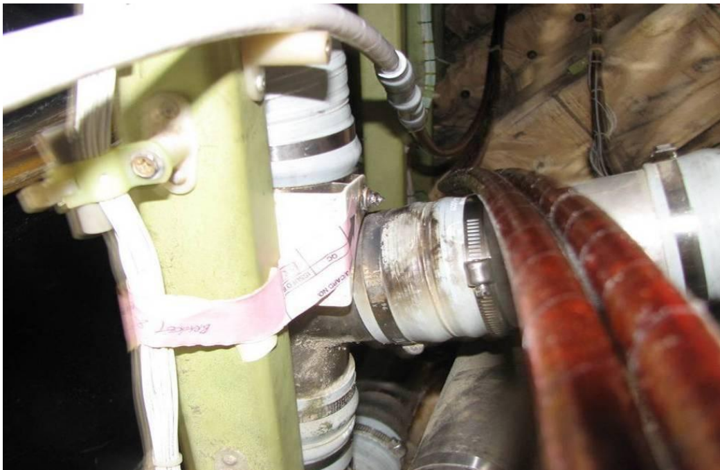
圖 3-1 BR67 班機電線短路位置
