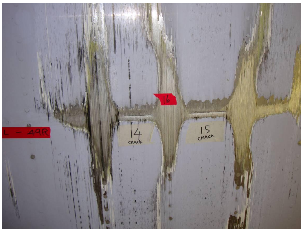
圖 3-6 CI5233 班機局部蒙皮損傷情形
