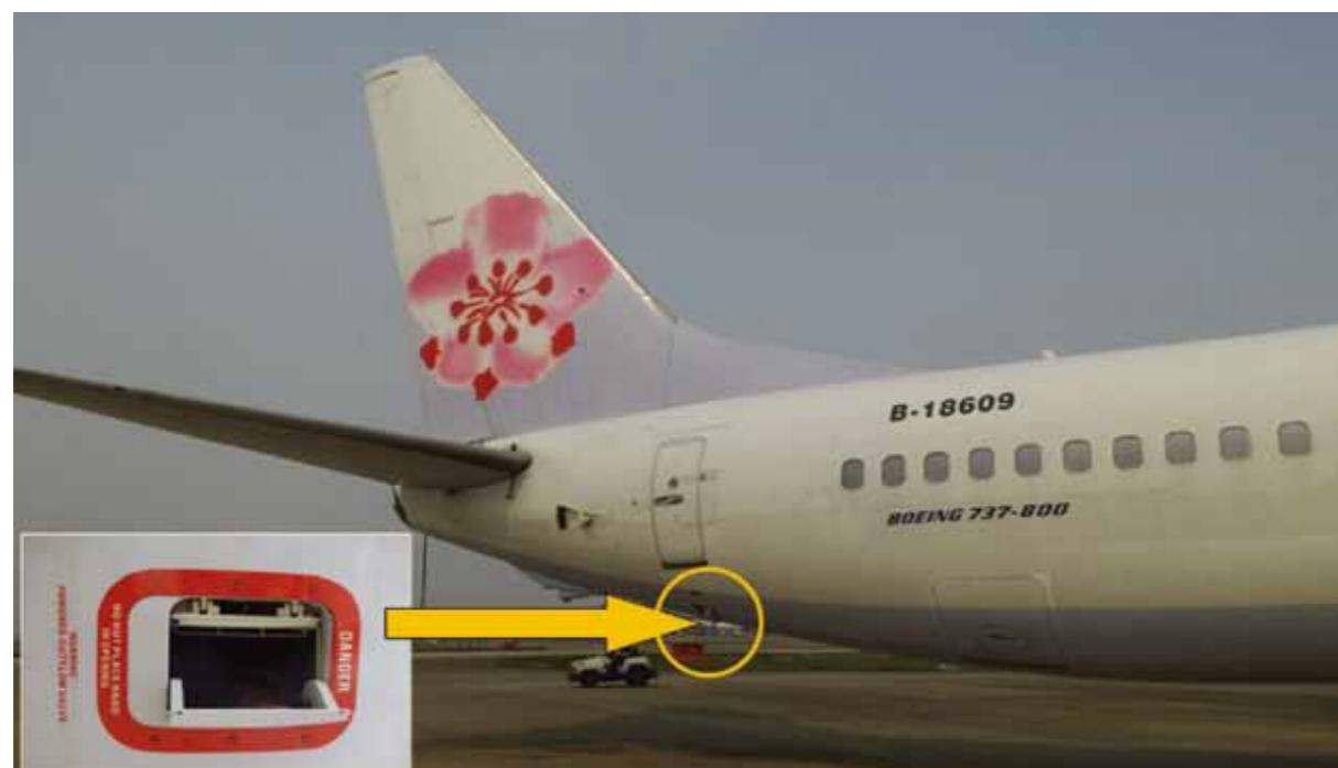
圖 2-2 事故機艙壓調控制系統之外流閥位置
