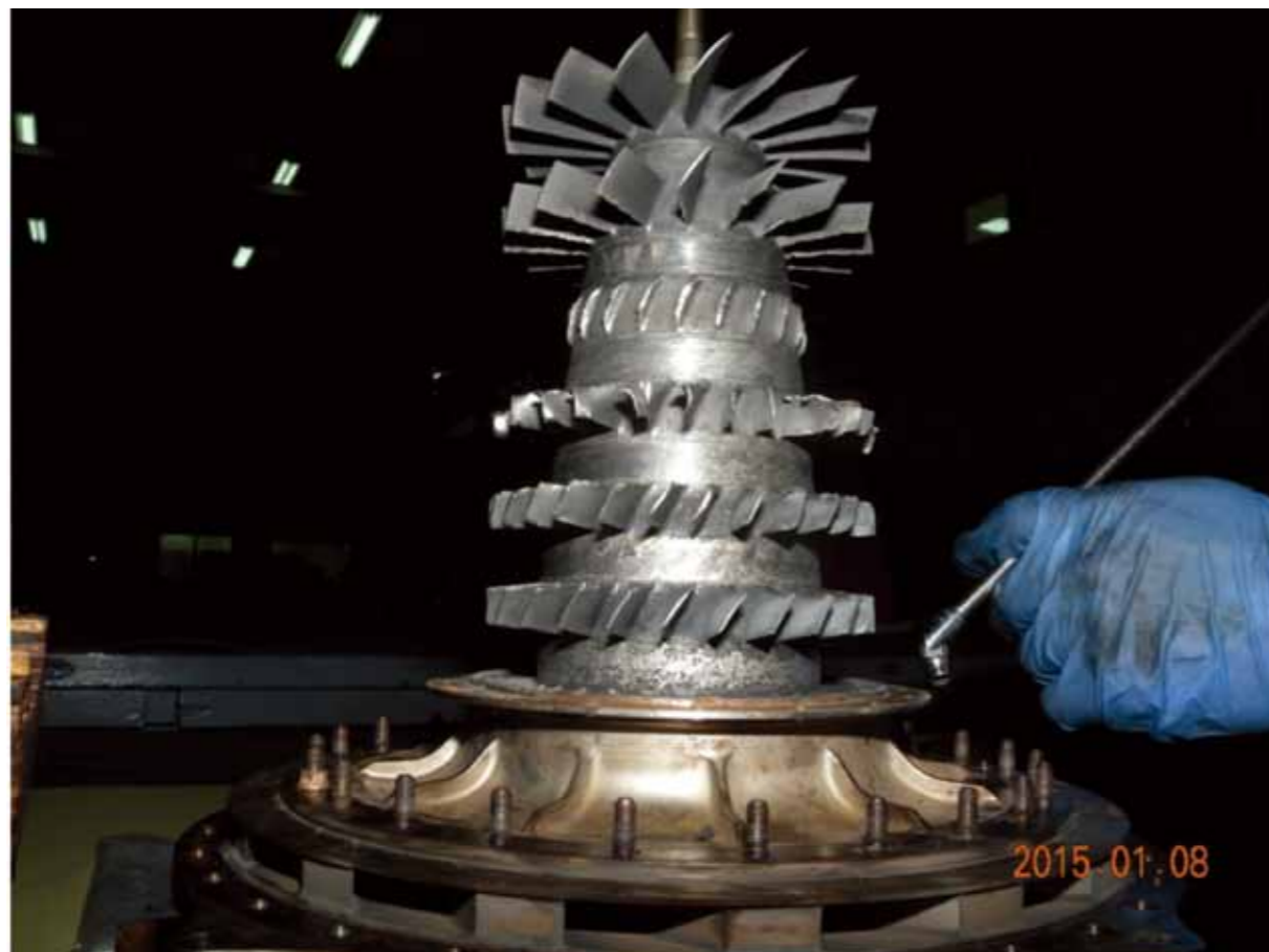
圖 2-10 事故機發動機轉子第 3 級葉片損壞情形
