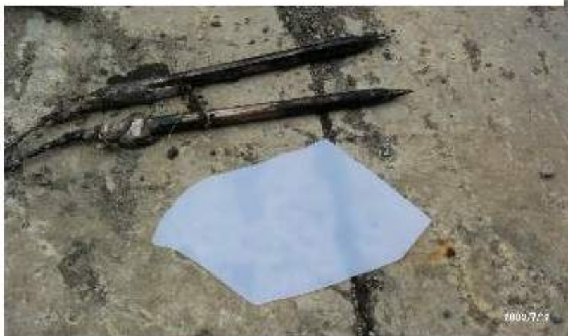
c. 置物箱起爆產生之碎片及因高溫損毀之爆壓感測器
