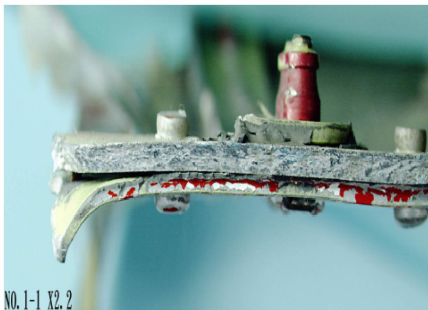
圖 2. 客艙窗戶結構破損件編號 1-1 端斷面的巨觀觀察。(2.2X)
