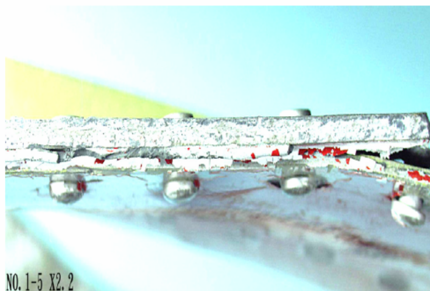
圖 6. 客艙窗戶結構破損件編號 1-5 端斷面的巨觀觀察。(2.2X)
