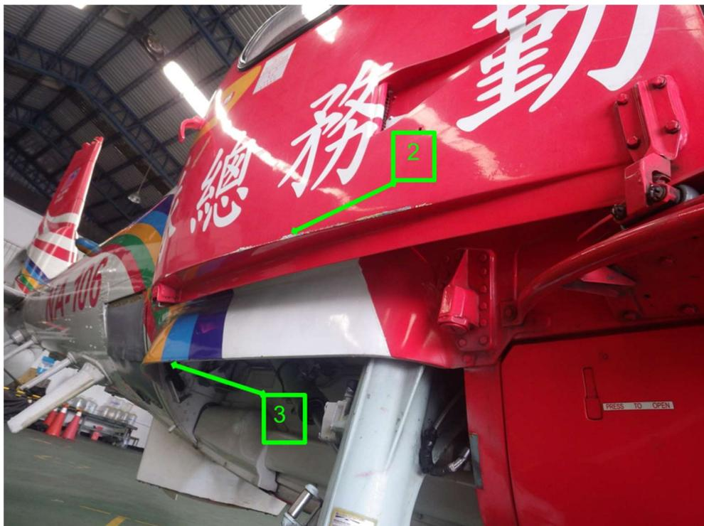
圖 1.12-4 機身右側艙門塗層脫落情形
