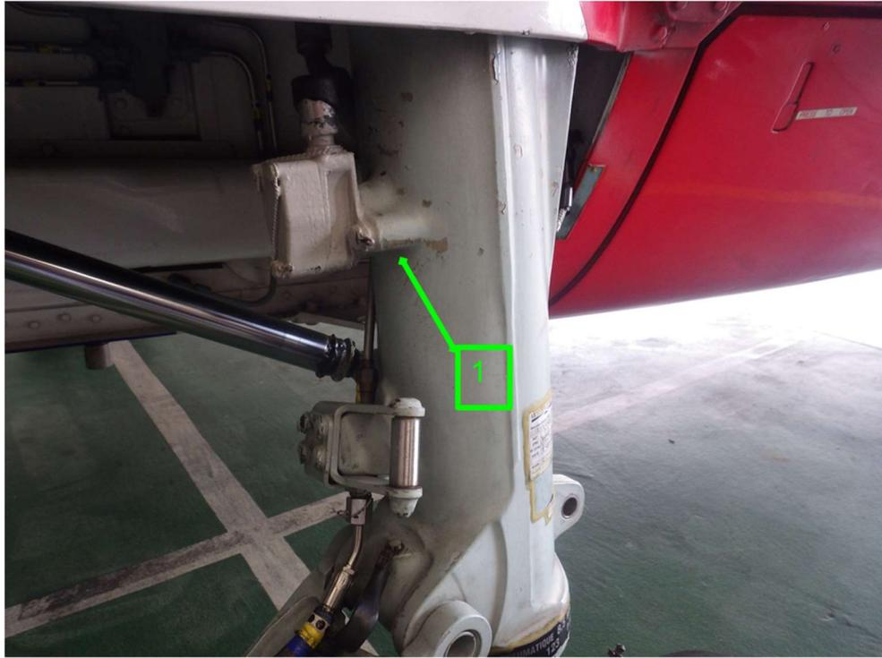
圖 1.12-3 機身右側起落架塗層脫落情形
