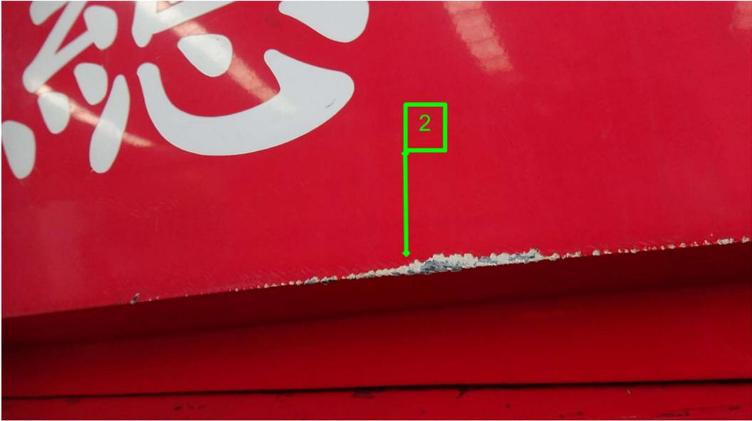
圖 1.12-5 機身右側艙門塗層脫落情形
