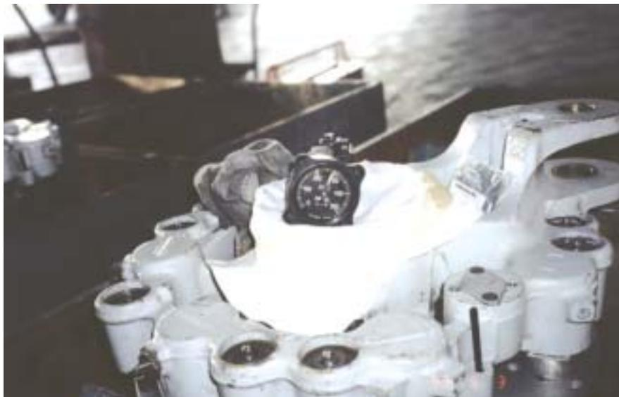
圖 1-28 外接壓力表顯示壓力 3000PSI
