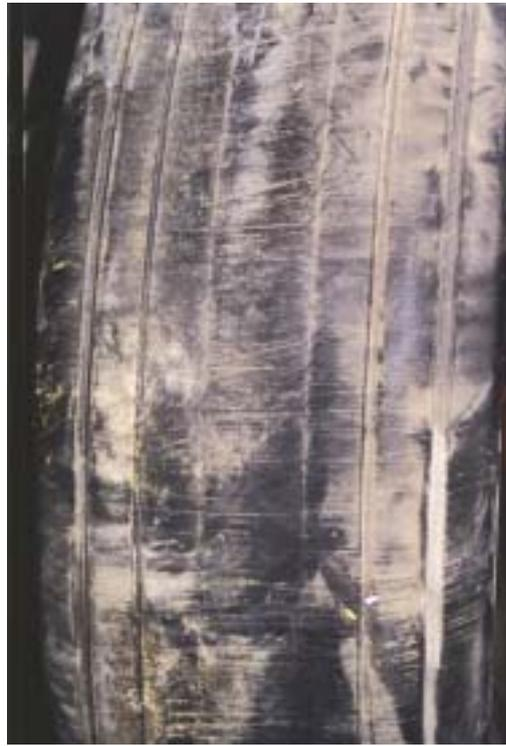
圖 1-14 整圈胎面佈滿與溝槽垂直之磨擦痕跡
