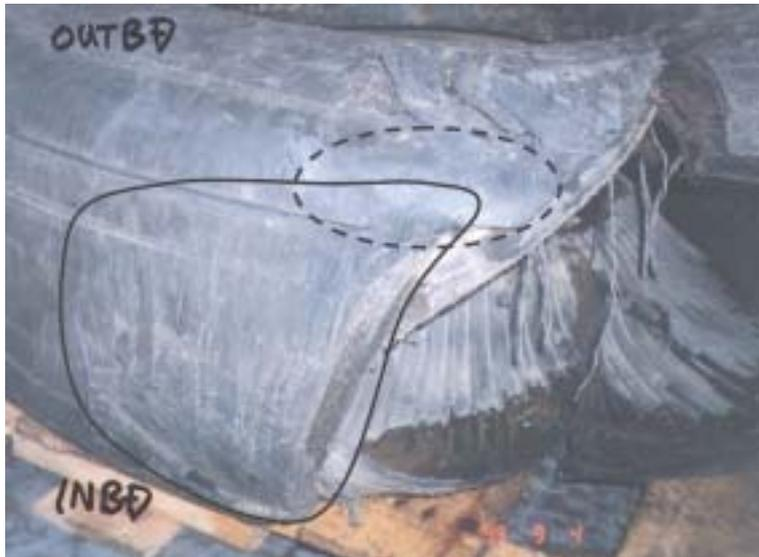
圖 1-19 鼻輪起落架左胎破洞邊之扇形磨損區域及白色痕跡
