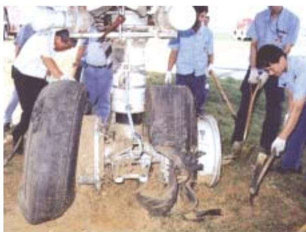
圖 1-2 鼻輪損壞情形
