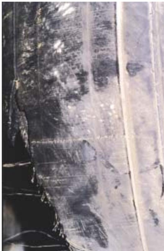
圖 1-20 整圈胎面皆有與溝槽垂直之磨擦痕跡
