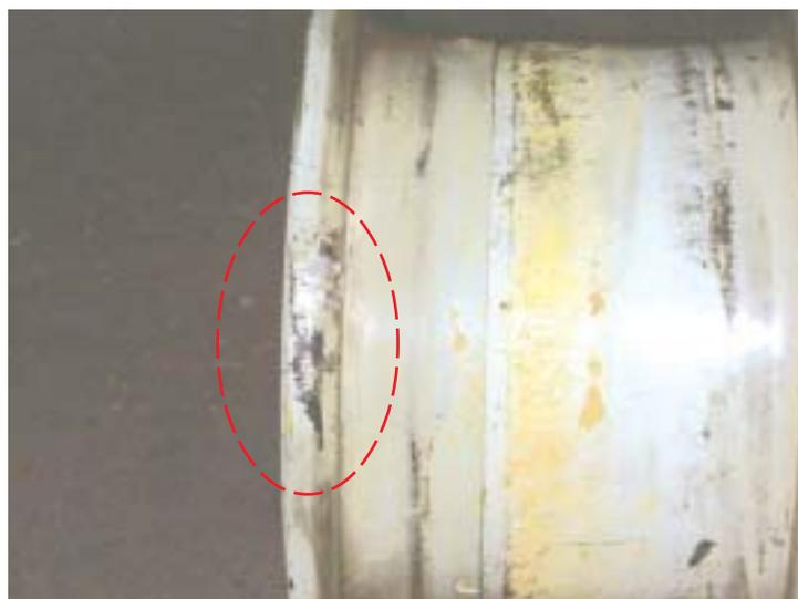
圖 1-9 左凸緣凹陷變形（圓圈標示處）
