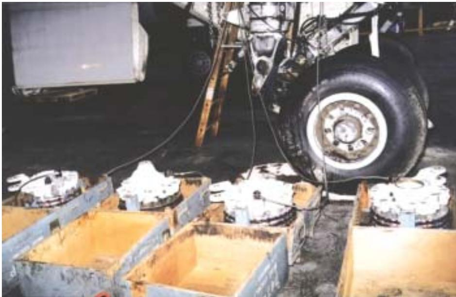
圖 1-27 臨時高壓軟管外接煞車可用件
