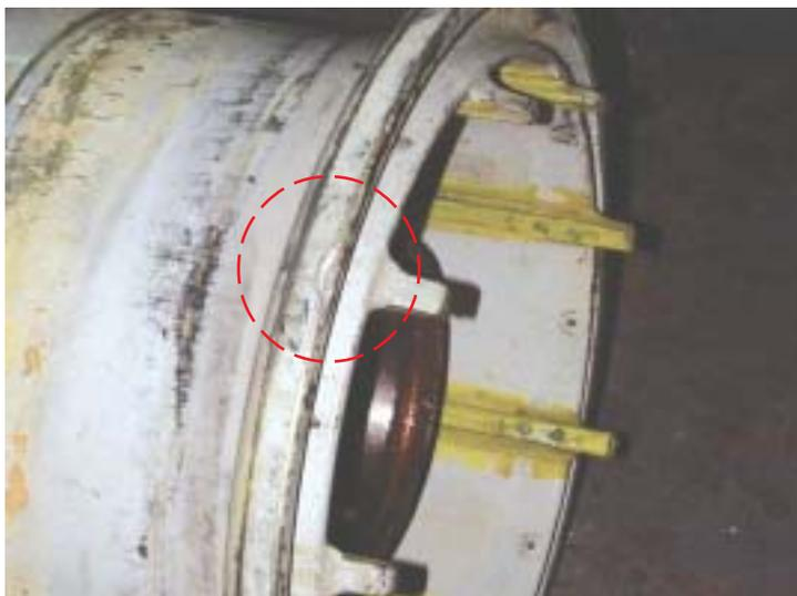
圖 1-10 右凸緣凹陷變形（圓圈標示處）
