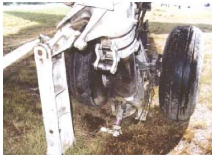
圖 1-4 左機身起落架後輪車損壞情形
