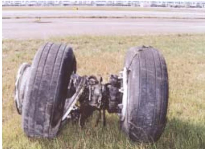
圖 1-3 機身起落架前輪車損壞情形
