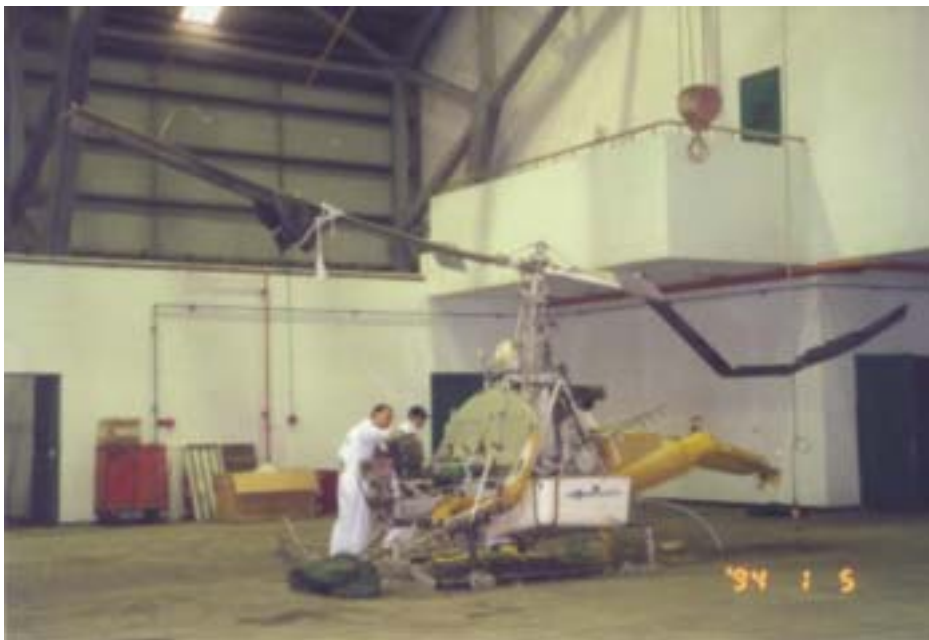
圖 1. 12. 3. 3-2 彎折的主旋翼
