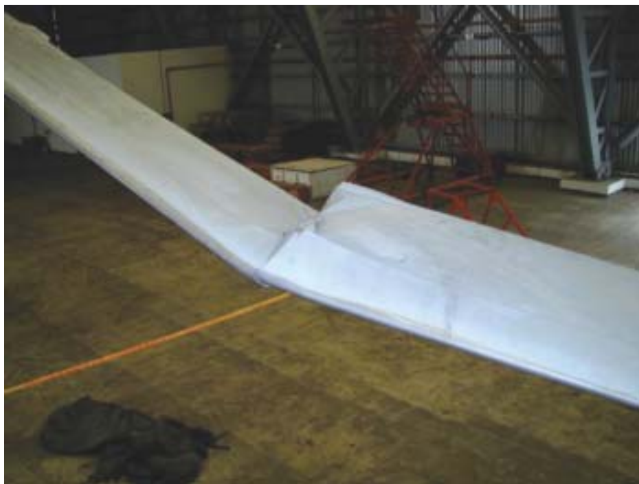
圖 1. 12. 3. 3-3 主旋翼破裂處
