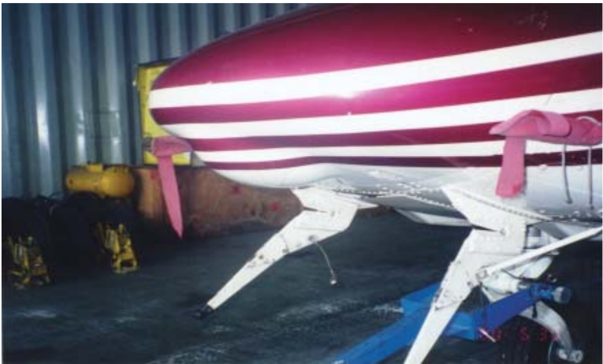
圖1.12-13 下方纜線切割器未損壞前狀況
