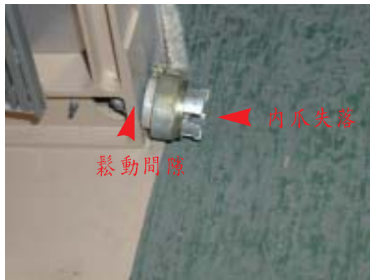
圖1.15-23 底座締緊螺栓鬆動
