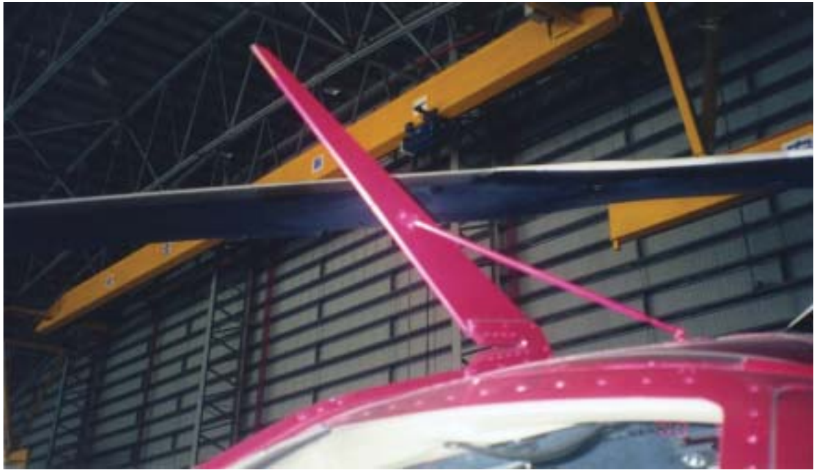
圖1.12-12 上方纜線切割器未損壞前狀況
