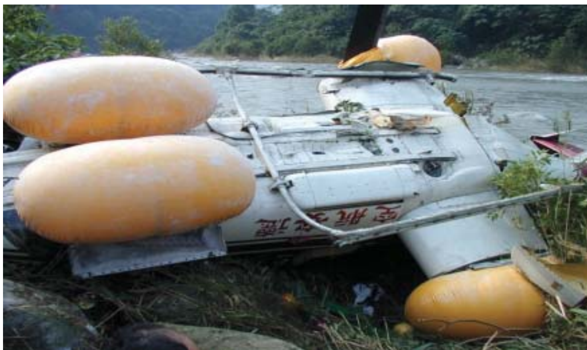
圖1.12-7 航空器翻覆損壞情形（一）
