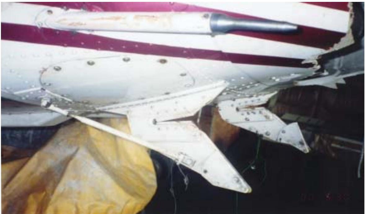
圖1.12-11 該機下方纜線切割器損壞情況
