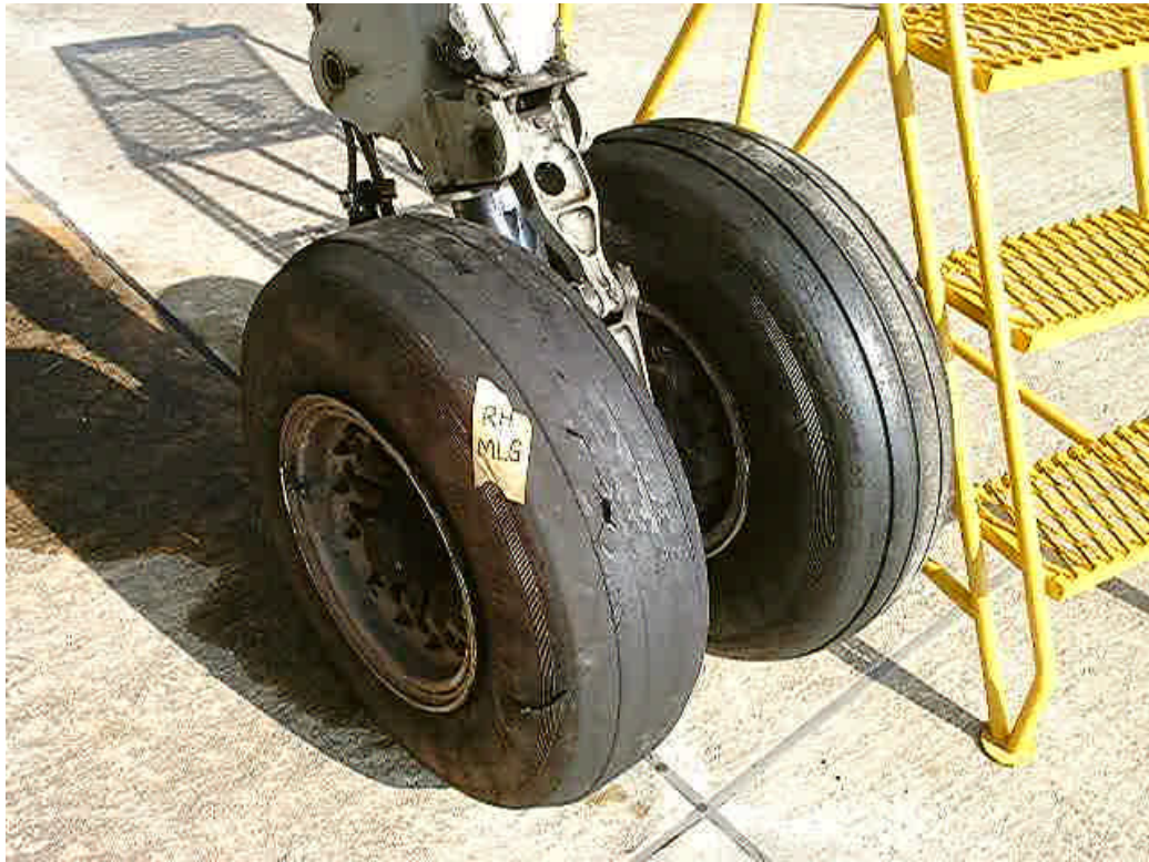
圖 1.12-27 右起落架內側輪胎
