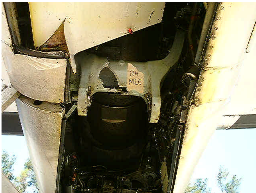
圖 1.12-24 右起落架外筒與軛之結構安全銷
