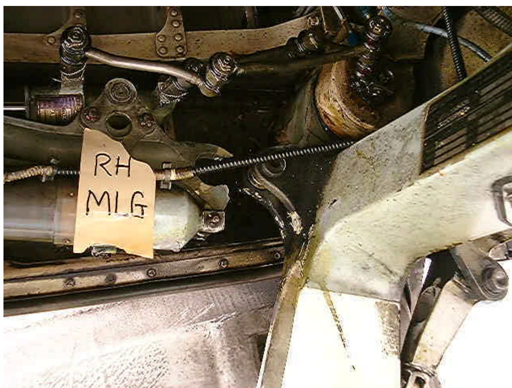
圖 1.12-26 右起落架收起唧筒桿
