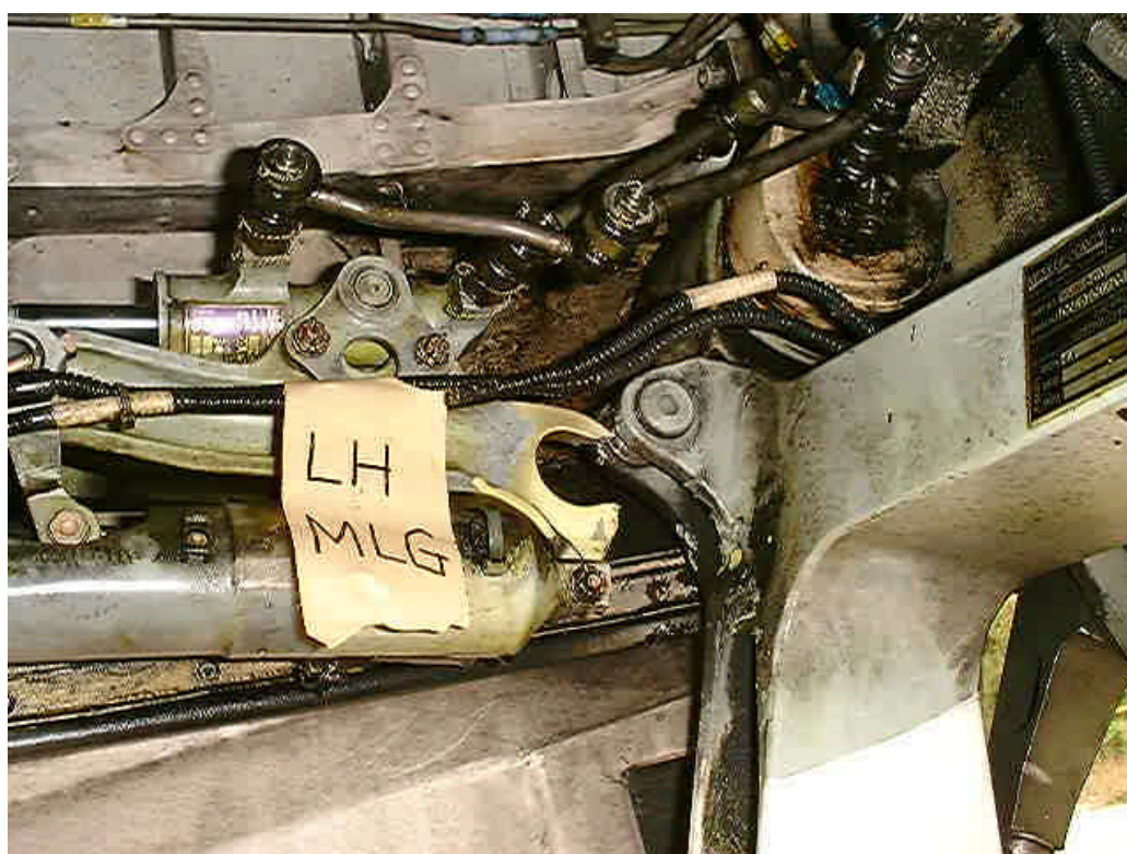
圖 1.12-22 左起落架收起唧筒桿
