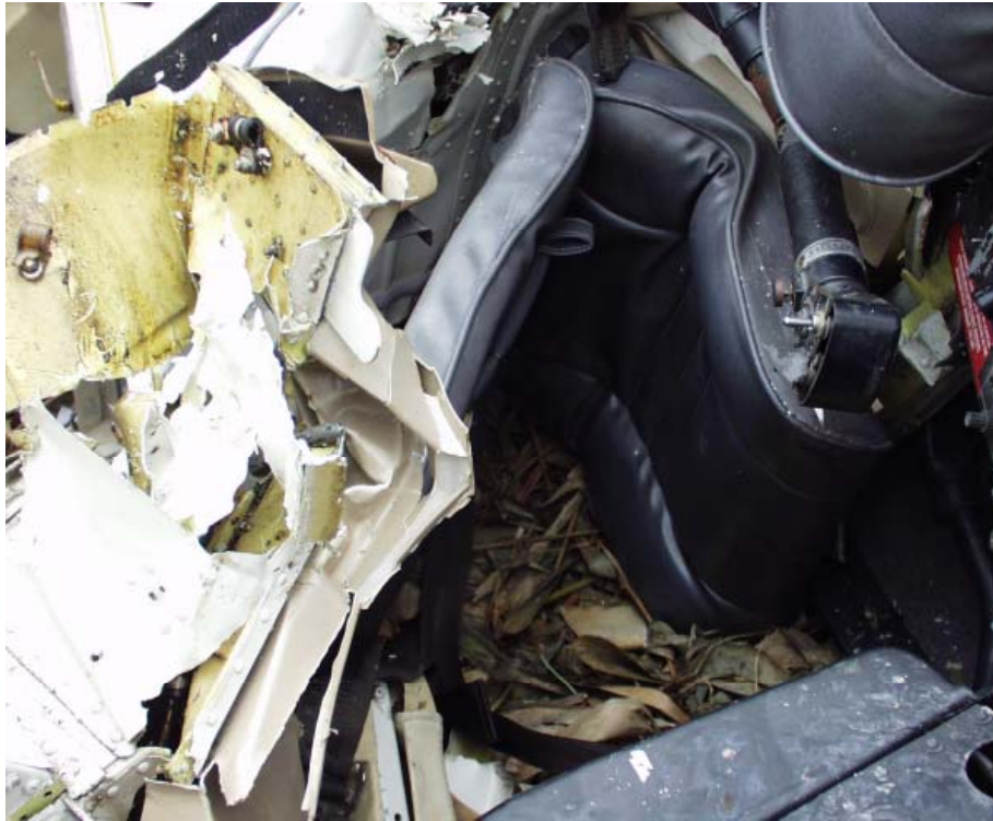
圖 1.12.1.3-1 駕駛座椅背及後方隔框前傾斷折
