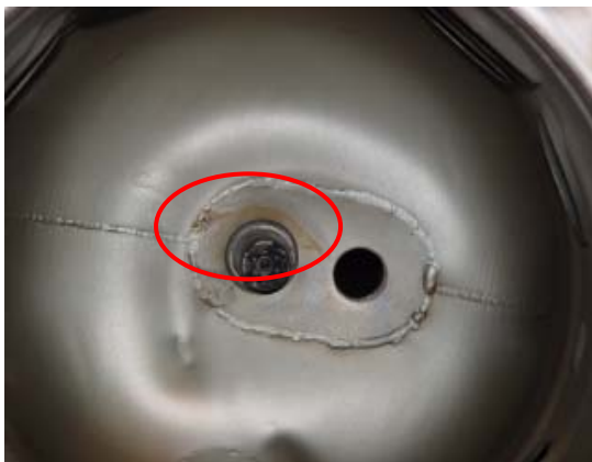
圖 1.12.1.2.2-7 噴油嘴周圍 (左) 及圖 1.12.1.2.2-8 燃燒室內側 (右) 有紅褐色斑痕
