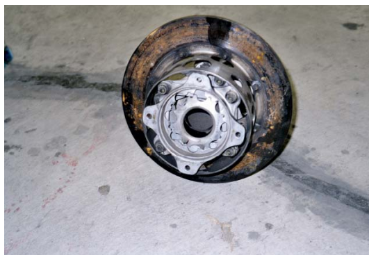
圖 1.12.1.2.3-1 主旋翼傳動箱撓性連接 軸斷裂
