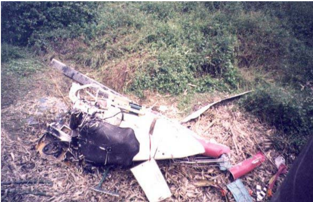
圖 1.12.1.1-6 礙掃水箱前部碎裂斷落。
