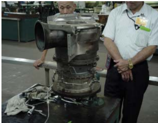
圖 1.12.1.2.2-1 發動機外形未發現任何凹陷、斷裂、變形、移位等損害
