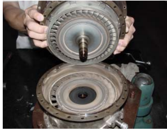
圖 1.12.1.2.2-5 (左) 圖 1.12.1.2.2-6 (右) 各級定子噴嘴與轉子葉片，未發現異常現象
