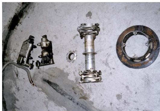
圖 1.12.1.2.3-2 主軸外觀完整
