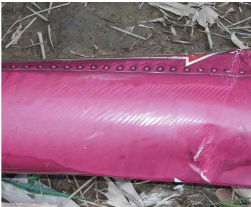
圖 1.12.1.1-10 其中一截尾桁左側下方有電纜鋼絲摩擦痕跡
