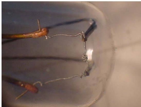
圖 1.16.2-2 發動機熄火警示燈燈芯有捲曲現象
