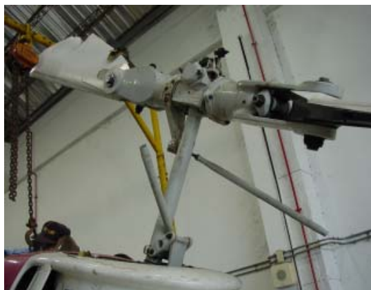
圖 1.12.1.2.5-5 變矩伺服器至旋翼頭連桿斷折
