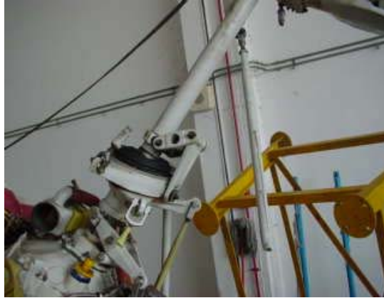
圖 1.12.1.2.5-6 滑板伺服器至主旋翼變向盤連桿斷折
