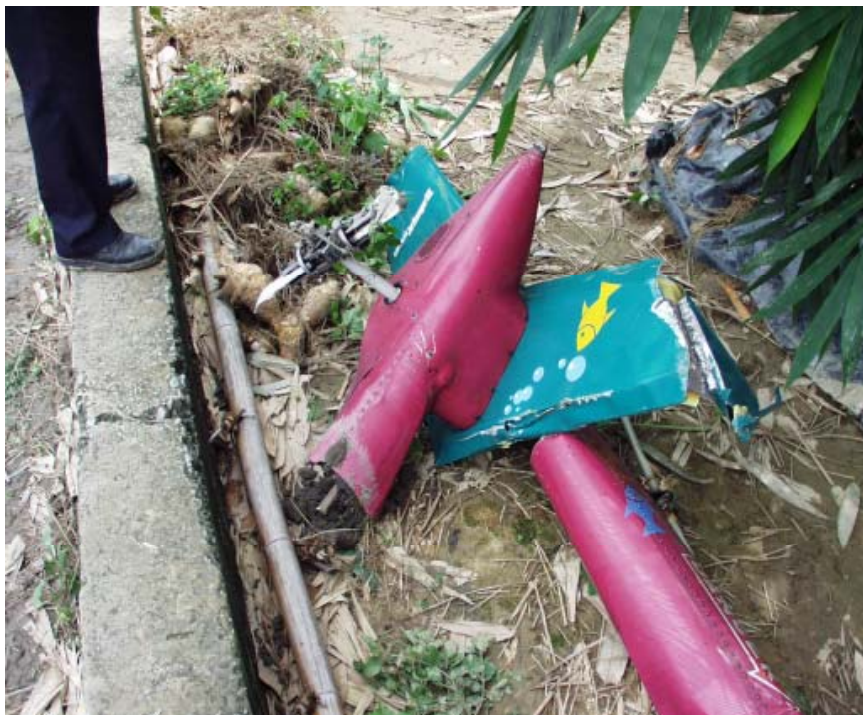
圖 1.12.1-8 下垂直尾翼根部斷裂
