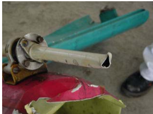
圖 1.12.1.2.3-6 斷裂面扭曲變形
