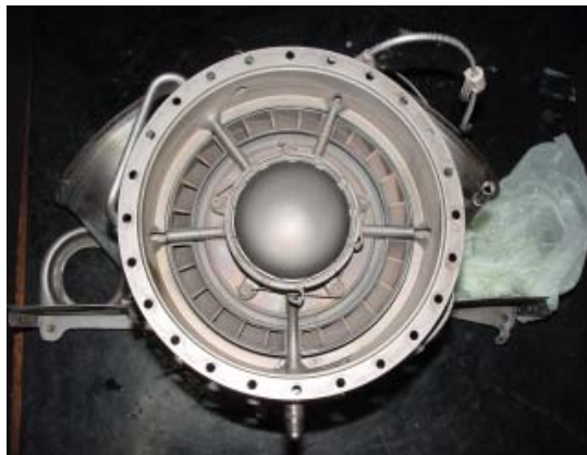
圖 1.12.1.2.2-4 定子及葉片等未發現龜裂變形或異物存留等異常現象
