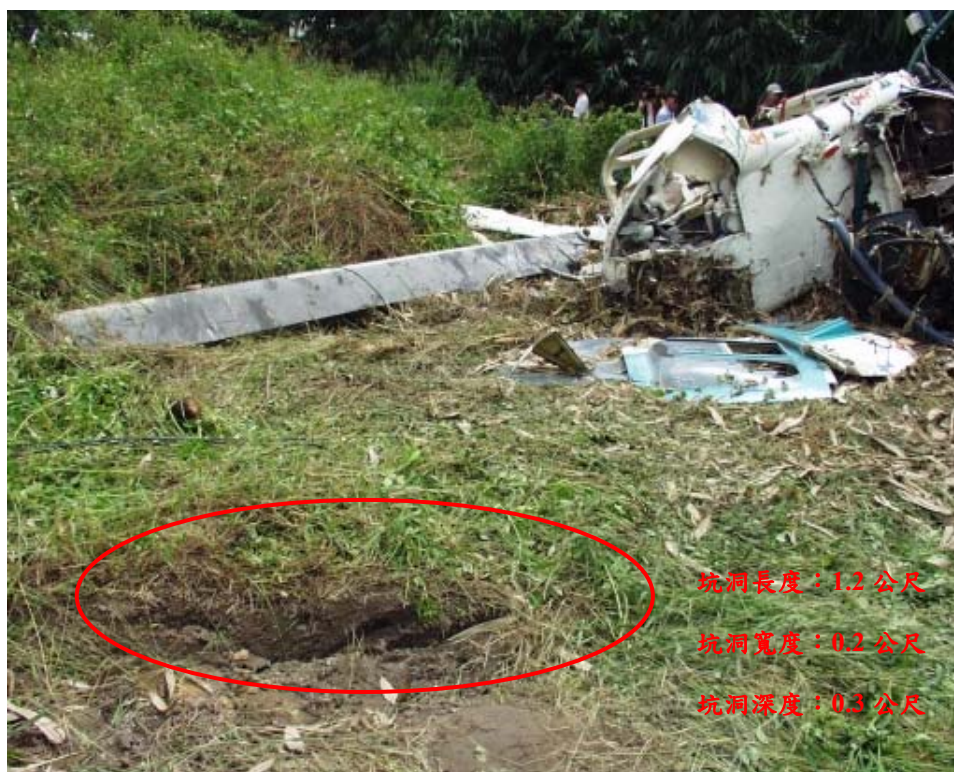
圖 1.12.2-9 主旋翼觸及地面所造成之坑洞（圈內所示）
