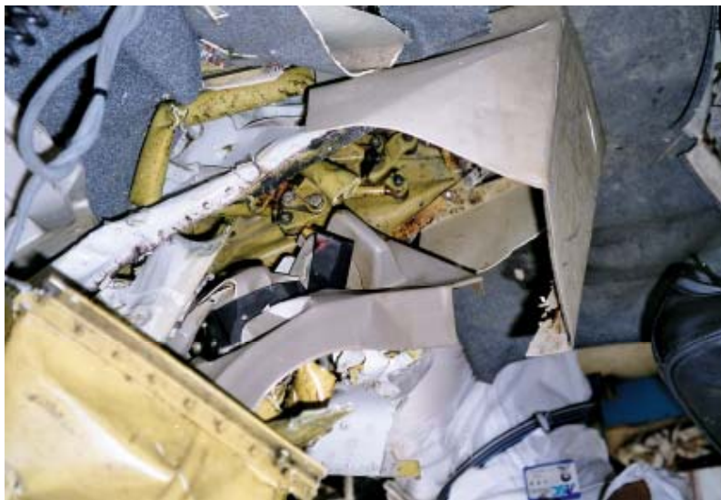
圖 1.12.1.1-2 座艙內部結構壓擠變型樑框斷裂
