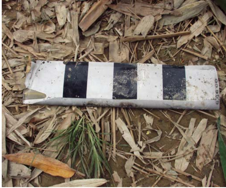
圖 1.12.1.1-7 兩片尾旋翼皆斷落，一片前緣金屬表面有黑色電擊痕跡
