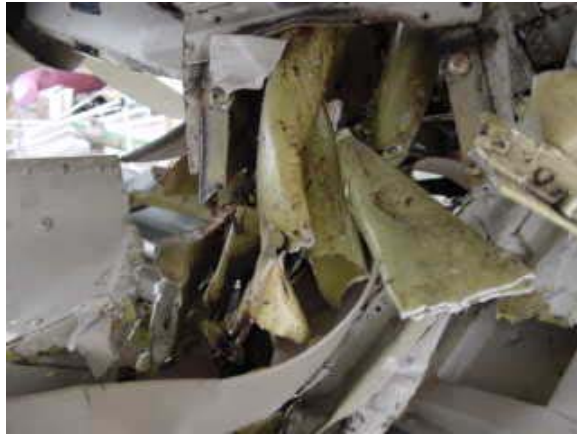
圖 1.12.1.2.5-3 操縱桿至各伺服器連桿斷折
