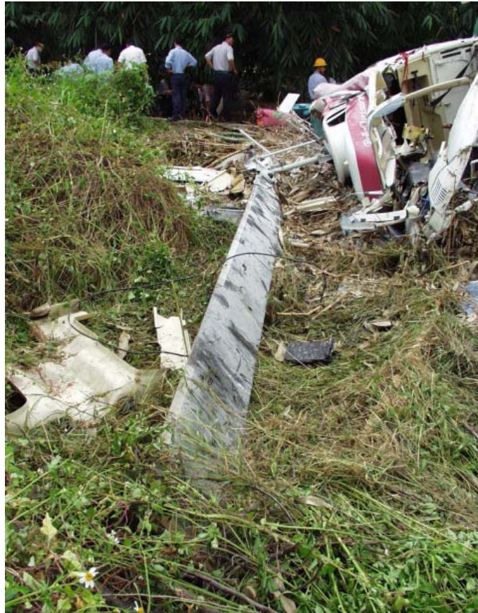
圖 1.12.1.1-5 一片主旋翼完整並與電線糾纏
