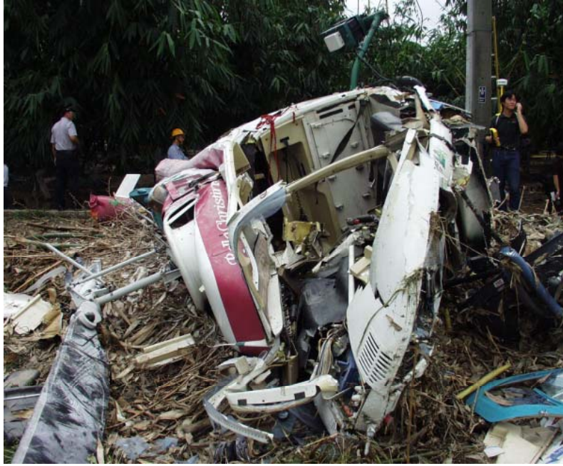
圖 1.12.1.1-1 機身地板結構向上擠壓
