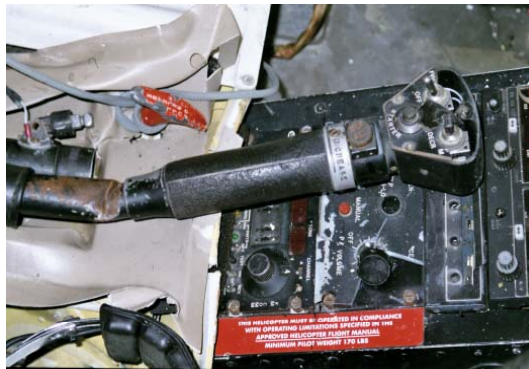
圖 1.12.1.2.5-1 油門柄置於加油位置，桿柄彎曲變形
