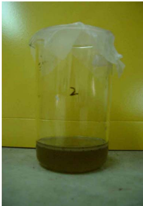
相片八、樣品(2).倒於燒杯後可明顯看出分兩層，且上層有較多泡沫
