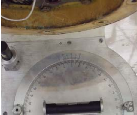
圖 1.18.1.2-4 測量前增壓泵水平
