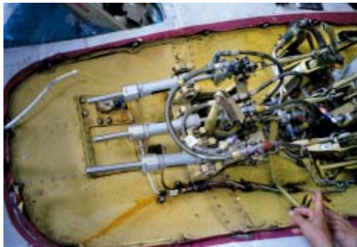
圖 1.12.1.2.5-4 各伺服器外觀完整
