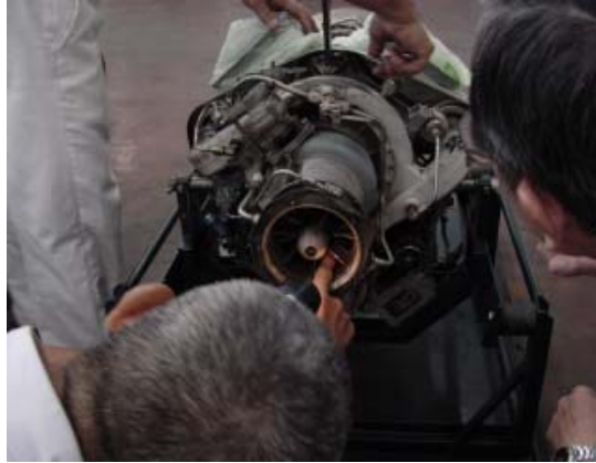
圖 1.12.1.2.2-3 以手撥發動機轉軸，未發現異常雜音及震動
