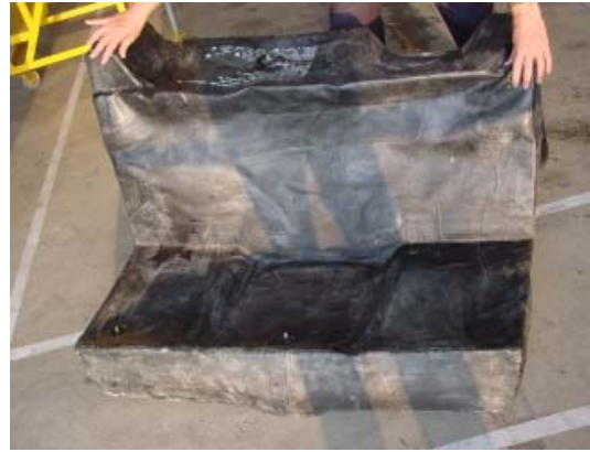
圖 1.12.1.2.6-8 油箱上方無破損
