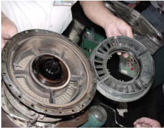
圖 1.12.1.2.2-5 (左) 圖 1.12.1.2.2-6 (右) 各級定子噴嘴與轉子葉片，未發現異常現象
