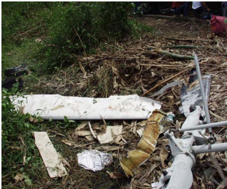
圖 1.12.1.1-4 一片主旋翼斷裂彎折
