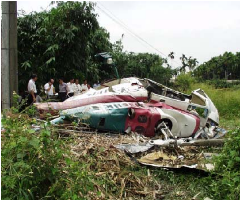
圖 1.12.1-3 失事飛機機身全毀發動機艙罩完整
