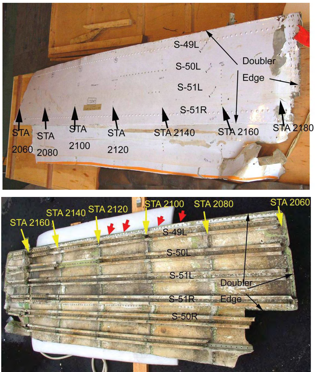
圖 1.16-1 編號 640C1 殘骸之外表面（上）與內表面（下）
