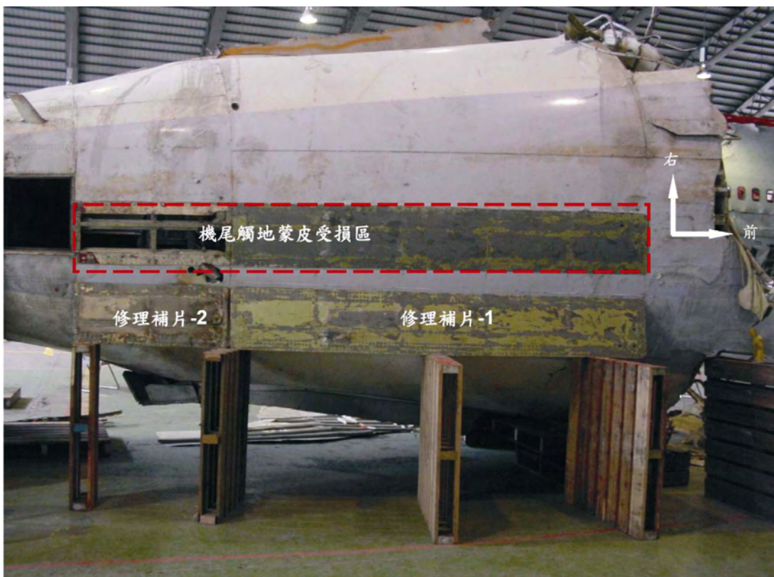
圖 1.12-13 機身 48 段之修補區域
