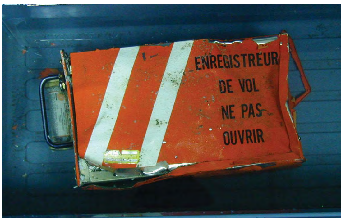
圖 1.11-1 撈起之受損座艙語音紀錄器浸於水箱內
