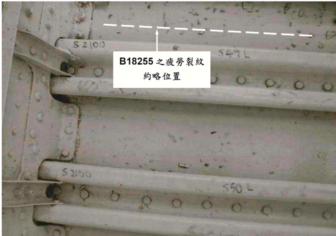
圖 1.6-12 華航 B747-200 貨機散貨艙底防銹劑及污垢清除後情形
