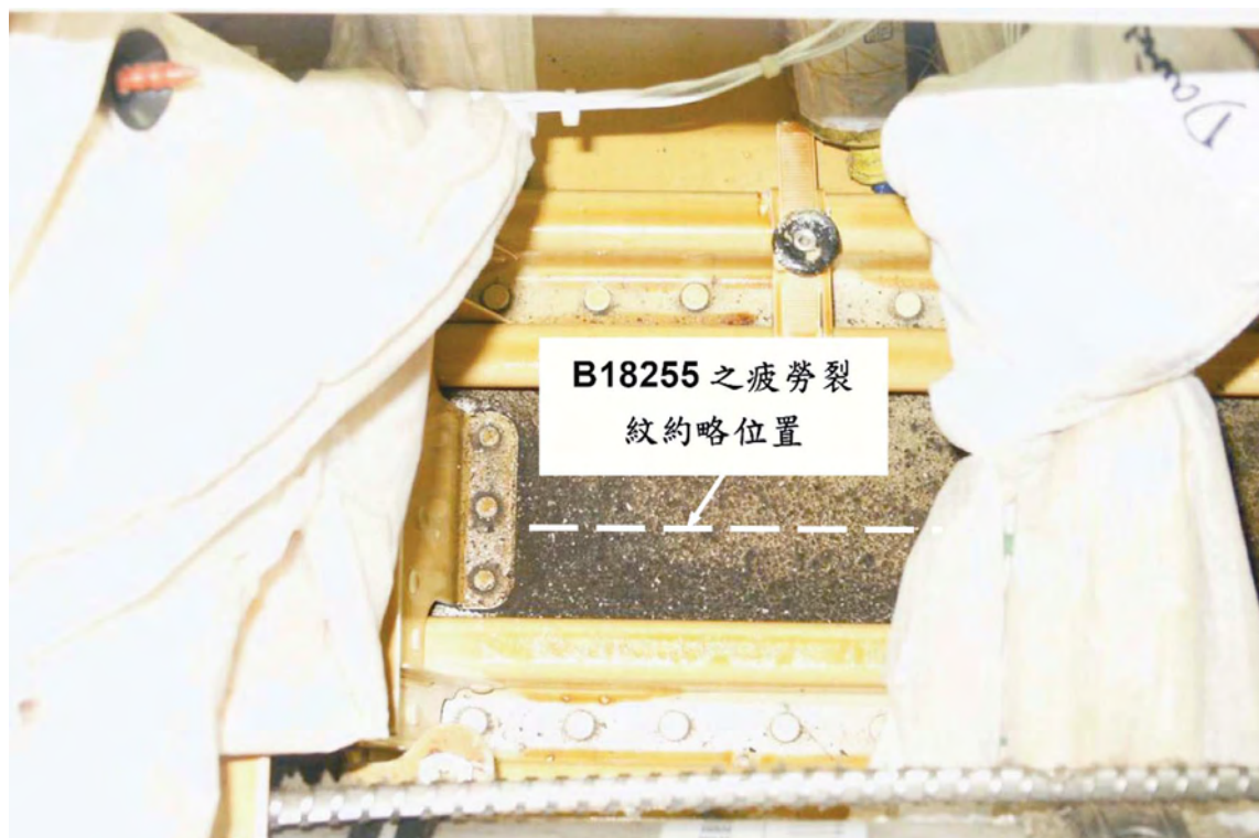
圖 1.6-13 華航 B747-400 散貨艙底防銹劑及污垢清除前情形
