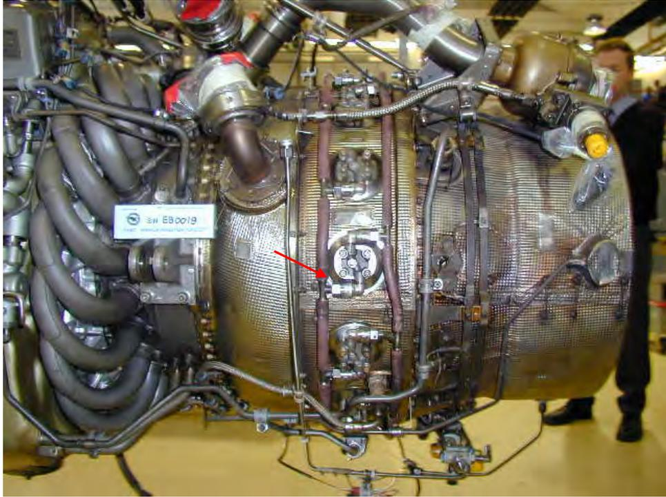
圖 A3-4 拆解作業前之發動機左側（箭頭所指為 11 號燃油噴嘴位置）
