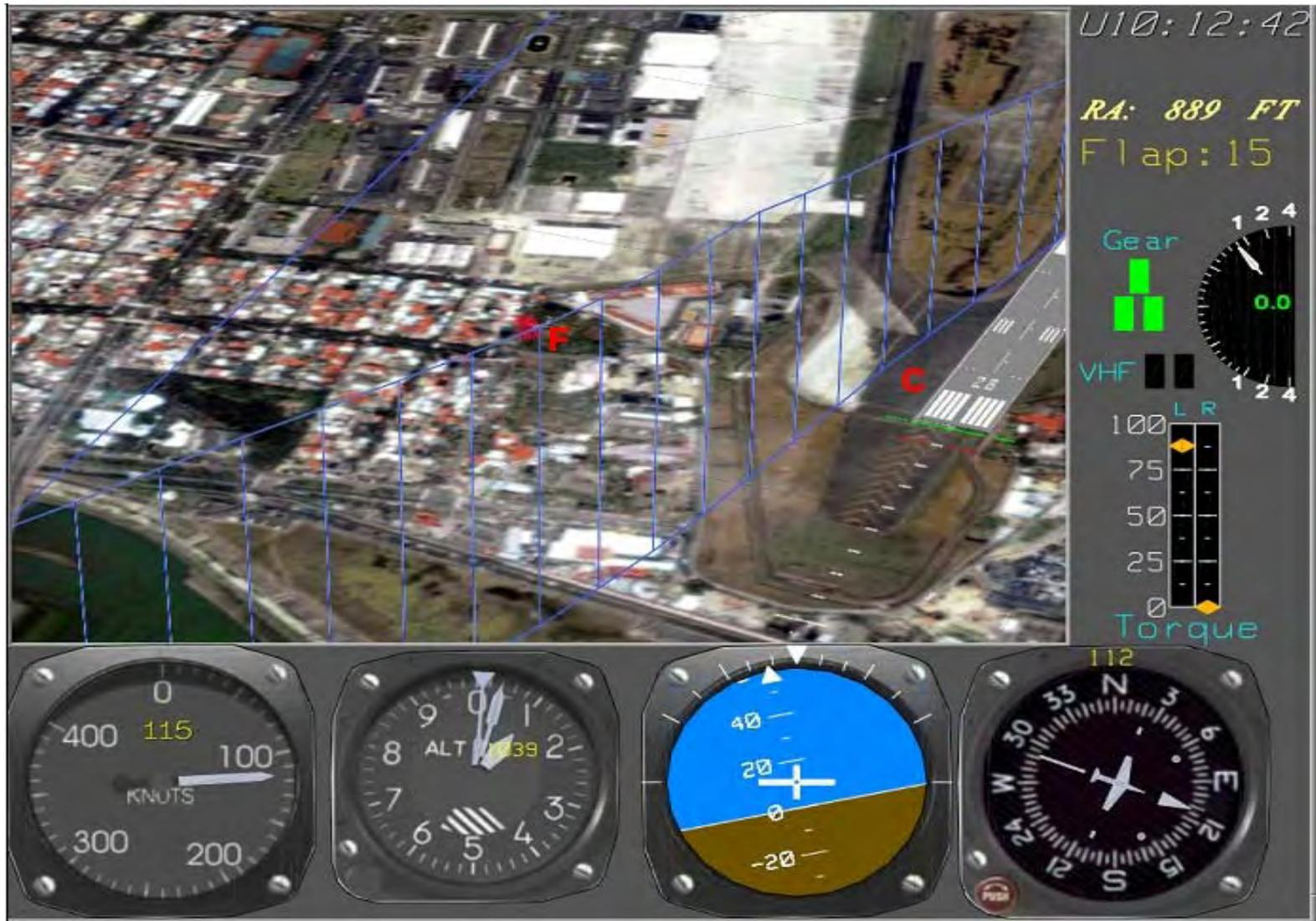
圖 1.11-5 右發動機失去扭力後 20 秒之飛航軌跡與空照圖
