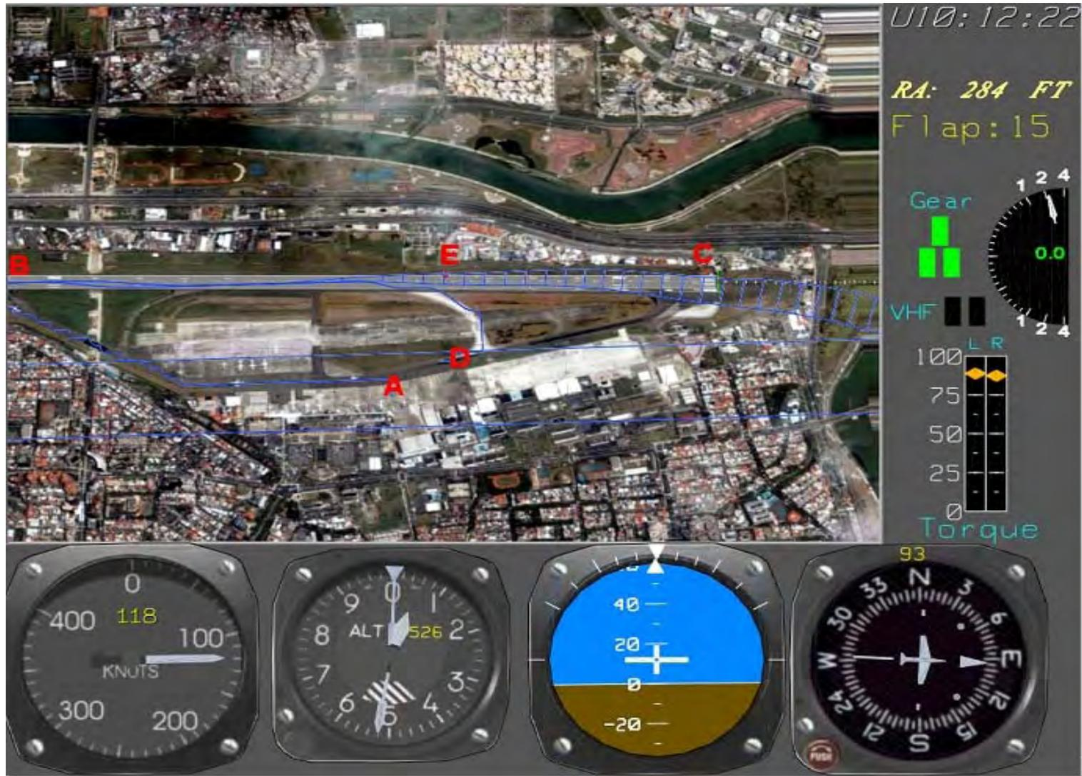
圖 1.11-3 GPS 飛航軌跡與空照圖套疊
