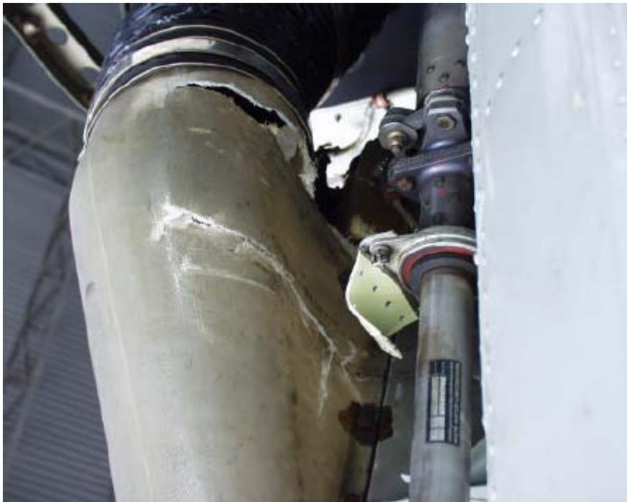
圖 1.12-5 尾旋翼傳動軸受損情形（一）
