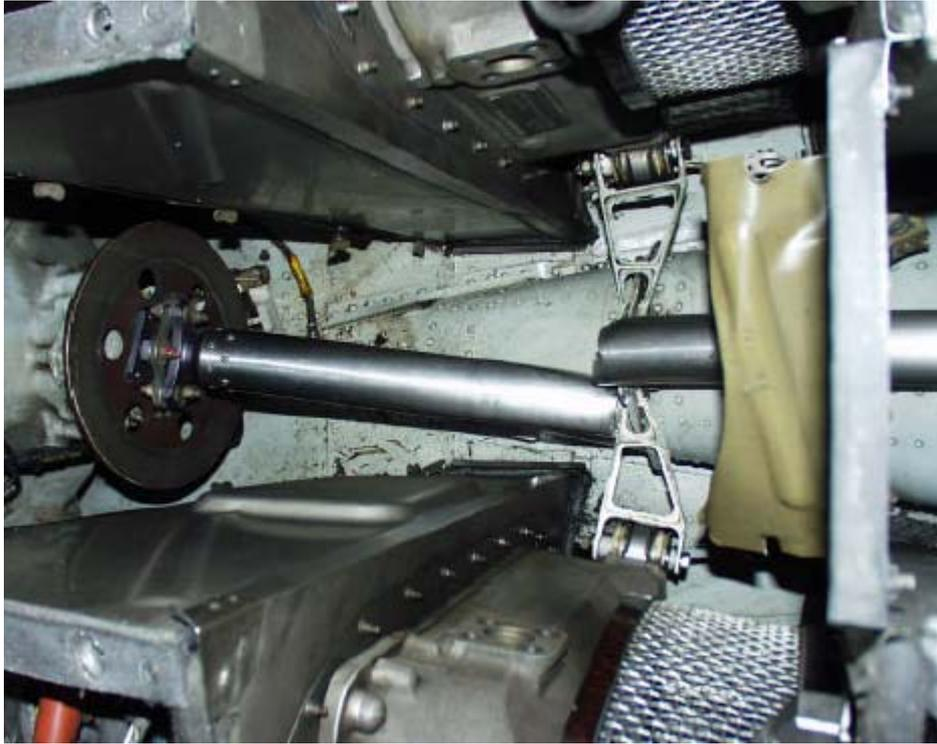
圖 1.12-4 尾旋翼傳動軸短軸防火牆區域受損情形
