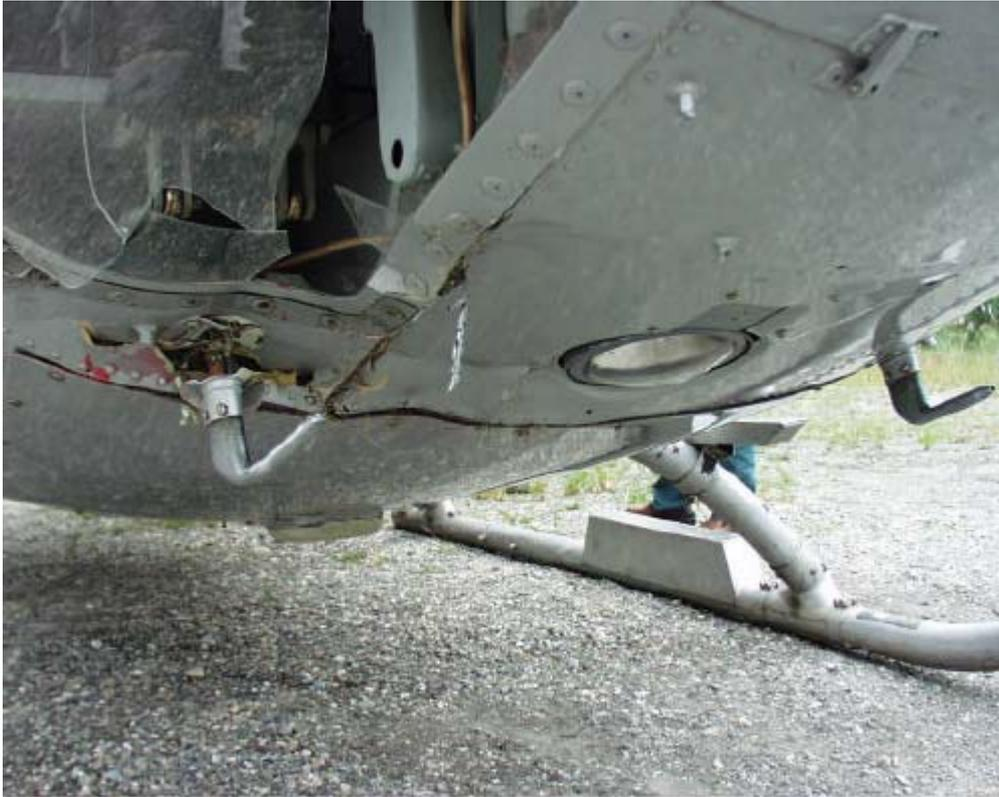
圖 1.12-1 機首右側下方損壞圖
