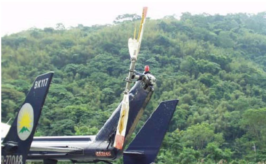
圖 1.12-7 尾旋翼損壞情形
