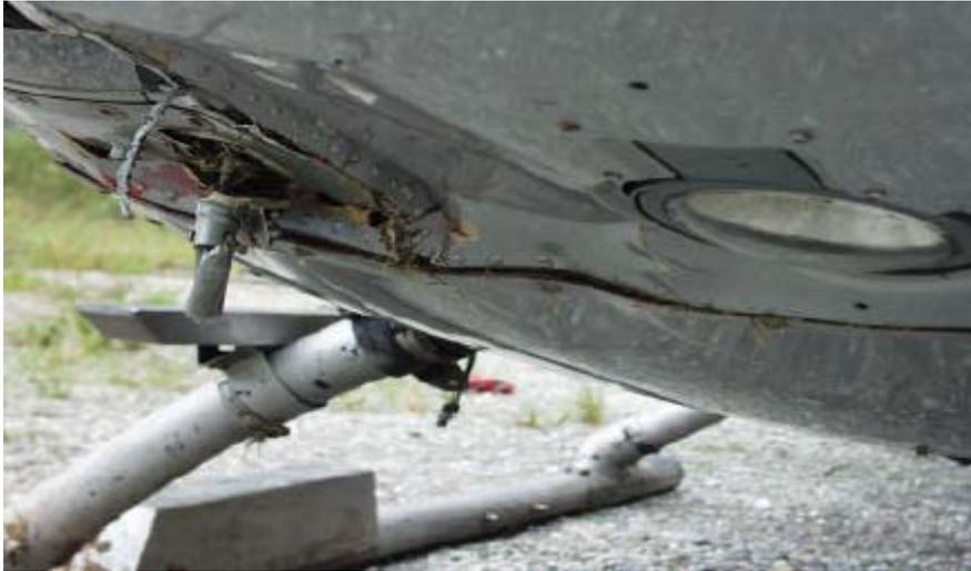
圖 1.12-3 落地燈附近損壞情形
