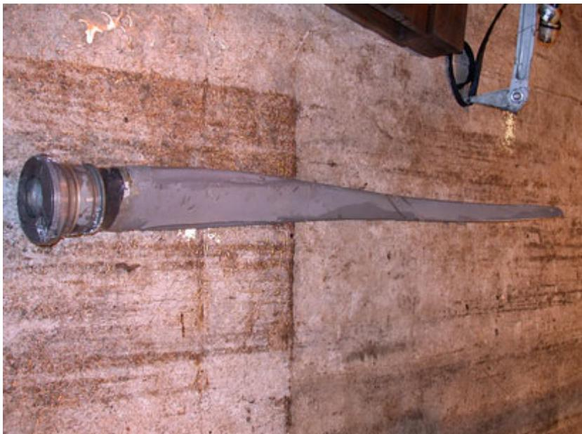
圖 1.12-24 發動機螺旋槳葉
