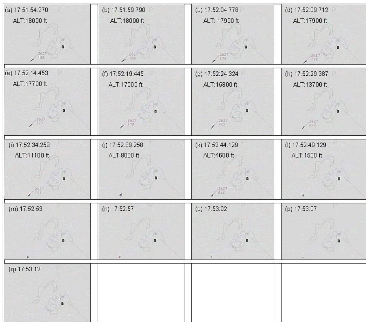
圖 1.18-5 台北區域管制中心 ATCAS 紀錄之初級及次級雷達訊號
