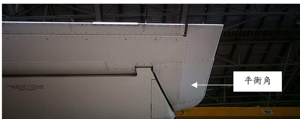
圖 1.6-8 ATR 72 副翼平衡角板
