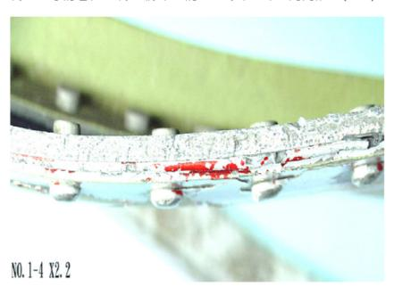
圖 5. 客艙窗戶結構破損件編號 1-4 端斷面的巨觀觀察。(2.2X)
