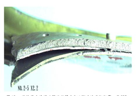
圖 13. 客艙窗戶結構破損件編號 2-5 端斷面的巨觀觀察。(2.2X)
