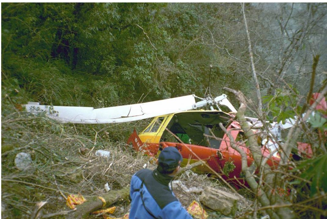
圖 1.12-4 主旋翼變形破損
