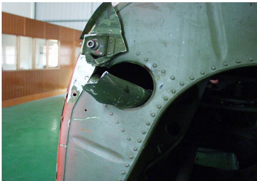
圖 1.12-2 機身與尾桁接合隔框破裂
