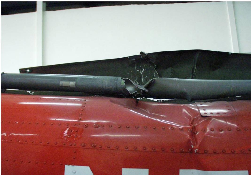
圖 1.12-3 尾桁傳動軸中段呈 45 度破裂
