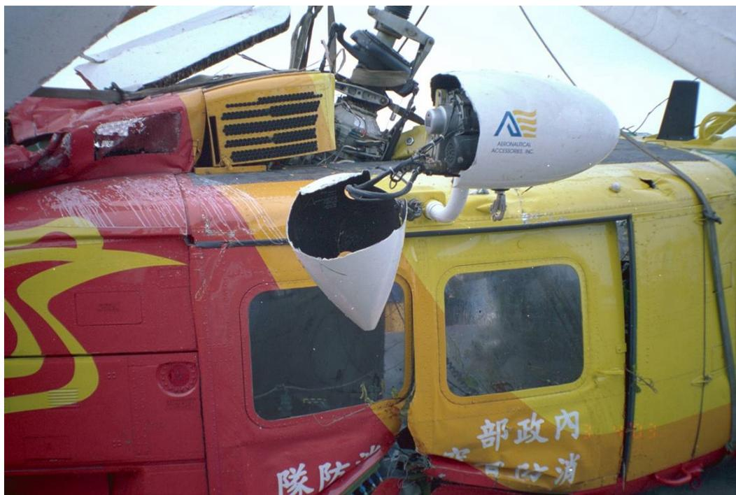
圖 1.12-5 主旋翼傳動軸變形
