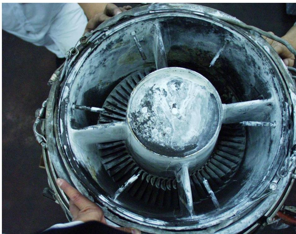
圖 1.12-10 尾管探溫頭及末級渦輪轉子葉片情況
