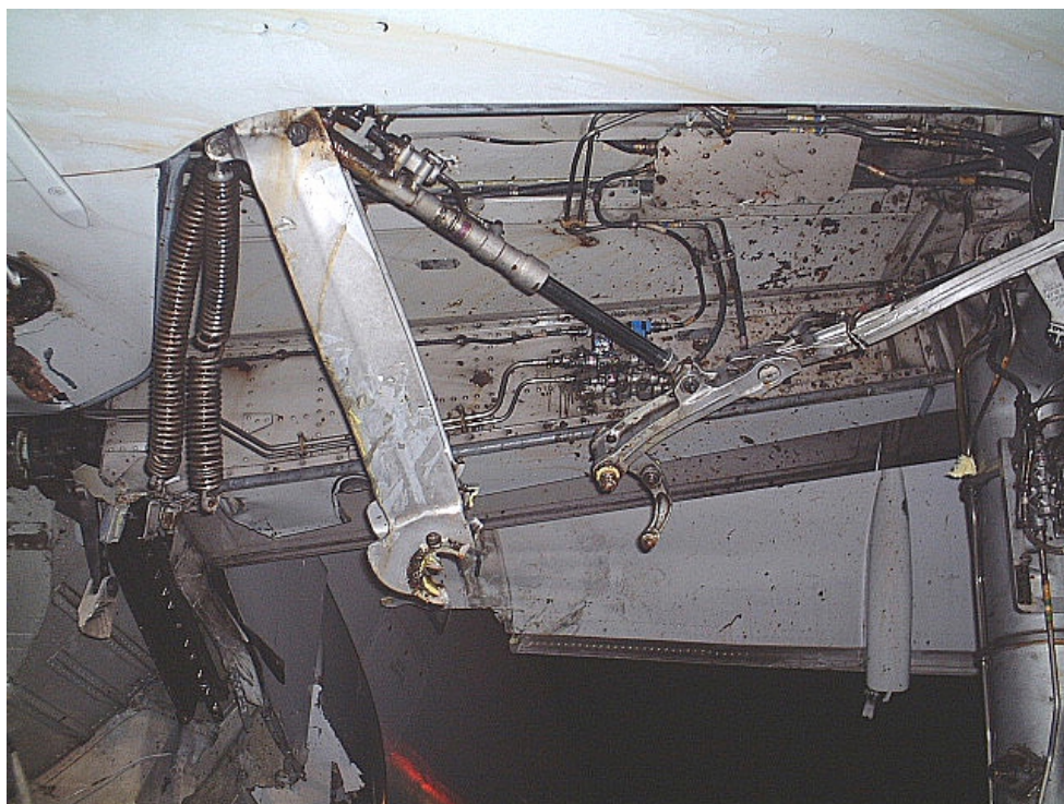
圖 1.3-5 左起落架側撐架組合併總成斷裂
