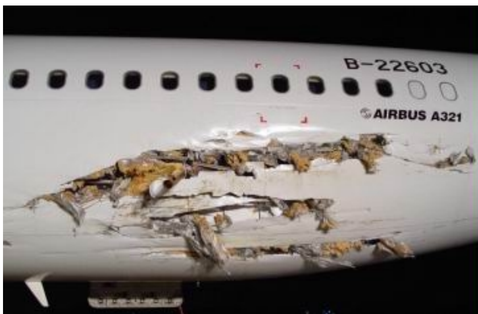
圖 1.3-7 後方機身蒙皮撕裂延伸至左邊 4 號門前
