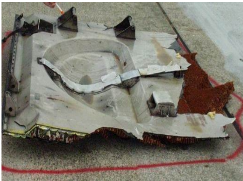
圖 1.3-4 左起落架艙門掉落
