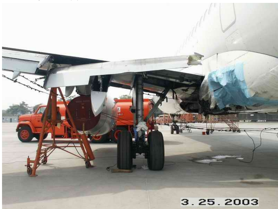
圖 1.3-6 左內側襟翼損壞情形
