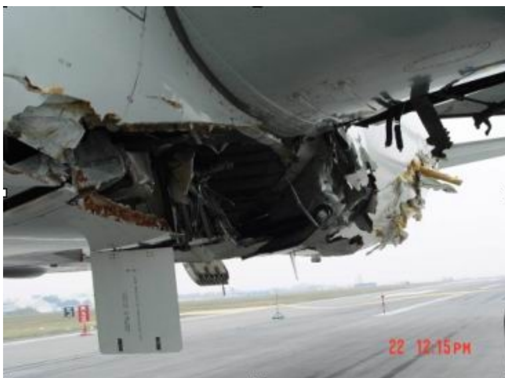
圖 1.3-2 機身左側一號空調系統進氣口損傷
