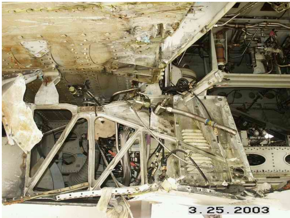
圖 1.3-3 中油箱左下方之翼箱擦傷
