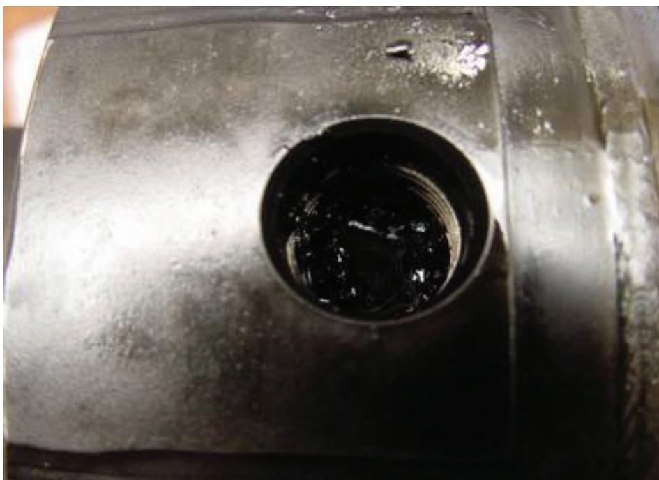
圖 10 五、六號軸承室滑油進口濾網處有油泥堆積
