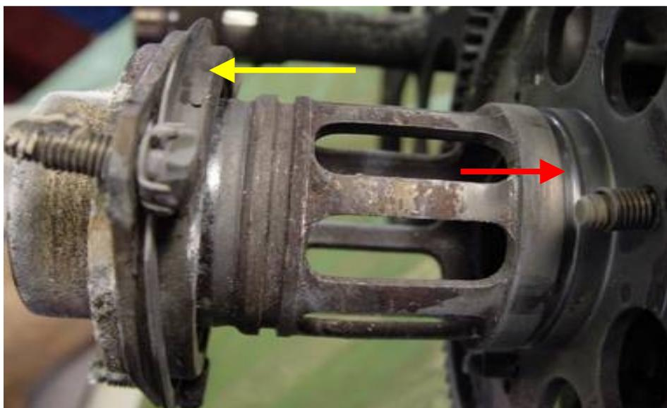
圖 16 油氣分離葉輪前端軸承（黃箭指處）拆解前，其軸封橡圈座槽（紅箭指處）光滑潔淨。
