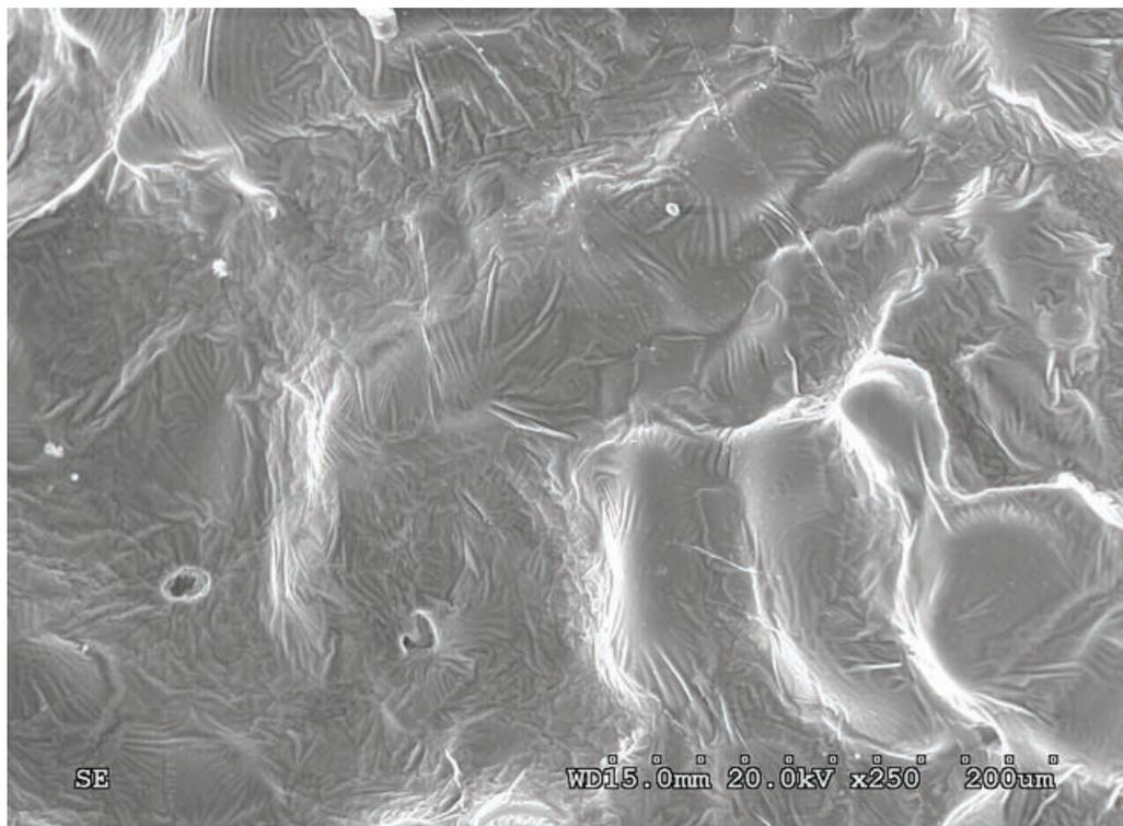
圖 11 SEM 金相檢驗油氣分離葉輪金色斷面
