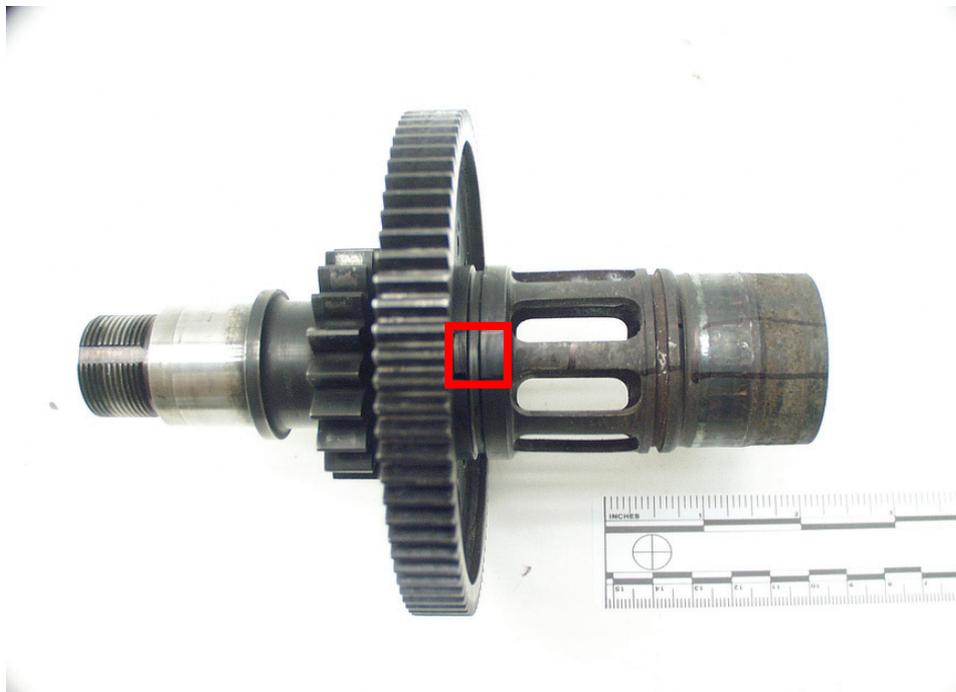
圖 28 葉輪軸前段（後）金相檢驗
