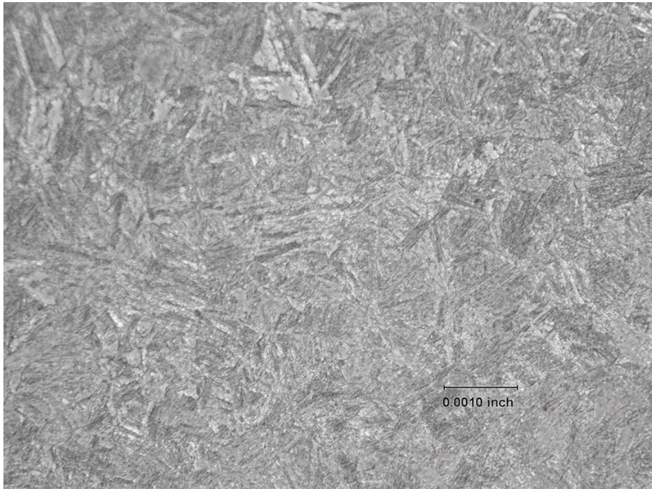
圖 27 葉輪軸前段（中）金相檢驗 38 HRC
