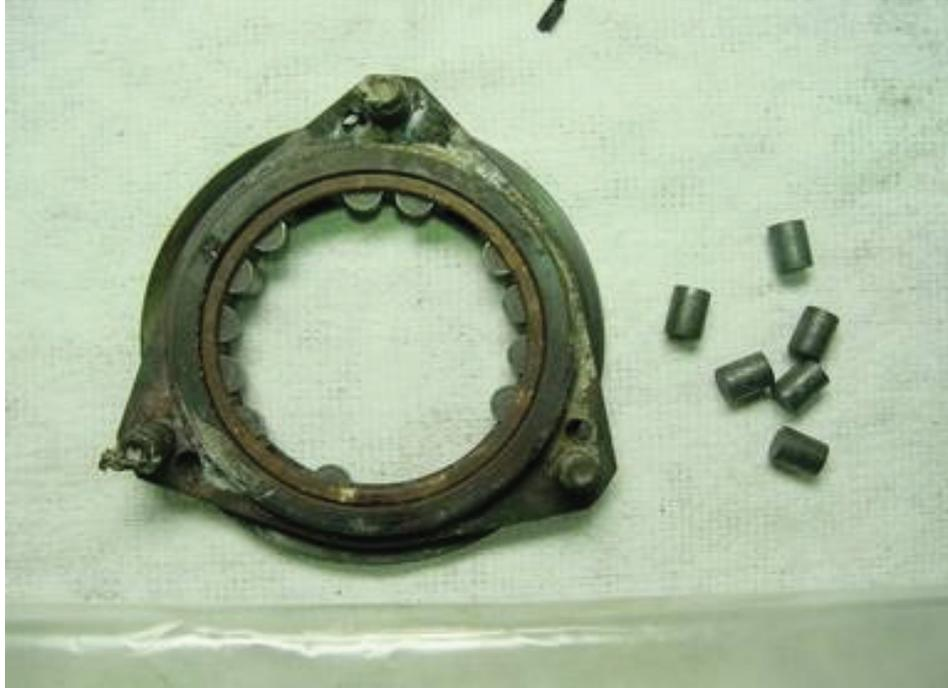
圖 19 油氣分離葉輪前端軸承拆解後，其軸承滾柱兩端磨損，滾柱呈凸型。
