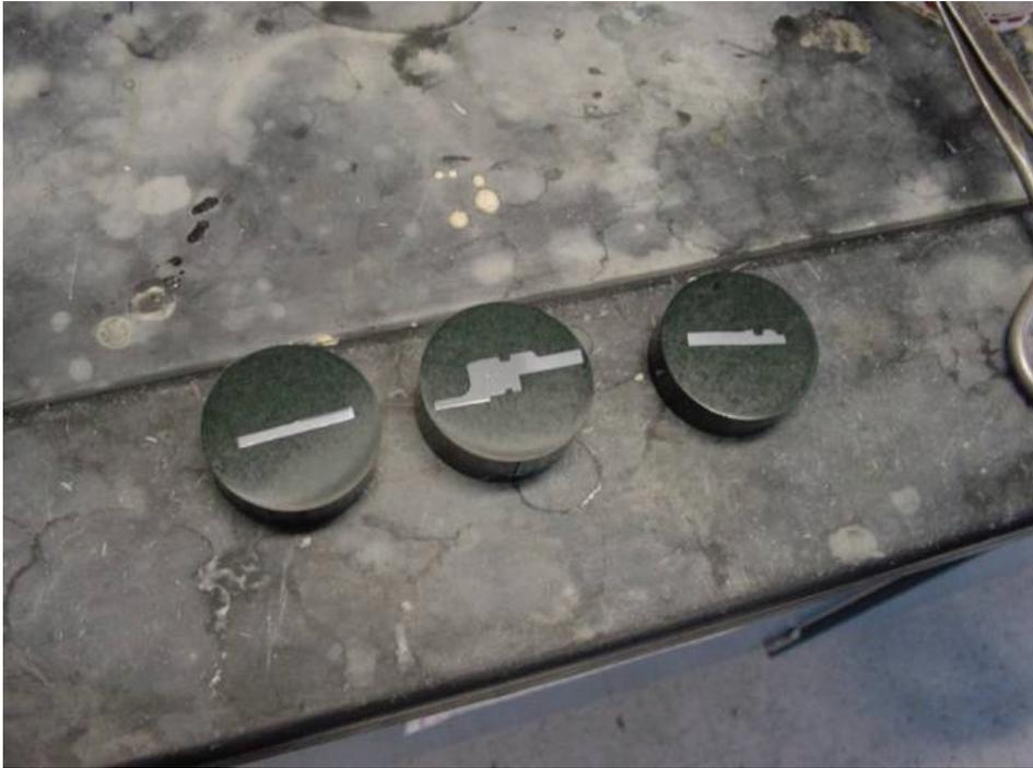
圖 22 取樣#25 前軸承外環及滾柱
