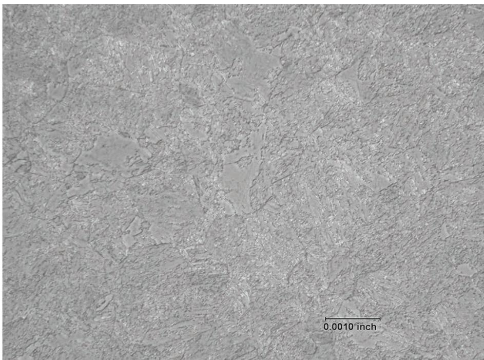
圖 25 葉輪軸前段（前）金相檢驗 28 HRC
