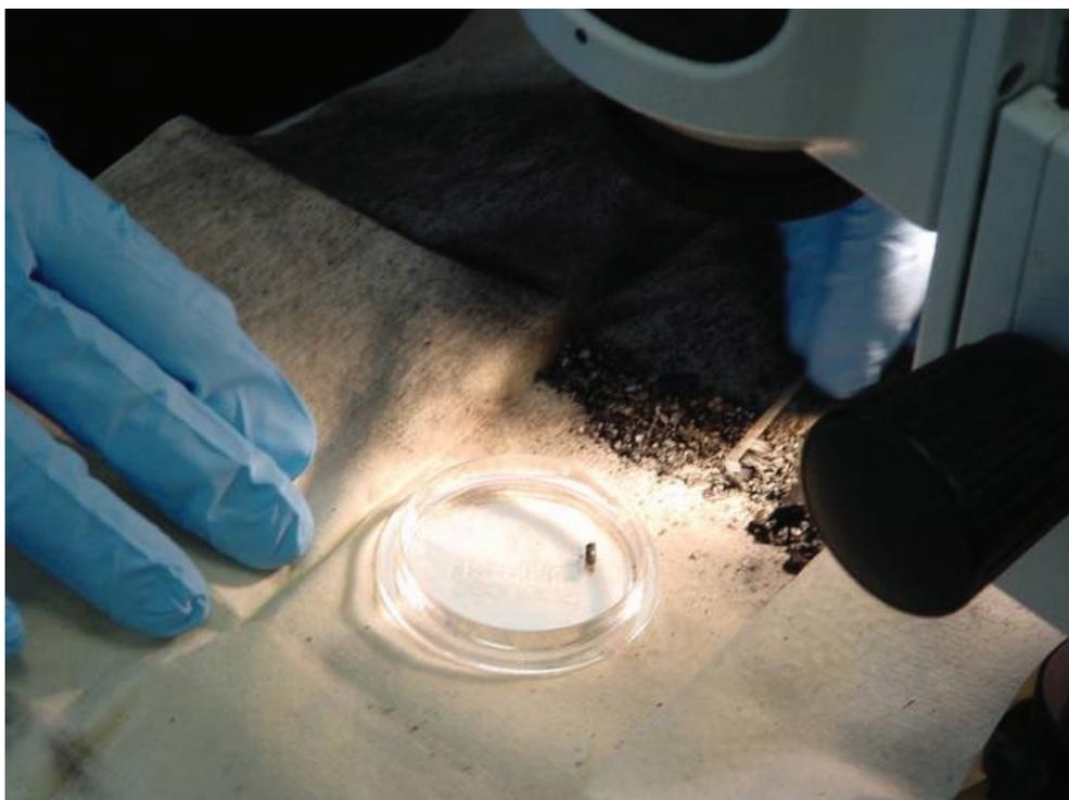
圖 5 微觀搜尋葉輪軸膠封 (b)
