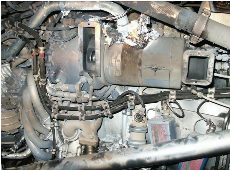
圖 1.2-1 直流起動發電機線束保護套燒毀
