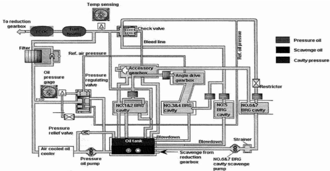
圖 1.9-1 PWC127 發動機滑油系統示意圖
