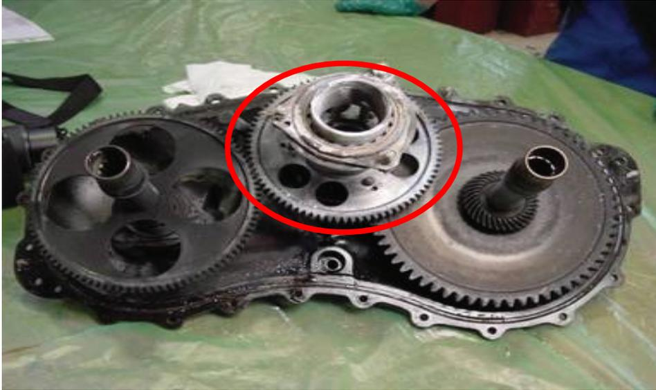
圖 13 減速齒輪箱後方機匣分解後內部齒輪及油氣分離葉輪失蹤情形（紅圈處為油氣分離葉輪原來位置）
