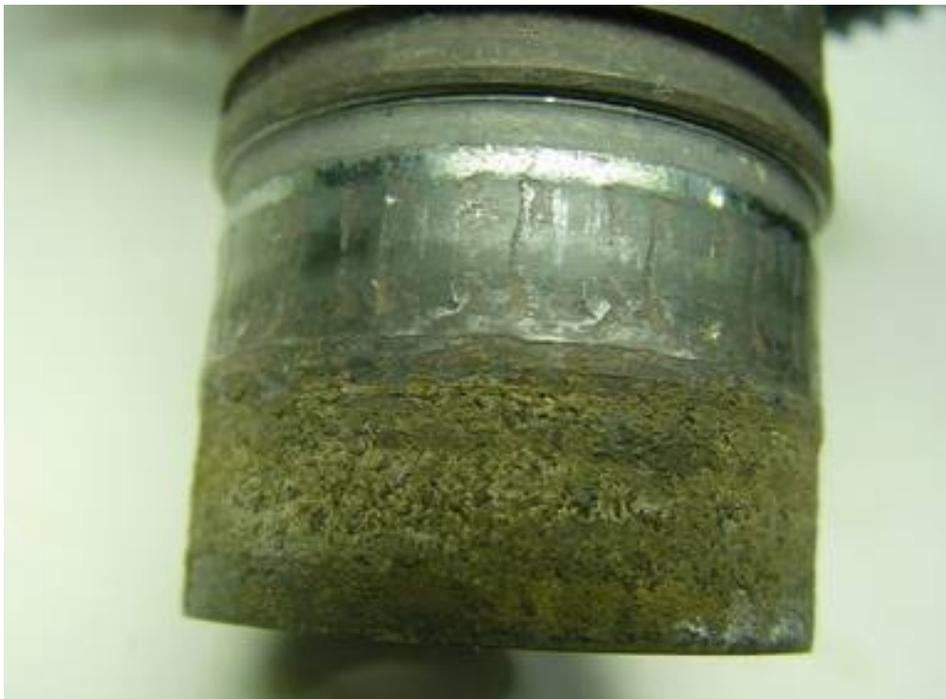
圖 18 油氣分離葉輪前端軸承處之轉軸有凹陷痕跡
