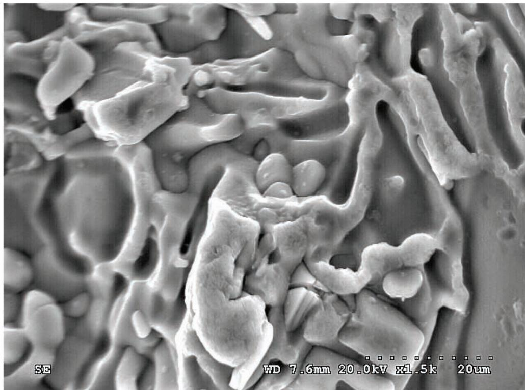
圖 10 SEM 金相檢驗油氣分離葉輪白色斷面
