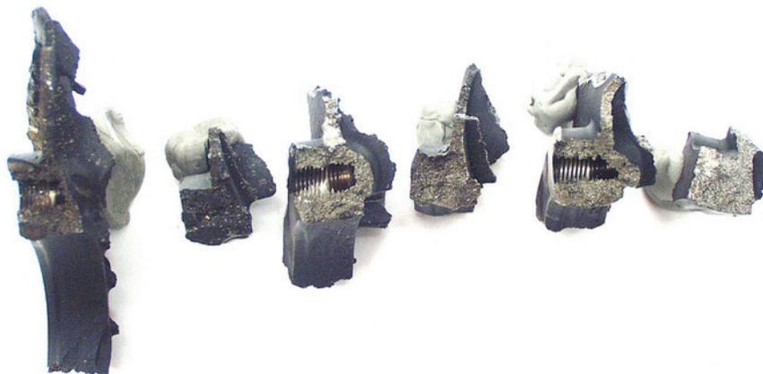
圖 3 微觀檢驗油氣分離葉輪斷裂面 (c)
