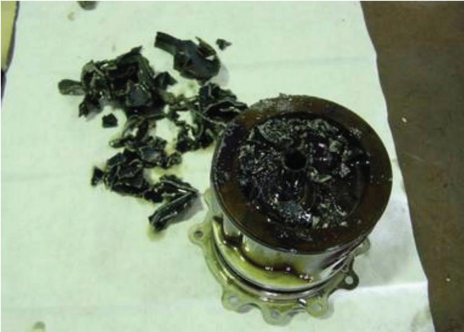
圖 6 由發動機拆下之滑油葉輪進口亦有逸氣葉輪輪解體碎片
