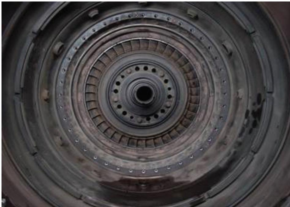
圖 7 發動機熱段轉子與定子葉片皆正常
