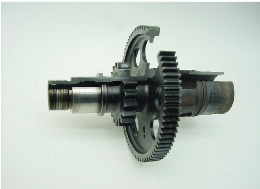
圖 33 取樣油氣分離葉輪軸後段、X 射線螢光元素成分分析、SEM 物理特性檢驗、硬度測試
