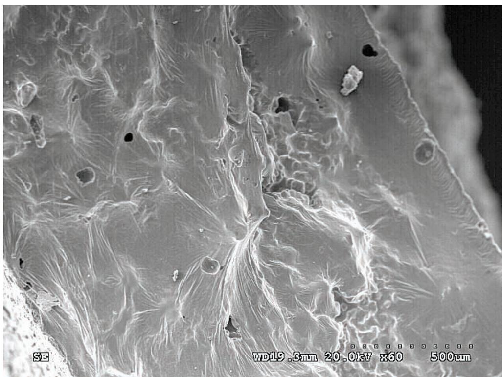
圖 12 SEM 金相檢驗油氣分離葉輪藍色斷面
