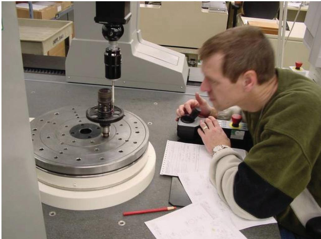
圖 21 量測葉輪軸直徑
