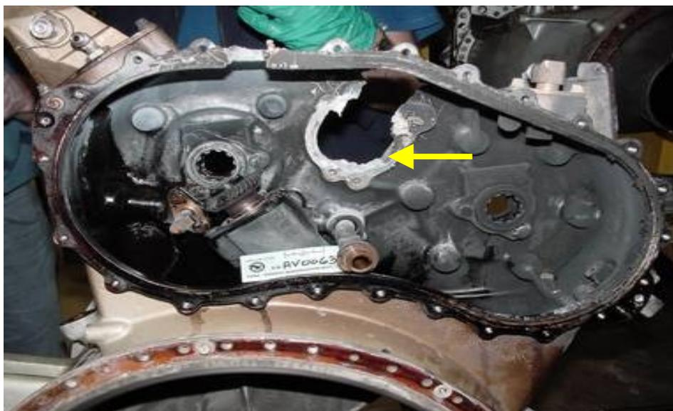
圖 15 附件齒輪箱匣前方機匣內部皆呈黑色碳化物附著現象，油氣分離葉輪軸承處無黑色碳化物附著現象（黃箭處），有轉動摩擦痕跡。
