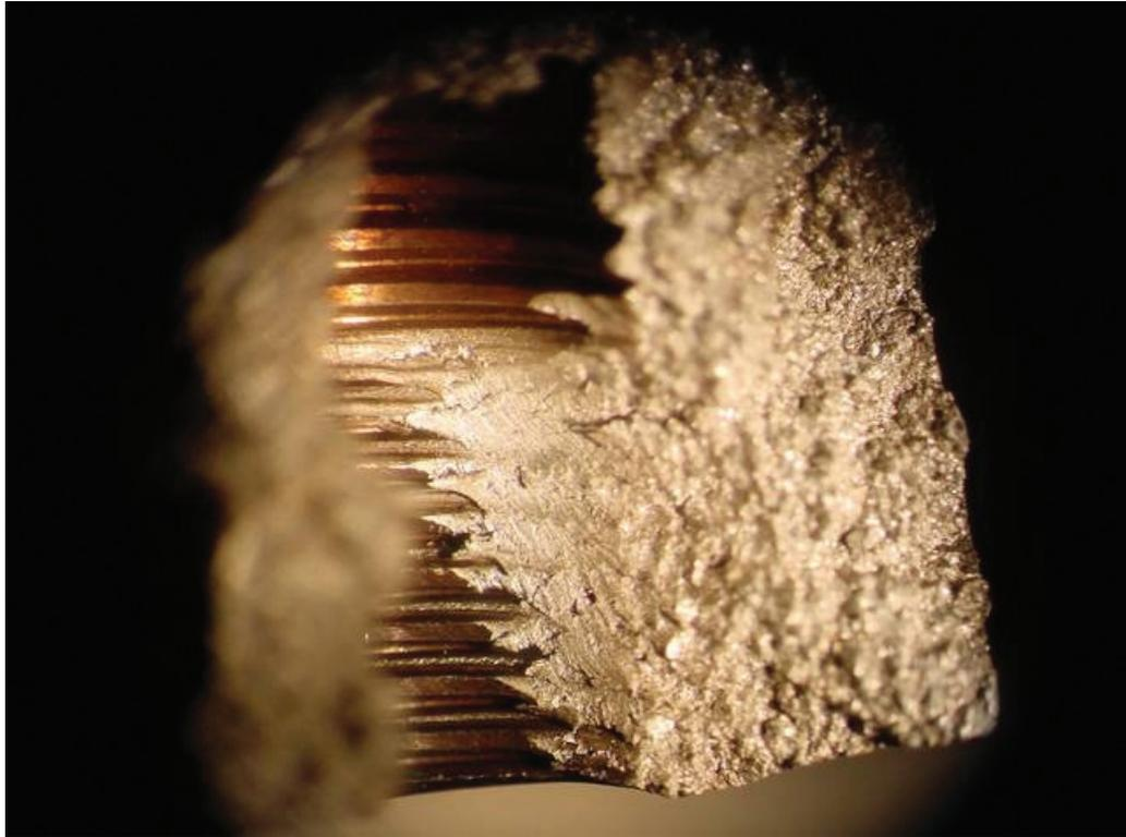
圖 20 檢視油氣分離葉輪固定栓內牙
