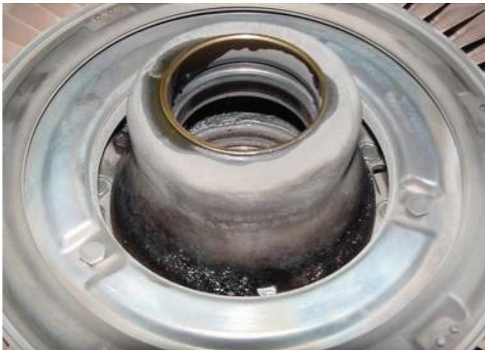
圖 9 五、六號軸承室外有油垢堆積現象
