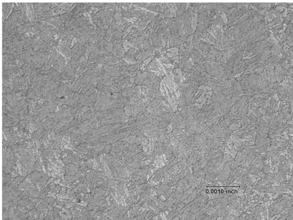
圖 29 葉輪軸前段（後）金相檢驗 24 HRC
