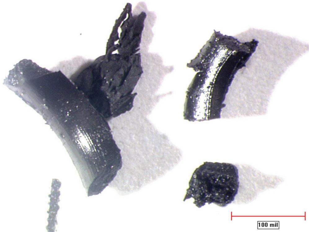
圖 6 微觀搜尋葉輪軸膠封 (c)
