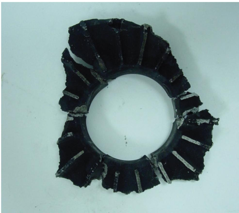
圖 1 微觀檢驗油氣分離葉輪斷裂面 (a)
