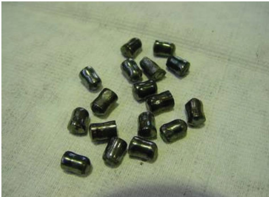
圖 11 六號軸承滾軸中心有磨損，滾軸呈凹型，無粗造摩擦及高溫熔融現象。
