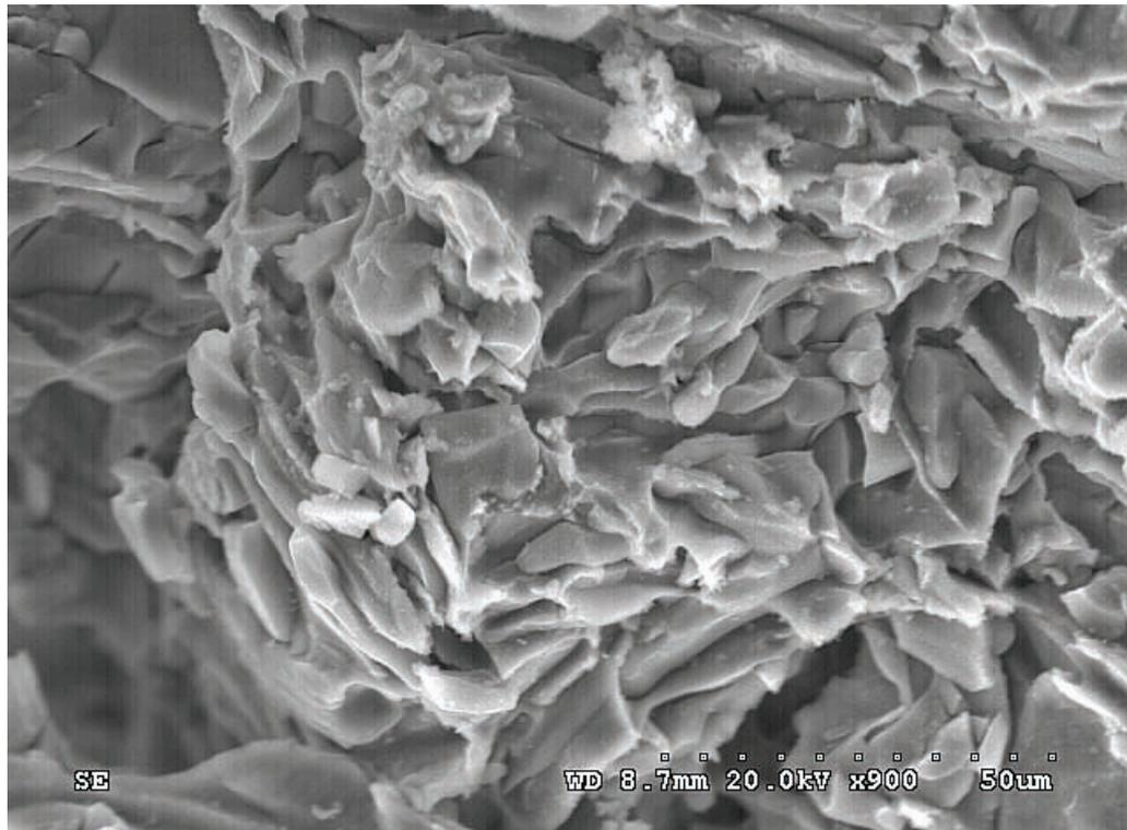
圖 13 SEM 金相檢驗油氣分離葉輪黑色斷面
