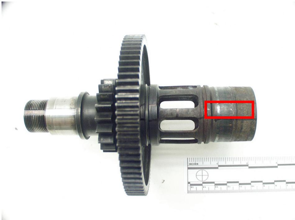
圖 24 葉輪軸前段（前）金相檢驗
