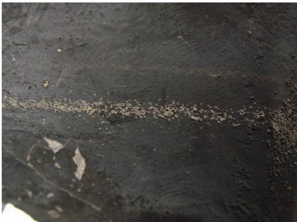
圖 2.3-6 離心力甩出附著於附件齒輪箱匣內壁之葉輪溶解金屬顆粒
