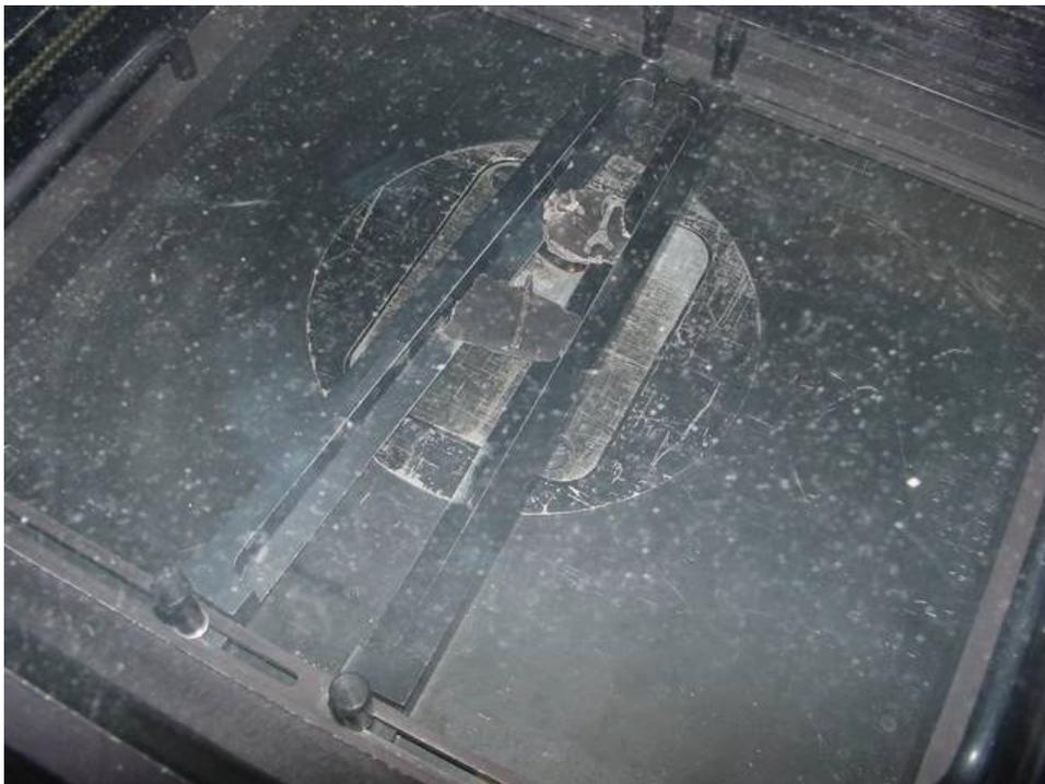
圖 8 油氣分離葉輪 X 射線螢光元素成分分析
