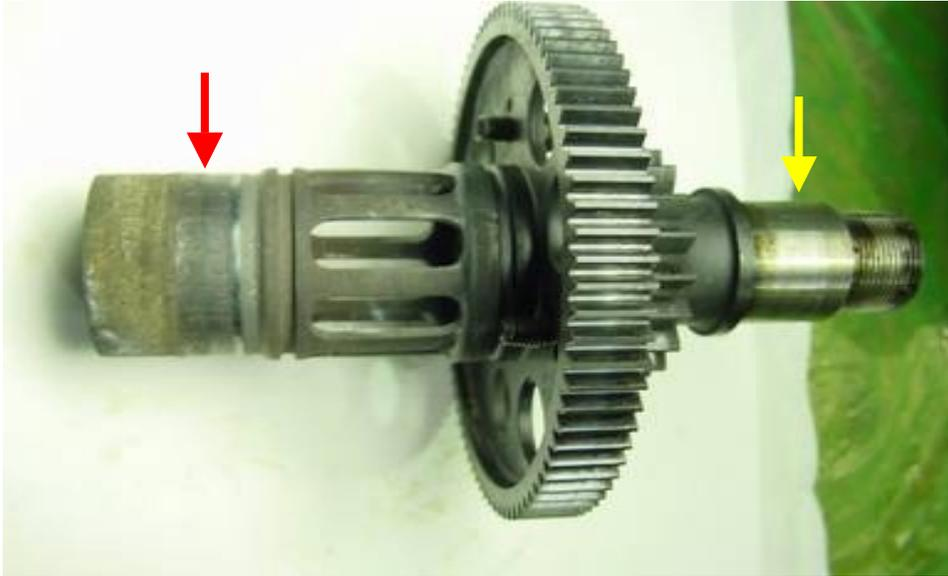
圖 17 油氣分離葉輪前端軸承拆解後，其軸承處之轉軸（紅箭指處）有凹陷痕跡，後端軸承處之轉軸光滑正常（黃箭指處）
