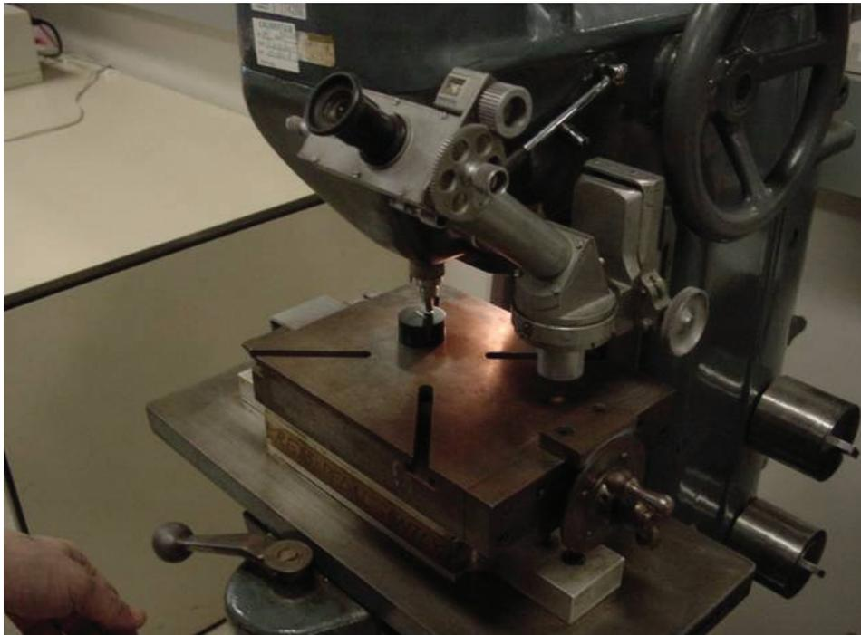
圖 23 油氣分離葉輪軸前段、實施 X 射線螢光元素成分分析、SEM 物理特性檢驗、硬度測試
