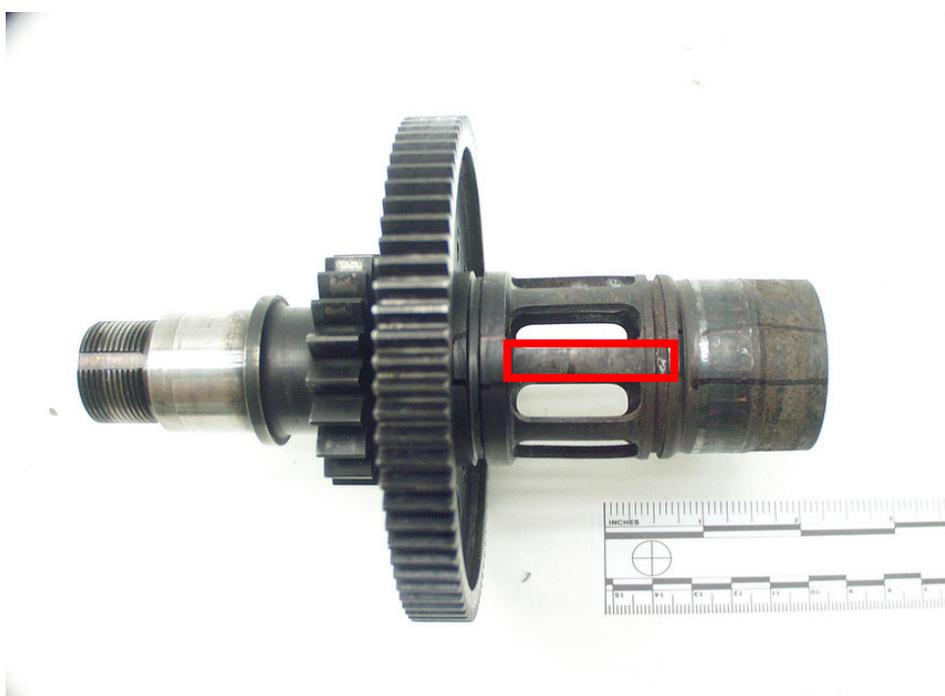
圖 26 葉輪軸前段（中）金相檢驗
