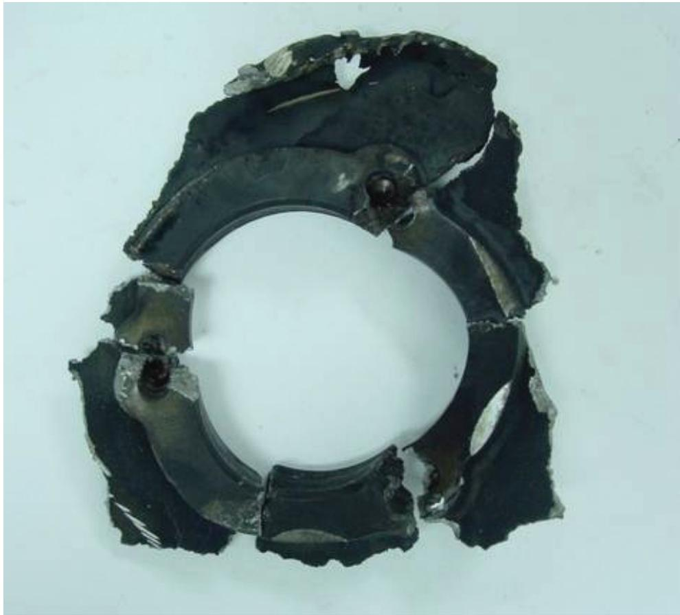
圖 2 微觀檢驗油氣分離葉輪斷裂面 (b)
