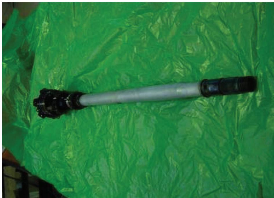
圖 8 發動機轉子及其七只軸承除六號軸承外皆正常
