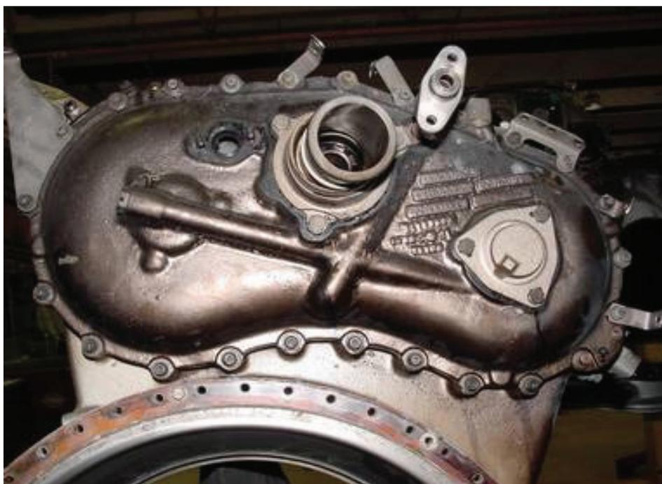
圖 12 減速齒輪箱後方機匣外部銀色塗料變成深褐色
