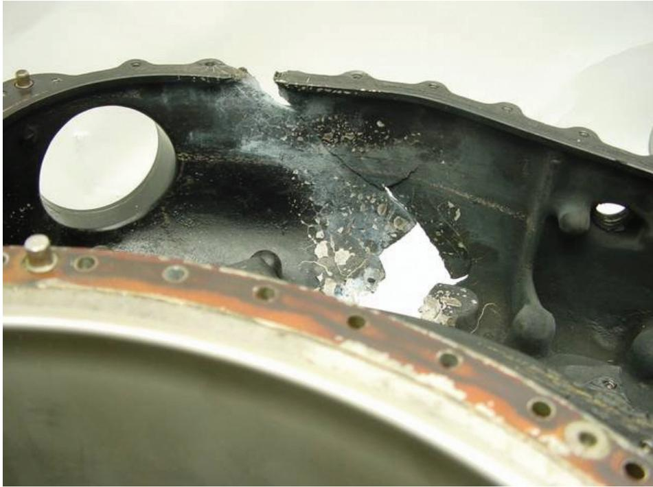
圖 31 附件齒輪箱匣內白色線形物質取樣 SEM 物理特性檢驗
