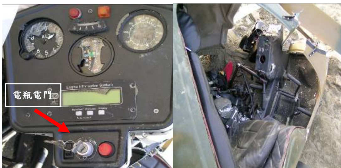
圖 1.3-4 駕駛艙損壞情形
