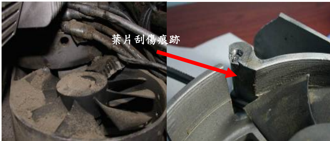
圖 1.4-2 冷卻風扇損壞情形
