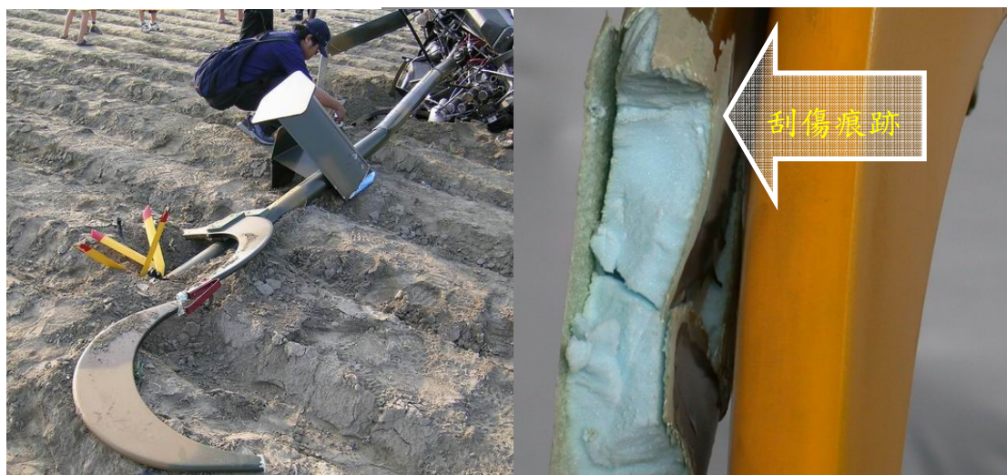
圖 1.3-6 尾桁及尾翼損壞情形（左圖）、強化泡棉刮傷痕跡（右圖）
