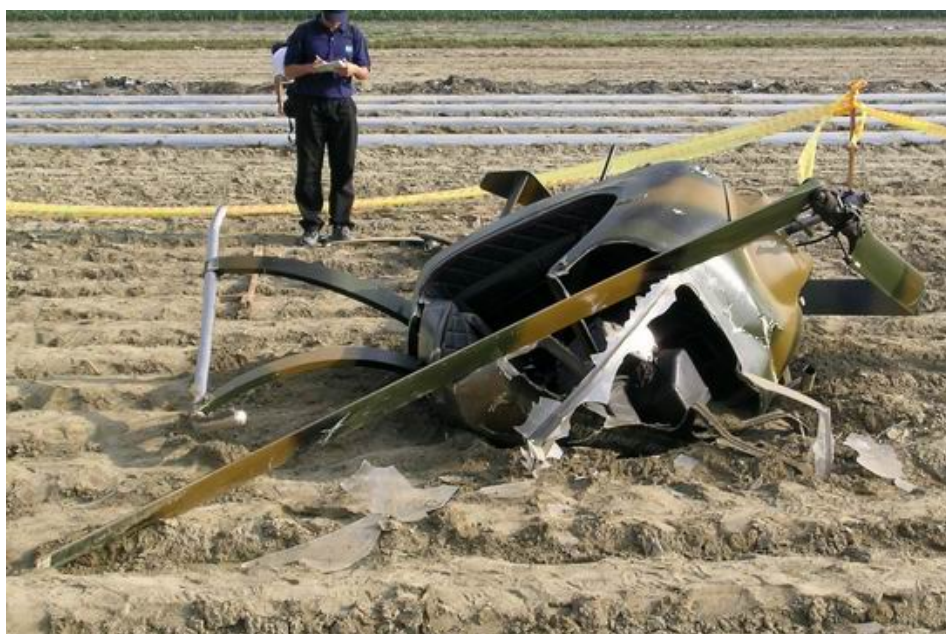
圖 1.3-1 機身損壞情形
