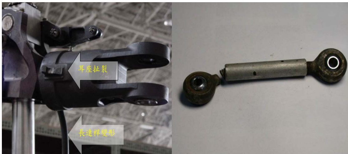
圖 1.3-3 主旋翼根部（左圖）及短連桿（右圖）破壞情形
